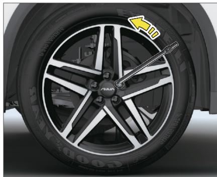
5. Баллонным ключом отверните крепежные болты поврежденного колеса против часовой стрелки на 1–2 оборота;
