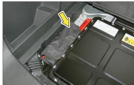
Извлеките набор инструментов и знак аварийной остановки из ниши под полом багажника.
