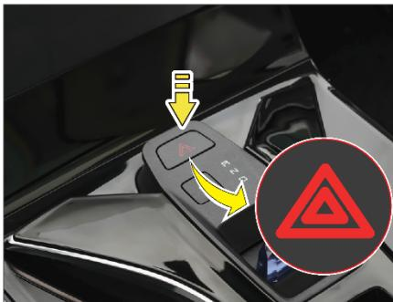
Выключатель аварийной сигнализации расположен на панели в передней части центральной консоли. В случае аварийной ситуации нажмите этот выключатель, чтобы предупредить остальных участников дорожного движения об опасности и избежать столкновения.
