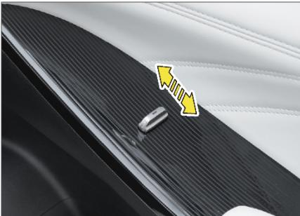
Переключатели на пассажирских дверях управляют работой соответствующих стеклоподъемников.
