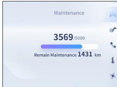
На экране информации о техническом обслуживании отображается пробег автомобиля до следующего технического обслуживания.
