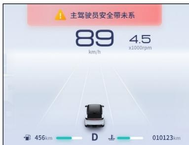
На экране комбинации приборов отображается текстовая информация о состоянии автомобиля, например, «Ремень безопасности водителя не пристегнут», «Низкий уровень топлива. Заправьте автомобиль» или «Активировано автоматическое запирание дверей во время движения\*».
