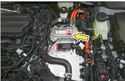
Таблички с предупреждениями закреплены на всех высоковольтных компонентах автомобиля, например, на электродвигателе и тяговой аккумуляторной батарее.
