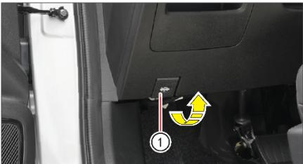
1. Откройте водительскую дверь и найдите ручку открывания капота ① в нижней левой части панели приборов. Дважды потяните ручку вверх, и капот слегка приподнимется;
