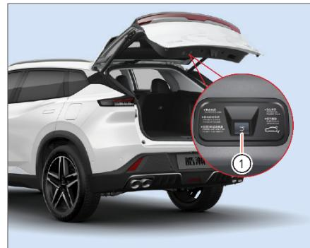
Если при открытой двери багажника нажать кнопку закрывания ①, расположенную с левой стороны двери, и в течение 60 секунд отойти от автомобиля, забрав с собой электронный ключ, будет активирована функция задержки закрывания двери, и дверь багажника автоматически закроется спустя некоторое время.
