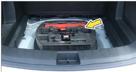
Набор инструмента хранится под полом багажника; для доступа к нему следует поднять панель пола.
