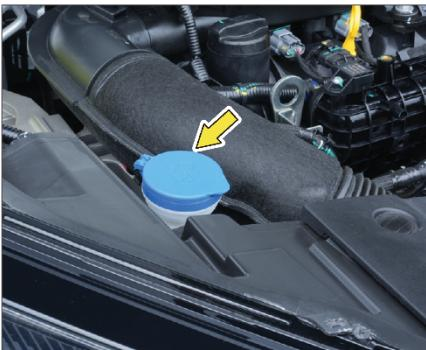
Если при включении стеклоомывателя жидкость подается на ветровое стекло с перебоями или не подается вовсе, это может указывать на израсходование омывающей жидкости. По мере снижения уровня омывающей жидкости в бачке своевременно доливайте свежую жидкость.
