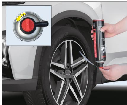
1. Перед использованием тщательно встряхните баллон с шинным герметиком, а затем снимите красный предохранительный колпачок в верхней части баллона с герметиком;
