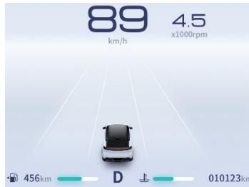
① Запас хода: расчетный пробег автомобиля, на оставшемся в баке топливе.
