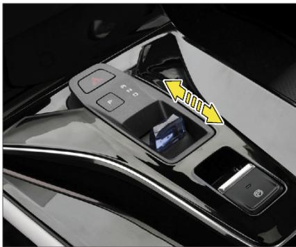
Автомобиль оснащен электронным модулем переключения передач (ESM), который позволяет осуществлять управление переключением передач при условии, когда водитель пристегнут ремнем безопасности и закрыта водительская дверь:
