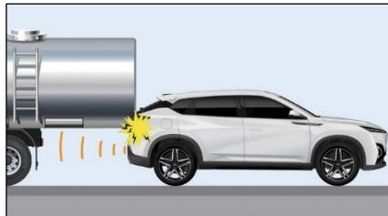
4. Препятствия, расположенные выше зоны обнаружения датчика, например, приподнятые ворота гаража или платформа грузового автомобиля.
