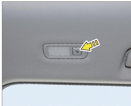
При открывании двери задний плафон автоматически загорается; после закрывания двери или запуска двигателя задний плафон автоматически гаснет. Если после автоматического включения плафона нажать на его выключатель, плафон будет гореть постоянно; чтобы выключить плафон, необходимо снова нажать на выключатель.
