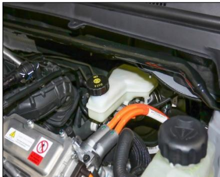
Проверьте уровень тормозной жидкости по меткам на стенке бачка.
