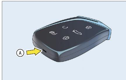
1. Отделите переднюю декоративную крышку ключа, поддев ее через паз **Ⓐ** в нижней части электронного ключа с помощью небольшой шлицевой отвертки, обернутой тканью;
