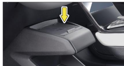
Панель беспроводного зарядного устройства находится в передней части центральной консоли, позади экрана мультимедийной системы; устройство поддерживает быструю беспроводную зарядку мощностью до 50 Вт.
