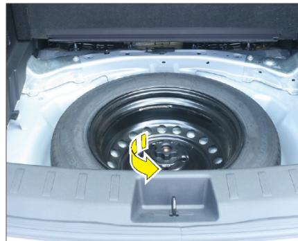
Запасное колесо хранится в нише под полом багажника. Чтобы достать запасное колесо, поднимите панель пола багажника, извлеките поддон из пеноматериала и открутите против часовой стрелки фигурную шпильку по центру запасного колеса.
