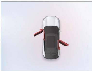
Если какая-либо из дверей автомобиля или капот\* двигателя открыты, на экране комбинации приборов отображается изображение соответствующей двери в открытом состоянии для напоминания водителю о необходимости закрыть дверь.
