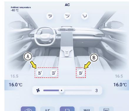
В меню приложений на экране мультимедийной системы выберите «Мои приложения» – «Кондиционер» или нажмите на значок вентиляции в строке меню в нижней части экрана, чтобы войти в интерфейс управления кондиционером. Затем нажмите на значок в области ① интерфейса, чтобы включить вентиляцию и обогрев водительского сиденья; или нажмите на значок в области ②, чтобы включить функцию обогрева переднего пассажирского сиденья.
