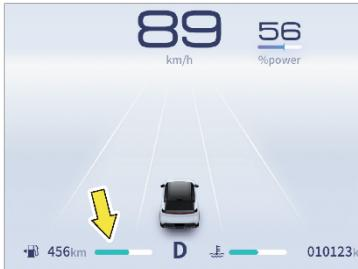
Указатель отображает примерное количество топлива в топливном баке автомобиля. Треугольник слева от изображения топливораздаточной колонки (показан стрелкой)
