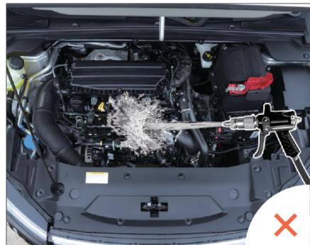
Запрещается мыть моторный отсек водой под давлением, иначе вода может проникнуть в электрические компоненты, жгуты проводов или детали двигателя, что вызовет появление неисправностей. Не допускайте попадания воды или других жидкостей на элементы электрооборудования и дефлекторы системы вентиляции в салоне автомобиля, чтобы избежать их повреждения. Запрещается мыть топливозаправочную горловину водой.
