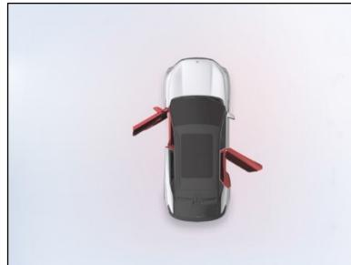
Если какая-либо из дверей автомобиля или капот двигателя открыт, на экране комбинации приборов отображается изображение соответствующей двери в открытом состоянии для напоминания водителю о необходимости закрыть дверь.
