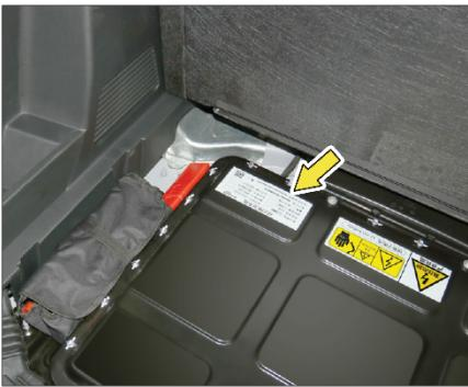
Серийный номер высоковольтной аккумуляторной батареи указан на верхней части корпуса батареи и виден при откинутом напольном покрытии багажника.
