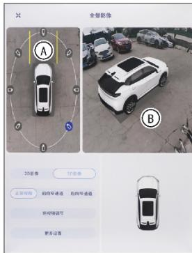
Если в режиме «панорамный вид + 3D-вид» коснуться панорамного изображения Ⓐ, на экране вокруг изображения автомобиля отобразиться белый овал со значками камеры по 8 направлениям. При нажатии значка камеры на экране одиночного вида Ⓑ отобразится вид с соответствующего направления.
