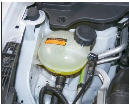
Предупреждающая табличка системы охлаждения расположена на верхней стороне расширительного бачка.
