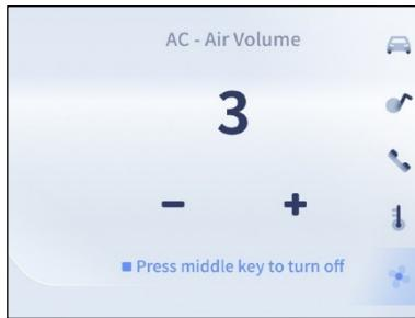
Отображается информация о настройках скорости вентилятора. В этом интерфейсе можно отрегулировать интенсивность обдува и выключить кондиционер с помощью кнопки быстрого доступа на рулевом колесе.
