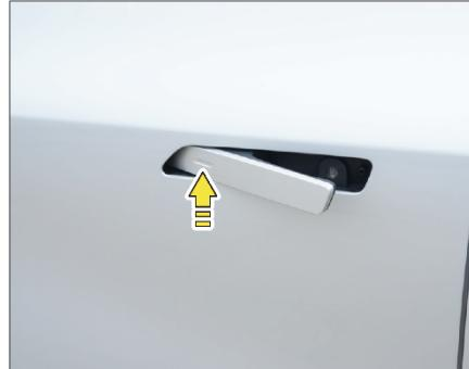
Возмите электронный ключ с собой и убедитесь, что он находится в пределах своего радиуса действия от автомобиля. Если электропитание автомобиля находится в режиме «OFF» и все двери закрыты, коснитесь выемки на дверной ручке, чтобы одновременно запереть все двери, при этом аварийная сигнализация сработает один раз, а скрытые дверные ручки автоматически втянутся внутрь дверей.
