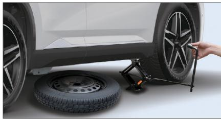
6. Надежно удерживая домкрат, вращайте его винт в направлении подъема, пока поврежденное колесо автомобиля не оторвется от земли;
