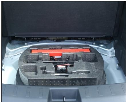
Знак аварийной остановки хранится в багажнике, под полом багажника.
