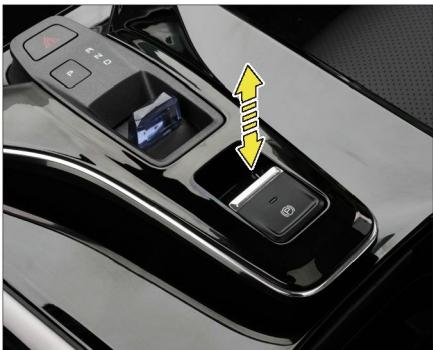
Выключатель электрического стояночного тормоза находится позади рычага селектора.
