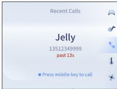
Отображается информация Bluetooth-телефона, включая состояние подключения Bluetooth, все звонки, набранные номера и принятые вызовы.
