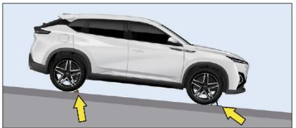
При необходимости замены колеса на спуске подложите упоры или другие подходящие предметы (кирпичи, камни и т. п.) спереди и заднего неповрежденных колес; при необходимости замены колеса на подъеме подложите упоры или другие подходящие предметы (кирпичи, камни и т. п.) позади переднего и заднего неповрежденных колес,
