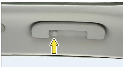
Крючок для одежды находится рядом с верхним поручнем над проемом задней двери и предназначен для легкой верхней одежды и шляп.
