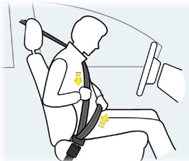
Длину ремня безопасности можно отрегулировать, плавно вытянув ремень из втягивающего механизма, чтобы водитель или пассажиры могли правильно пристегнуться после регулировки положения сиденья.
