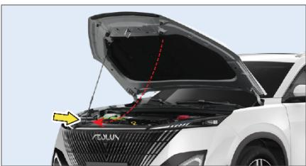
2. Поднимите капот вверх, извлеките упор и вставьте его в отверстие на капоте (при извлечении упора держитесь за резиновую втулку, а не за металлический стержень, который может быть очень горячим сразу после остановки двигателя).
