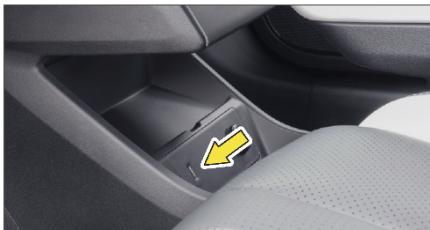
USB-разъем располагается в передней части вещевого отсека под центральной консолью и имеет максимальную выходную мощность 10,8 Вт.
