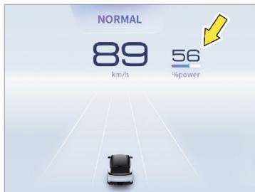
Отображает процентное отношение фактической мощности ДВС и электромотора к мощности, которая может быть выработана в текущий момент.
