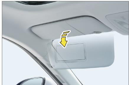
Потяните солнцезащитный козырек вниз, чтобы предотвратить ослепление встречным потоком света. Также козырек помогает снизить утомляемость глаз и улучшает видимость в солнечную погоду.
