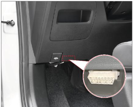
Разъем бортовой системы диагностики (OBD) расположен в нижней части панели приборов с левой стороны и предназначен для обмена данными между электронными блоками управления автомобиля и диагностическим сканером. Подключив сканер к этому разъему можно считывать параметры блоков управления, коды неисправностей, номер VIN и другую информацию.
