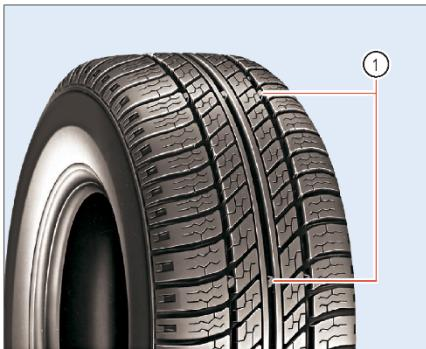
Индикаторы износа протектора ① обозначают предельно допустимую степень износа шины.
