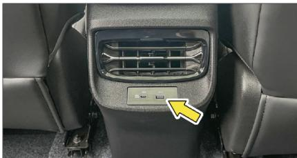
USB-разъем в задней части центральной консоли можно использовать для зарядки мобильных телефонов. Максимальная выходная мощность разъема типа А составляет 18 Вт, а разъема типа С – 60 Вт.
