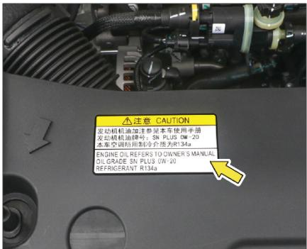
Табличка с инструкциями в отношении моторного масла и хладагента системы кондиционирования воздуха закреплена в передней части моторного отсека с правой стороны.
