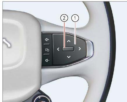
Нажмите на верхнюю или нижнюю часть переключателя ①, чтобы перейти к интерфейсу регулировки температуры или настройки интенсивности обдува. Нажмите на левую или правую сторону переключателя ①, чтобы отрегулировать температуру или интенсивность обдува (если система кондиционирования воздуха отключена, то при нажатии кнопки он автоматически включится). Чтобы отключить систему кондиционирования, нажмите кнопку ②.
