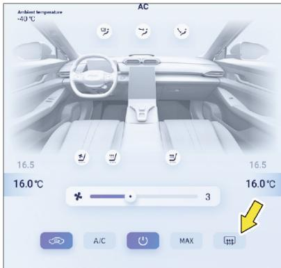
Функцию обогрева наружных зеркал заднего вида следует использовать только при работающем двигателе.
