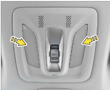
При открывании двери передний плафон автоматически загорается; после закрывания двери или запуска двигателя передний плафон автоматически гаснет. Если после автоматического включения плафона нажать на его рассеиватель, плафон будет гореть постоянно; чтобы выключить плафон, необходимо снова нажать на рессеиватель.
