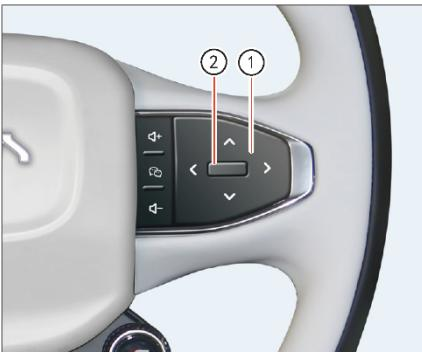
Нажмите на верхнюю или нижнюю часть переключателя ①, чтобы перейти к интерфейсу Bluetooth-телефона. После завершения синхронизации мобильного телефона с мультимедийной системой нажмите на левую или правую сторону переключателя ① для переключения информации о пропущенных звонках, набранных номерах, принятых вызовах и т. д.
