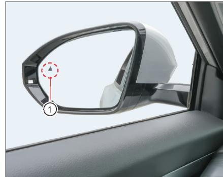
Индикатор ① на наружном зеркале заднего вида или светодиодный индикатор на дисплее электронного зеркала заднего вида загорается в следующих ситуациях:
