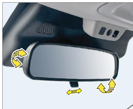
Наклон зеркала можно отрегулировать в соответствии с ростом водителя для улучшения обзора пространства позади автомобиля.
