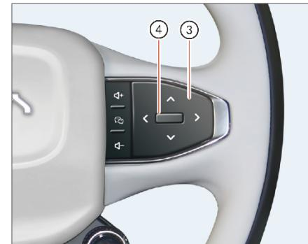
Нажмите на верхнюю или нижнюю часть переключателя ③ и выберите интерфейс отображения путевой информации, войдите в интерфейс маршрутного компьютера и нажмите на левую или правую сторону переключателя ③ для переключения между экранами графика расхода, данных поездки А, данных поездки В, давления воздуха в шинах и остатка пробега до планового ТО.
