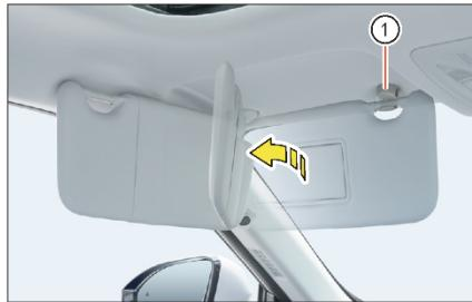
Отделите солнцезащитный козырек от держателя ① и поверните его в сторону, чтобы предотвратить ослепление боковым потоком света.
