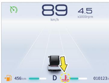
Указатель отображает температуру охлаждающей жидкости двигателя.
