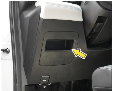
Для доступа к блоку предохранителей снимите крышку в нижней части панели приборов, с левой стороны от рулевого колеса.
