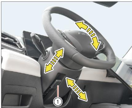
Потяните вниз блокировочный рычаг ①, чтобы разблокировать рулевое колесо, а затем отрегулируйте его положение таким образом, чтобы обеспечивалось удобное и безопасное управление автомобилем. После завершения регулировки верните блокировочный рычаг ① в исходное положение, чтобы заблокировать рулевую колонку. Потяните рулевое колесо вверх-вниз и убедитесь, что рулевая колонка надежно зафиксирована.
