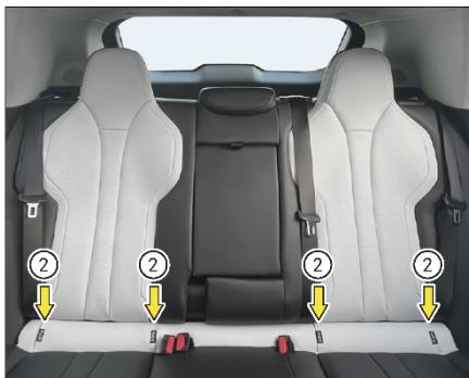
Данный автомобиль оборудован двумя комплектами креплений ISOFIX для детского автокресла, каждый из которых включает в себя одно верхнее крепление ① и два нижних крепления ②.
