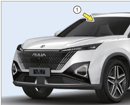
Датчик и видеокамера ①: располагается посередине в верхней части ветрового стекла.
