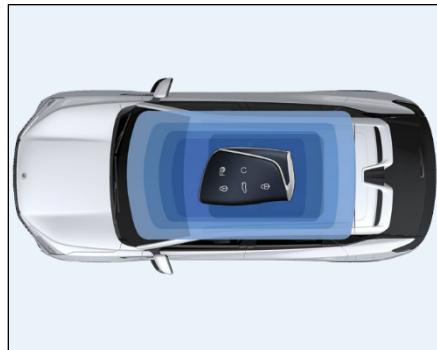
Если электронный ключ находится в салоне автомобиля, нажмите педаль тормоза и убедитесь, что рычаг селектора находится в положении «P» или «N». Нажмите пусковой переключатель для обычного запуска двигателя. При этом загорится индикатор в кнопке пускового переключателя.
