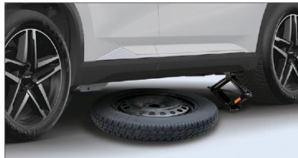
3. Вращая винт домкрата, поднимите домкрат и уприте его головку в подъемную точку на кузове, не поднимая сам автомобиль;
