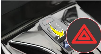
Когда пусковой переключатель переводится в режим «OFF», индикатор, расположенный над выключателем аварийной сигнализации, начинает мигать. Это свидетельствует об исправной работе противоугонной системы автомобиля.
