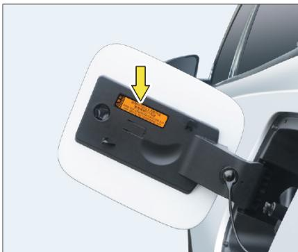
Откройте крышку лючка топливного бака, чтобы увидеть предупреждающую табличку с указанием типа топлива.
