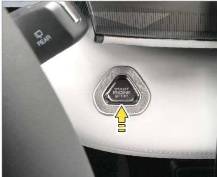
Пусковой переключатель расположен на панели приборов, справа от рулевого колеса.
