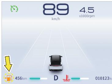
Указатель отображает примерное количество топлива в топливном баке автомобиля. Треугольник слева от изображения топливной колонки (показан стрелкой) означает, что топливозаправочная горловина находится с левой стороны автомобиля.
