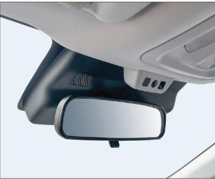
Радиопрозрачная область располагается вокруг внутреннего зеркала заднего вида, где могут быть установлены устройства связи, относящиеся к системам контроля доступа, интеллектуальной парковки или т. д. Для обеспечения эффективной передачи данных запрещается перекрывать эту область солнцезащитной пленкой.
