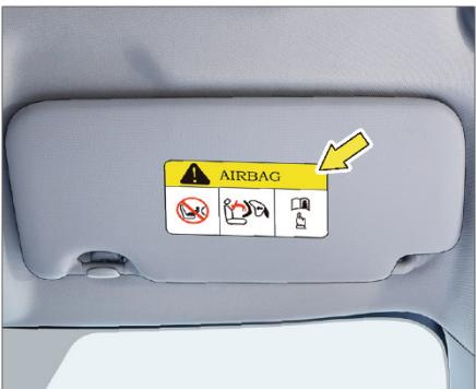
Предупреждающая табличка находится на крышке косметического зеркала в солнцезащитном козырьке, расположенным со стороны переднего пассажира, и видна при откинутом вниз козырьке.
