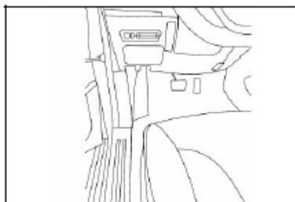
Чтобы получить доступ к блоку предохранителей в кабине, откройте левую нижнюю декоративную панель.
