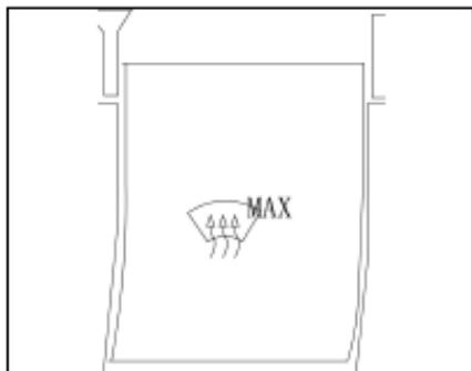
Если система кондиционирования отключена, то при нажатии этой кнопки система включается и переходит в режим обогрева ветрового стекла. При повторном нажатии кнопки система возвращается в рабочее состояние, которого предшествовало отключению системы (кроме режимов обогрева ветрового стекла и максимального охлаждения/обогрева).
