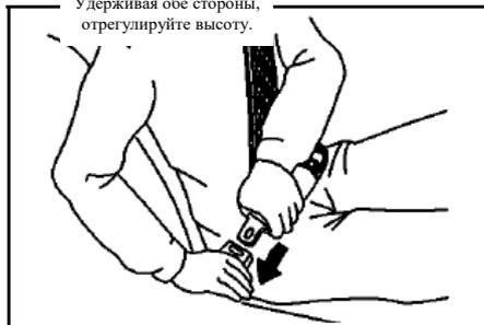
Вытягивающий механизм блокирует перемещение ремня безопасности в случае экстренного торможения или столкновения. Также ремень безопасности может заблокироваться при резком наклоне вперед. Для свободного перемещения на сиденье вытягивайте ремень безопасности медленно и плавно. После вытягивания ремня безопасности на полную длину
