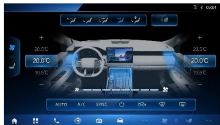
Следующее изображение отображает интерфейс электрического контроллера кондиционера на мультимедийном дисплее.
