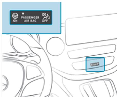
Контрольная лампа PASSENGER AIR BAG ON не работает. При включении зажигания она загорается на короткое время и снова гаснет. Только контрольная лампа PASSENGER AIR BAG OFF отображает состояние подушки безопасности переднего пассажира. Контрольная лампа PASSENGER AIR BAG OFF может постоянно гореть или быть выключенной.
