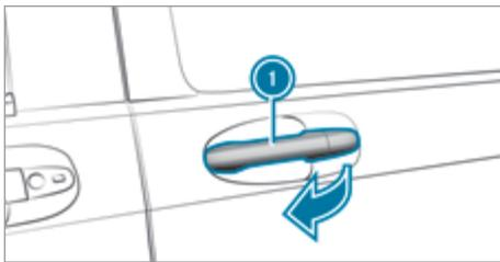
▶ **Открытие:** потяните ручку двери ❶. Производится разблокировка сдвижной двери, автоматический режим включается и сдвижная дверь открывается. Дополнительно включаются два звуковых сигнала.
