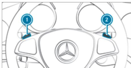
Если автоматическая коробка передач находится в положении **[D]**, то ее можно переключать вручную при помощи подрулевых селекторов АКП. Автоматическая коробка передач в зависимости от потянутого подрулевого селектора АКП переключается на более высокую или более низкую передачу, если это допустимо.
