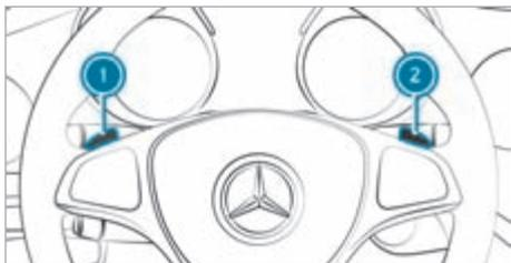
Чем больше мощность рекуперации, тем сильнее затормаживается автомобиль при движении накатом и тем больше электрической энергии поступает в высоковольтную аккумуляторную батарею.
