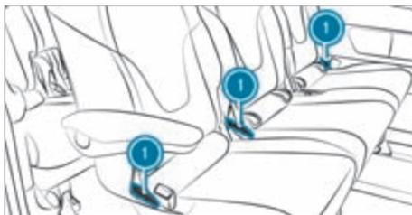
Возможна регулировка только спинок комфортного многоместного заднего сиденья.
