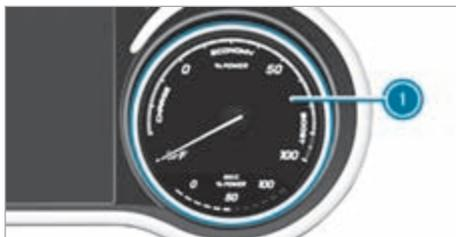
Индикация доступной мощности ① включает в себя два диапазона:
