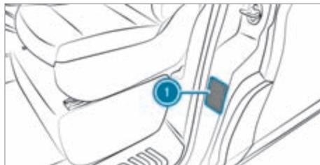
Заводская табличка автомобиля ❶ расположена на средней стойке кузова со стороны водителя.
