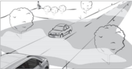
Расширенный противотуманный свет автоматически активируется при движении со скоростью ниже 70 км/ч и включении противотуманного света.
