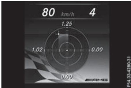
Акселерометр показывает силы, воздействующие на водителя в продольном и поперечном направлении во время движения.
