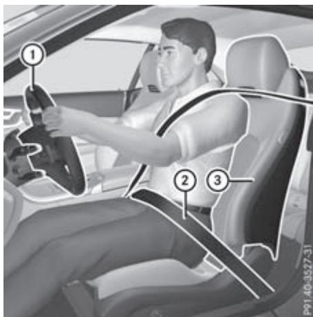
При установке положения рулевого колеса ①, ремня безопасности ② и сиденья водителя ③ учитывайте следующее:
