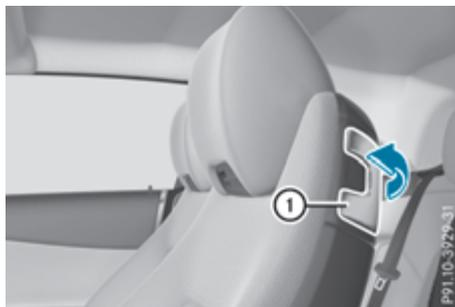
**Функция облегчения посадки EASY-ENTRY:** если Вы откинули вперед спинку сиденья и тянете сиденье горизонтально вперед, сиденье отодвигается вперед. Таким образом задним пассажирам обеспечивается удобная посадка и выход из автомобиля.
