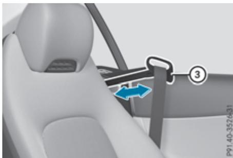
Подающее устройство ремня безопасности водителя и переднего пассажира облегчает пристегивание ремня безопасности. При закрывании соответствующей двери подающее устройство ремня безопасности выдвигается ③.
