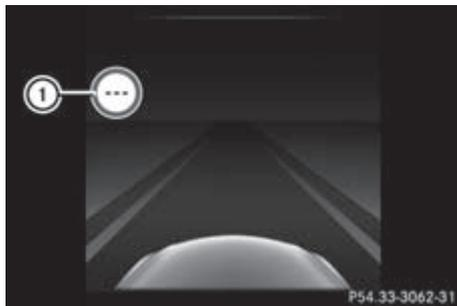
Система распознавания дорожных знаков предлагается только в вариантах исполнения автомобиля для определенных стран. В этом случае в спидометре появляется индикация ①.
