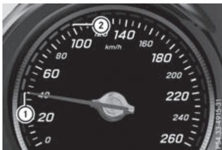
В момент распознавания системой "ДИСТРОНИК ПЛЮС" движущегося впереди автомобиля высвечиваются сегменты между значением скорости движущегося впереди автомобиля ① и значением введенной в память скорости ②.
