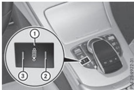
В режиме движения Sport более жесткая установка ходовой части обеспечивает еще лучший контакт с дорогой. Выберите этот режим при динамичном стиле вождения, например на извилистых шоссе-ных дорогах.
