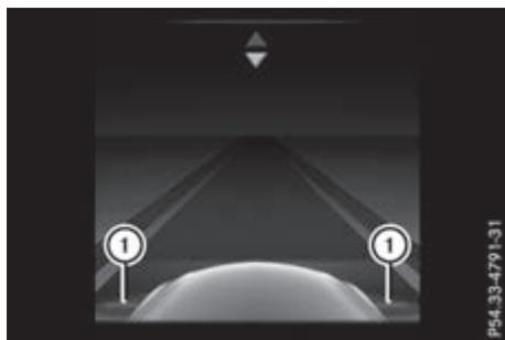
Если сигнализация перестроения включена, то на графике сближения на мультимедийном дисплее (> стр. 236) рядом с автомобилем появляются серые радарные волны, расширяющиеся назад. При скорости выше 30 км/ч радарные волны на графике сближения окрашиваются в зеленый цвет ①. В таком случае сигнализация перестроения готова к эксплуатации.
