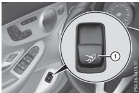
На стоящем автомобиле после разблокировки Вы можете открыть крышку багажника с сиденья водителя.
