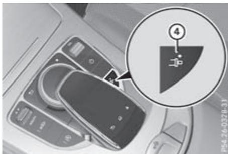
Подающее устройство ремня безопасности ③ Вы можете также выдвинуть при помощи переключателя подающего устройства ремня безопасности ④.
