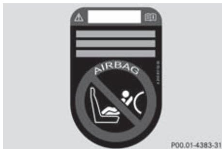
Если Ваш автомобиль не оснащен системой автоматического отключения подушки безопасности переднего пассажира, то Вы распознаете это по специальной наклейке. Наклейка находится на створке переднего пассажира сбоку на панели приборов. Наклейка видна при открывании двери переднего пассажира.
