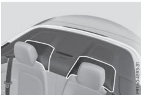
Дуги безопасности расположены под защитными крышками за задними подголовниками. Они срабатывают автоматически, если распознается опасность опрокидывания автомобиля.
