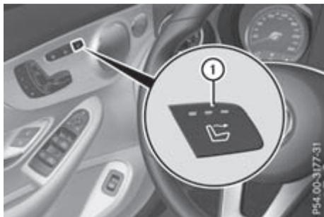
Функция системы AIRSCARF обеспечивает подачу теплого воздуха в зону головы и затылка сидящих в автомобиле. Теплый воздух выходит из отверстий на подголовниках.
