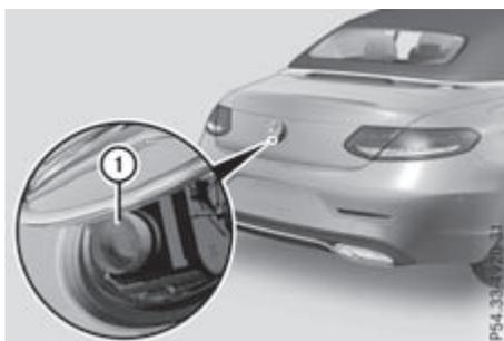
Видеокамера заднего хода ① – это визуальное устройство облегчения паркования и маневрирования. Она отображает на дисплее мультимедийной системы зону позади автомобиля с помощью вспомогательных линий.
