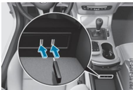
Два гнезда для подключения прибора USB находятся в вещевом отсеке под подлокотником.
