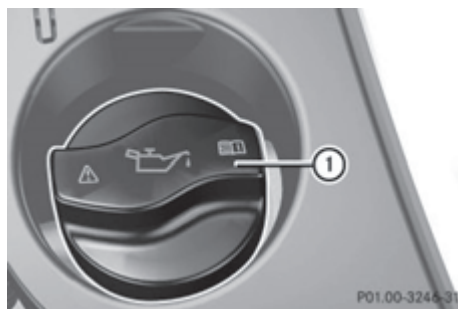
Пробка наливной горловины моторного масла (пример)
