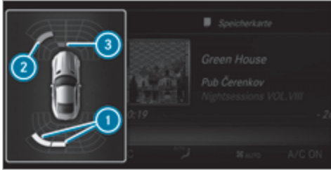
Предупредительная индикация рулевого ассистента PARKTRONIC (автомобили без камеры переднего и заднего вида)
