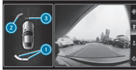
Предупредительная индикация рулевого ассистента PARKTRONIC (автомобили с камерой переднего и заднего вида)
