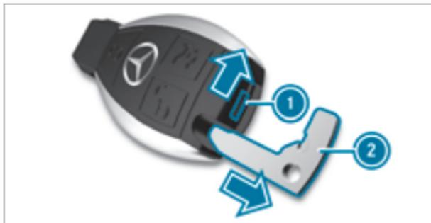
▶ **Вынимание:** передвиньте разблокировочный ползунок ① в направлении стрелки и одновременно
