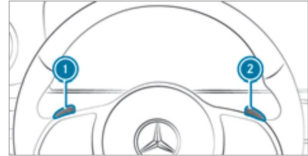
▶ **Переключение на более высокую передачу:** потяните подрулевой селектор АКП ②.
