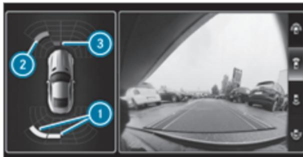
Индикация рулевого ассистента PARKTRONIC (автомобили с камерой переднего и заднего вида)
