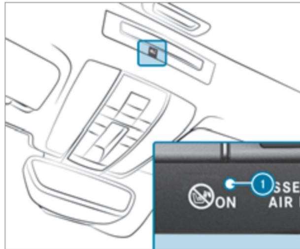
При включенной противоугонной сигнализационной системе мигает контрольная лампа ①.
