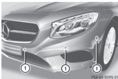
① Датчики в переднем бампере, слева (пример)
