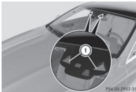
Функция ROAD SURFACE SCAN контролирует зону перед Вашим автомобилем при помощи мультимедийной видеокамеры ①, установленной в верхней части ветрового стекла. Данная функция автоматически активируется, если Вы выбираете комфортную установку
