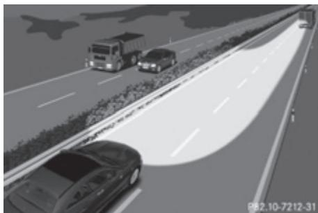
**Активирована:** при движении со скоростью выше 110 км/ч без значительных поворотов рулевого колеса на протяжении не менее 1000 м или при движении со скоростью выше 130 км/ч.
