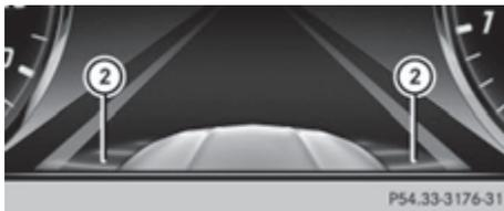
Если активная сигнализация перестроения включена, то на графике сближения на мультимедийном дисплее рядом с автомобилем появляются серые радарные волны, расширяющиеся назад. При скорости выше 30 км/ч радарные волны на графике сближения окрашиваются
