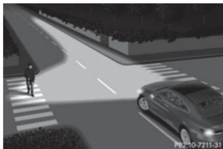
Дополнительная подсветка поворотов расширяет угол высвечивания дорожного полотна в направлении поворота, улучшая таким образом обзор крутых поворотов. Ее активирование возможно только в случае включения ближнего света.
