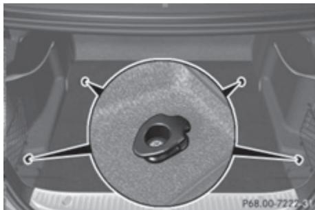
В багажнике имеются четыре крючка для багажной сетки.
