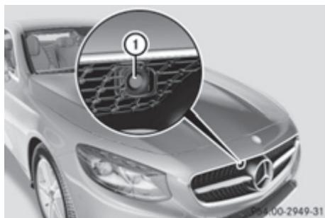
Линза видеокамеры ① регулярно очищается через установленные интервалы при задействовании стеклоомывателя.
