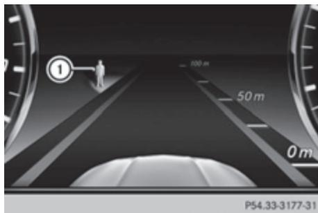
Состояние функции прожектора индицируется символом человека ① на графике сближения. Если символ изображается в незаполненном виде, то функция включена. Если символ изображается в заполненном виде, то все условия для задействования функции прожектора выполнены.
