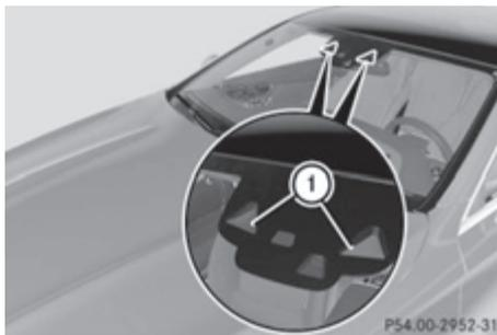
Система "ДИСТРОНИК ПЛЮС" с ассистентом рулевого управления и системой Stop&Go Pilot помогает водителю удерживать курс автомобиля посередине полосы движения посредством умеренного вмешательства в процесс управления в диапазоне скоростей 0–200 км/ч.
