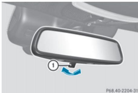
► **Затемнение зеркала:** передвиньте рычаг для затемнения зеркала ① вперед или назад.
