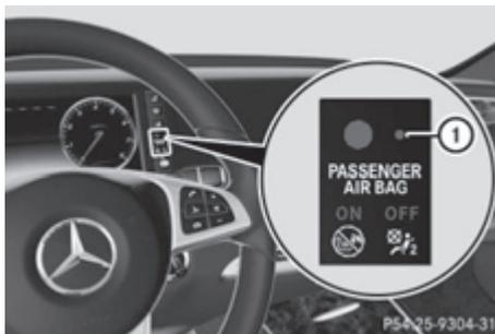
► **Включение:** заблокируйте автомобиль при помощи ключа или системы KEYLESS-GO. Контрольная лампа ① мигает. Противоугонная сигнализационная система активируется примерно через 15 секунд.
