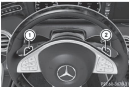
В автоматических программах движения "E" (в автомобилях AMG в программе движения "C") и "S" при помощи подрулевых переключателей передач ① и ② можно активировать ручную программу движения "M" (▷ стр. 181). В ручной программе движения "M" можно кратковременно вручную переключать передачи при помощи подрулевых переключателей передач.
