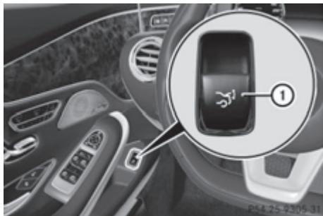
После остановки и разблокировки автомобиля открытие и закрытие крышки багажника можно произвести с места водителя.
