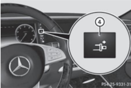
Выдвижение подающего устройства ремня безопасности **3** возможно также при помощи переключателя подачи ремня **4**.
