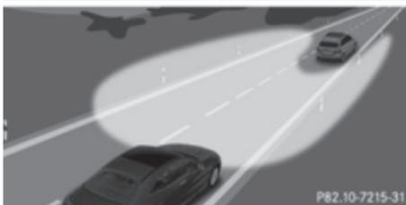
При помощи системы адаптации фар дальнего света с расширенными функциями возможно автоматическое переключение между ближним светом, приглушенным дальним светом и дальним светом.
