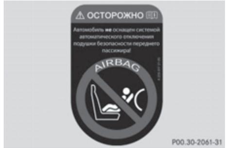
Если Ваш автомобиль не оснащен системой автоматического отключения подушки безопасности переднего пассажира, то Вы распознаете это по специальной наклейке. Наклейка находится на стороне переднего пассажира сбоку на панели приборов. Наклейка видна при открывании двери переднего пассажира.
