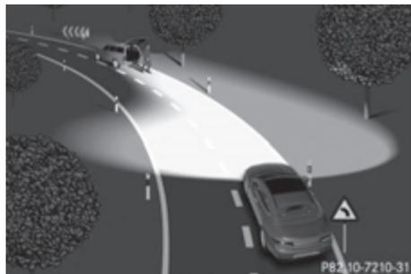
Адаптивная система освещения поворотов является системой, при которой фары следуют движениям рулевого колеса. Благодаря этому лучше высвечиваются зоны поворота во время движения. Вы можете заранее распознать пешеходов, велосипедистов и животных.
