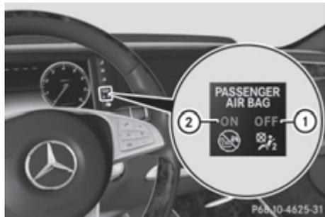
Контрольные лампы PASSENGER AIR BAG OFF ① и PASSENGER AIR BAG ON ② являются частью системы автоматического отключения подушки безопасности переднего пассажира.
