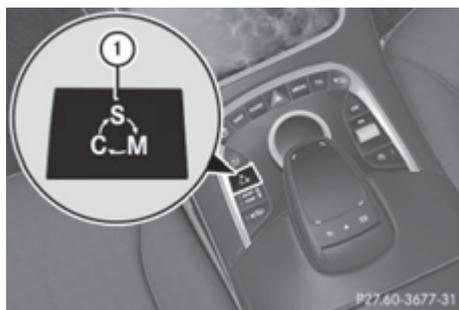
► **Автомобили AMG:** нажимайте на программный переключатель ① до тех пор, пока на мультифункциональном дисплее не появится буква требуемой программы движения.
