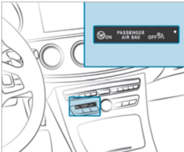
При включенном зажигании обе контрольные лампы PASSENGER AIR BAG ON и OFF одновременно горят во время самодиагностирования системы.
