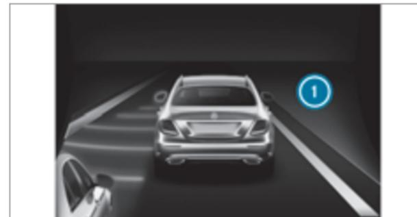
Во время торможения, корректирующего курс движения автомобиля, мигает красная предупредительная сигнальная лампа в наружном зеркале заднего вида и раздается предупредительный звуковой сигнал. Дополнительно на мультимедийном дисплее появляется индикация ①, обращающая внимание водителя на опасность бокового столкновения.
