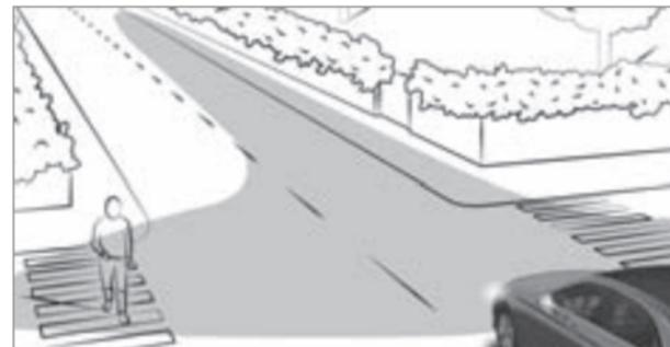
Дополнительная подсветка поворотов расширяет угол высвечивания дорожного полотна в направлении поворота, таким образом улучшая обзор, например, крутых поворотов. Ее активирование возможно только при включенном ближнем свете.
