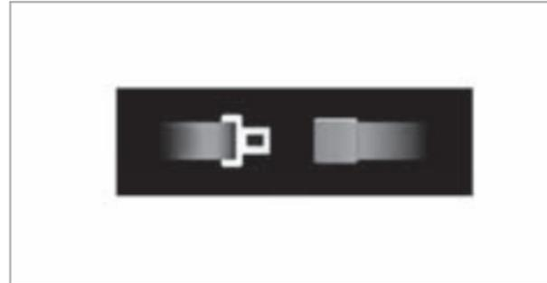
Индикация состояния ремней безопасности в задней части салона показывает, какой ремень безопасности в задней части салона не пристегнут.
