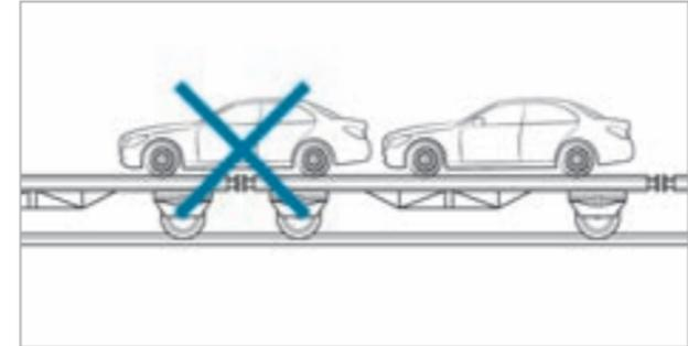
▶ Следите за тем, чтобы передний и задний мосты находились на одной платформе эвакуатора.
