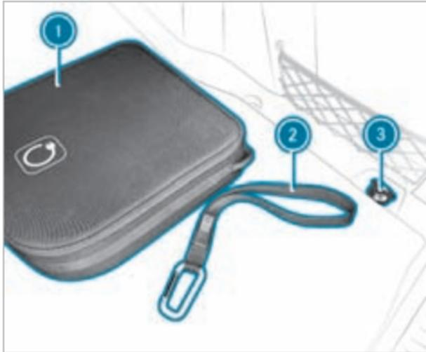
Чехол с зарядным кабелем в багажнике или в грузовом отделении (пример)
