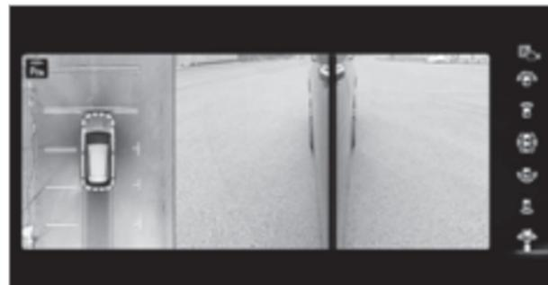
Если устанавливается электрическое соединение автомобиля с прицепом, то индикация переключается на изображение боковых видеокамер.
