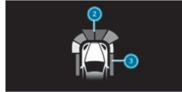
Распознанные системой помощи при парковке PARKTRONIC препятствия могут опционально отображаться также на проекционном дисплее начиная с расстояния примерно 1,0 м спереди ② и 0,6 м по бокам ③.
