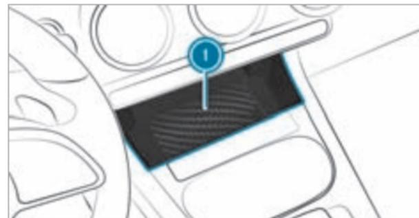
▶ По возможности положите мобильный телефон по центру подкладки на обозначенную поверхность ① дисплеем вверх. Если в мультимедийной системе индицируется указание, то мобильный телефон заряжается.
