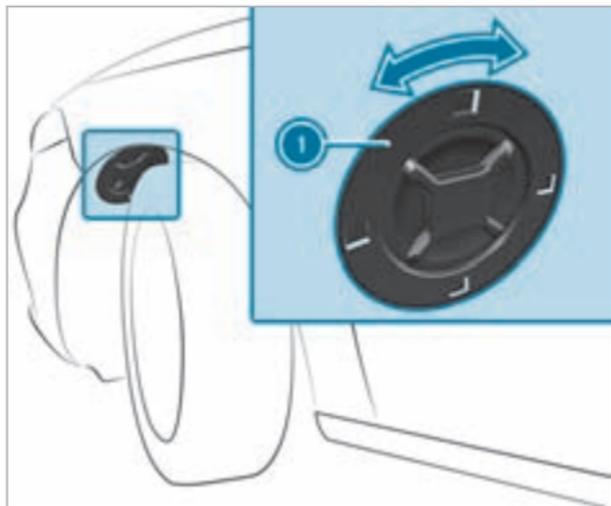
▶ **Снятие:** поверните крышку ① влево и снимите ее с облицовки колесной арки.
