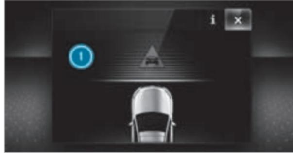
Если происходит автономное торможение или срабатывает адаптивная система помощи при торможении, то отображается сообщение
