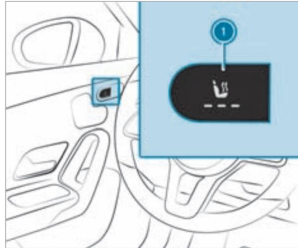
▶ Нажимайте на кнопку ① до тех пор, пока не будет достигнут нужный уровень обогрева. В зависимости от уровня обогрева горит от одной до трех контрольных ламп. Если все контрольные лампы выключены, то подогрев сидений выключен.
