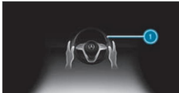
Если система распознает, что водитель долго не осуществляет управление автомобилем самостоятельно или снимает руки с рулевого колеса, то появляется индикация **i**. Если водитель и далее не начинает активно управлять автомобилем или не реагирует на срабатывание системы, то дополнительно к визуальному сигналу многократно звучит предупредительный звуковой сигнал.
