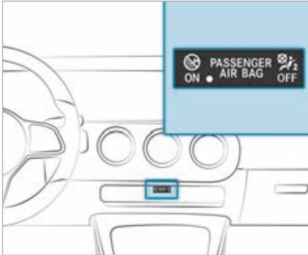
Автомобили без системы автоматического отключения подушки безопасности переднего пассажира снабжены специальной наклейкой на стороне
