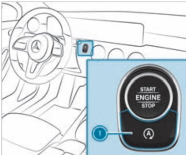
▶ Нажмите на кнопку ①. При выключении или включении функции ECO Start-Stop на комбинации приборов появляется индикация.
