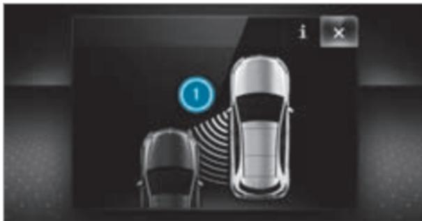
Во время торможения, корректирующего курс движения автомобиля, мигает красная сигнальная лампа в наружном зеркале заднего вида и раздается предупредительный звуковой сигнал. Дополнительно на дисплее приборов появляется индикация **i**, обращающая внимание водителя на опасность бокового столкновения.
