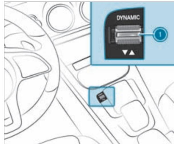
▶ Нажмите переключатель DYNAMIC SELECT **i** вперед или назад. На дисплее приборов отобразится выбранный режим движения.
