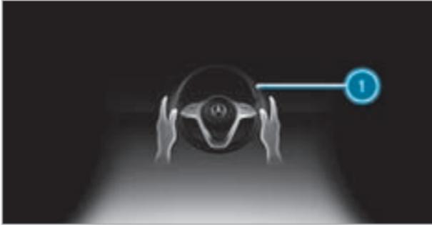
Если система распознает, что водитель относительно долго не осуществляет управление самостоятельно или снимает руки с рулевого колеса, то появляется индикация ① на дисплее приборов. Если водитель и далее не начинает активно управлять автомобилем или не реагирует на срабатывание системы, то дополнительно к оптическому сигналу многократно звучит предупредительный звуковой сигнал.
