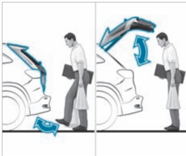
Функция HANDS-FREE ACCESS позволяет открывать и закрывать дверь багажного отделения или останавливать ее путем движения ногой под задним бампером.
