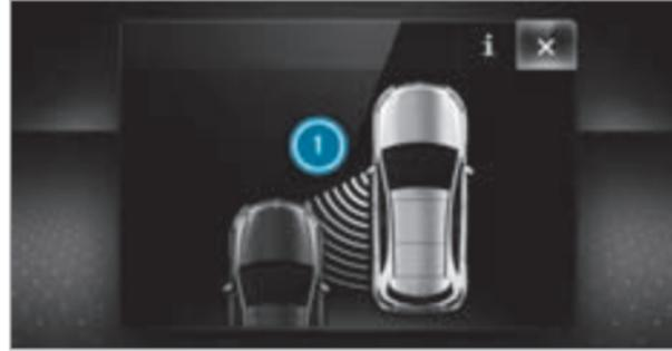
Во время торможения, корректирующего курс движения автомобиля, мигает красная предупредительная сигнальная лампа в наружном зеркале заднего вида и раздается предупредительный звуковой сигнал. Дополнительно на дисплее приборов появляется индикация ❶, обращающая внимание водителя на опасность бокового столкновения.
