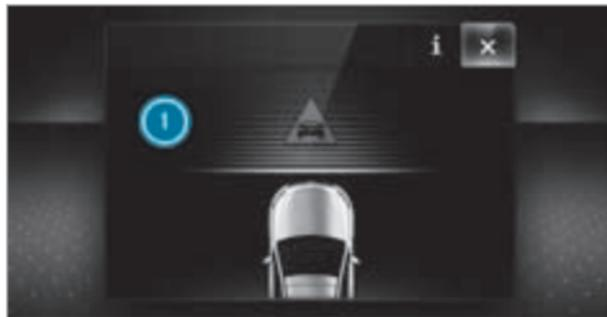
Если происходит автономное торможение или задействуется адаптивная система помощи при торможении, то индицируется сообщение
