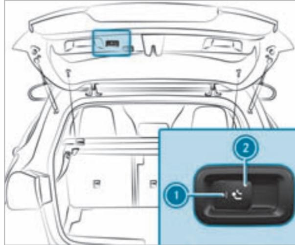
▶ Потяните кнопку ②, чтобы разблокировать ножку сцепного шара. Ножка сцепного шара будет выдвинута под задним бампером. Контрольная лампа ① начнет мигать.
