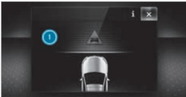
Если происходит автономное торможение или задействуется адаптивная система помощи при торможении, то индицируется сообщение ① на дисплее приборов, и самостоятельно гаснет после непродолжительного времени.
