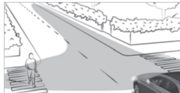
При освещении выполняемого поворота расширяется угол высвечивания дорожного полотна в направлении поворота так, что улучшается обзор, например при поворотах малого радиуса. Активация освещения выполняемого поворота происходит только в том случае, если включен ближний свет фар.
