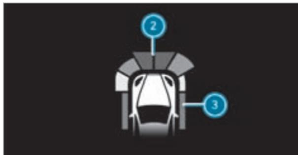
Распознанные системой помощи при парковке PARKTRONIC препятствия могут опционально отображаться также на проекционном дисплее начиная с расстояния примерно 1,0 м спереди ❷ и 0,6 м по бокам ❸.
