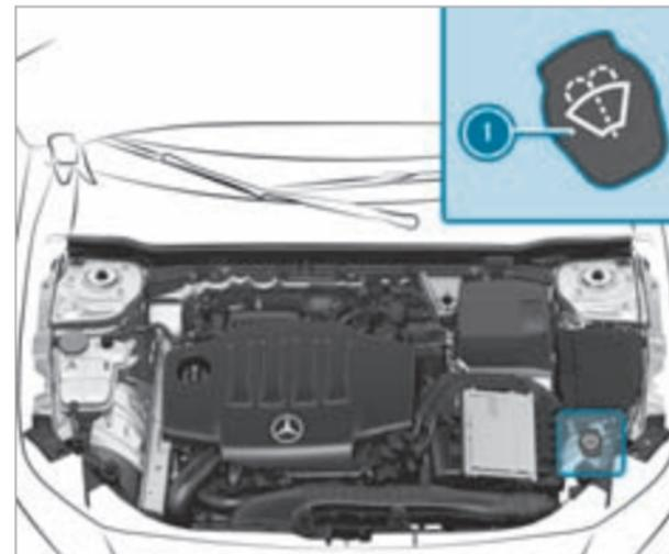
▶ Снимите запорную крышку ①, потянув за язычок.
