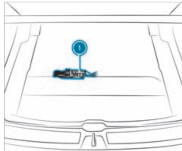
Блок предохранителей ① находится под полом багажного отделения.
