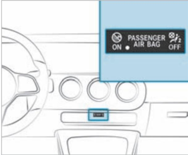
Автомобили без системы автоматического отключения подушки безопасности переднего пассажира снабжены специальной наклейкой на стороне переднего пассажира сбоку на панели приборов (→ стр. 78).
