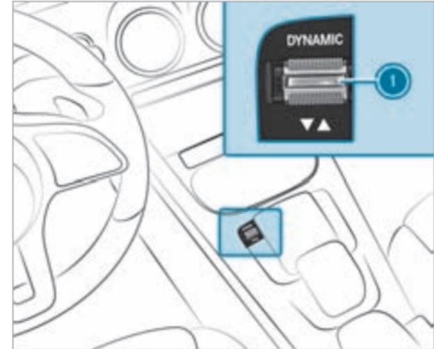
▶ Нажмите переключатель DYNAMIC SELECT **1** вперед или назад. На дисплее приборов отобразится выбранный режим движения.
