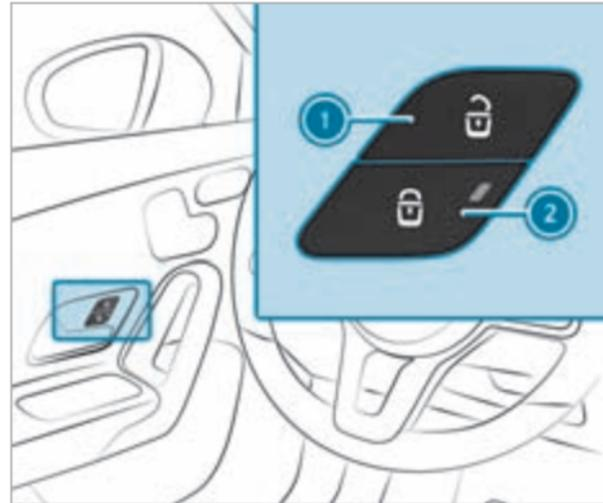
▶ **Включение:** нажмите на кнопку ② и держите ее нажатой примерно пять секунд, пока не раздастся звуковой сигнал.
