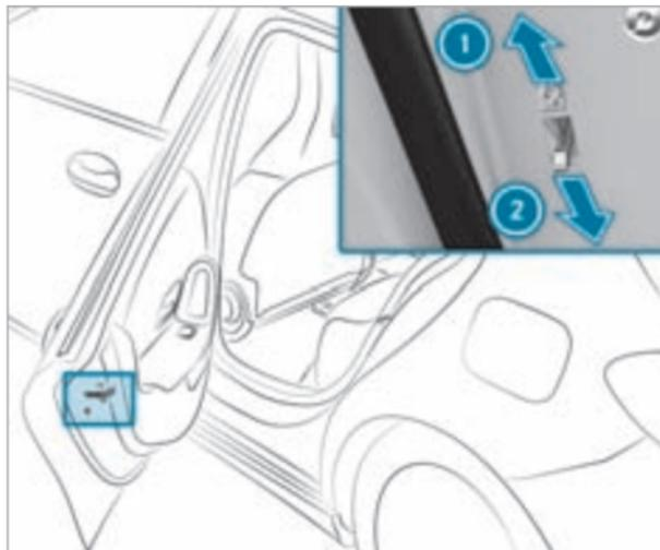
▶ Нажмите рычаг в направлении стрелки ① (блокировка) или ② (разблокировка).
