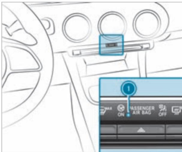
При включенной противоугонной сигнализационной системе мигает контрольная лампа
