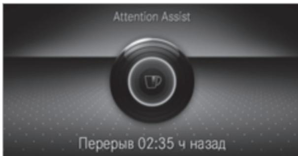
В меню "Вспомогательные системы" бортового компьютера можно вызвать индикацию следующей информации о состоянии системы ATTENTION ASSIST:
