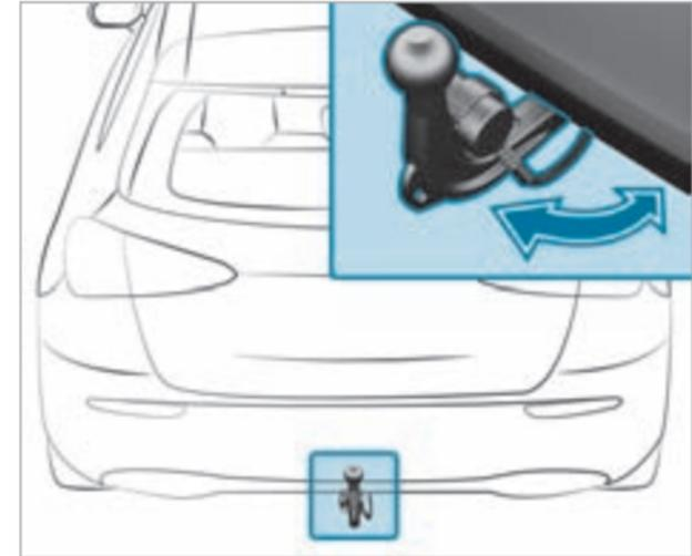
▶ Потяните ножку сцепного шара в направлении стрелки, чтобы она с характерным щелчком зафиксировалась в вертикальном положении. Контрольная лампа ① в кнопке разблокировки ножки сцепного шара погаснет.
