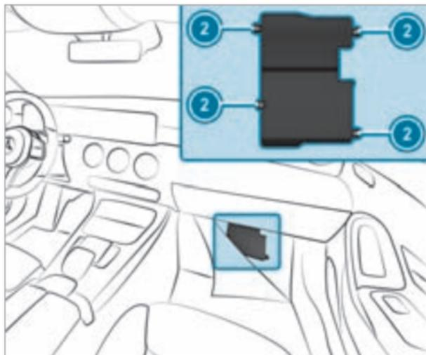
▶ Отвинтите винты ② и снимите крышку блока предохранителей вверх.
