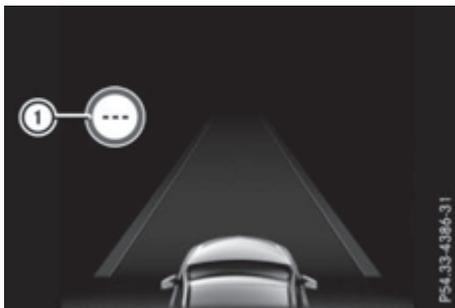
Система распознавания дорожных знаков предлагается только в вариантах исполнения автомобиля для определенных стран. В этом случае на мультимедийном дисплее отображается индикация ①.
