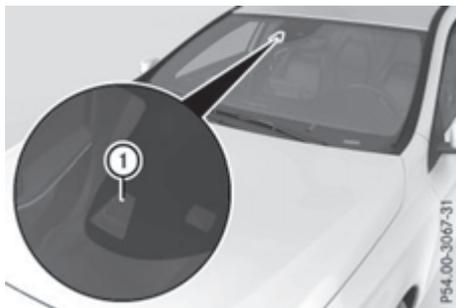
Система удержания полосы движения контролирует зону перед Вашим автомобилем при помощи мультимедийной видеокамеры **1**, установленной вверху за ветровым стеклом. Если система удержания полосы движения распознает на дороге ограничительные линии разметки дорожного полотна, то она может предупредить водителя при непреднамеренном отклонении от полосы движения.
