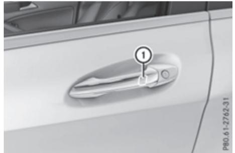
▶ Прикоснитесь к вогнутой поверхности датчика **1** на ручке двери и не отпускайте руку до тех пор, пока полностью не закроются боковые стекла и панорамная сдвижная панель крыши.
