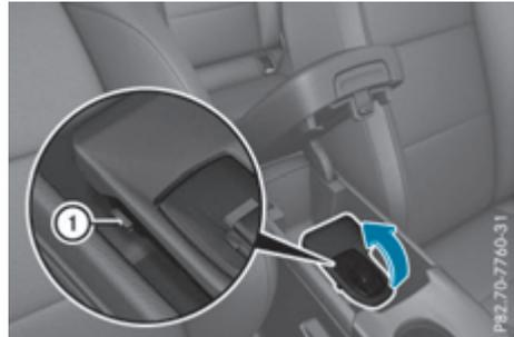
Предварительно смонтированный держатель можно откинуть вверх, чтобы облегчить доступ к вещевому отсеку.
