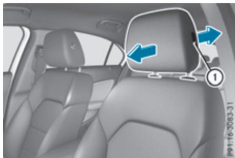
При помощи этой функции устанавливается расстояние между подголовником и затылком.
