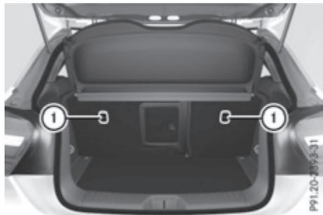
Дополнительные крепления Top Tether смонтированы на задней стороне спинок обоих крайних задних сидений.
