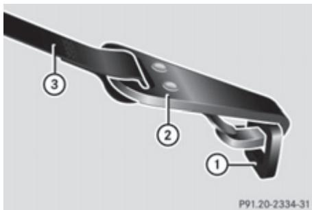
дайте указания в руководстве изготовителя по монтажу. Следите за плотным прилеганием ремня Top Tether ③.
