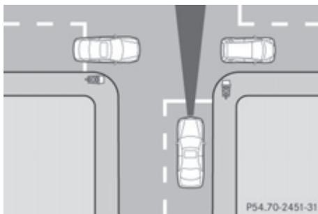
Система "ДИСТРОНИК ПЛЮС" может ошибочно среагировать на автомобили, движущиеся в поперечном направлении. Если Вы, например, включите систему "ДИСТРОНИК ПЛЮС" на перекрестке у светофора, автомобиль может неожиданно тронуться с места.
