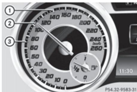
Индикация системы "ДИСТРОНИК ПЛЮС" на спидометре (пример)
