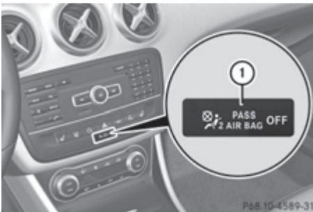
① контрольной лампой PASSENGER AIRBAG OFF,
