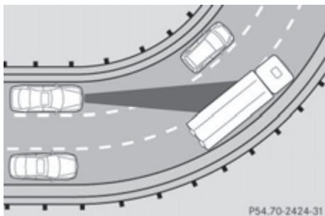
Возможности распознавания системой "ДИСТРОНИК ПЛЮС" автомобилей в зоне поворота ограничены. Торможение автомобиля может произойти неожиданно или с опозданием.
