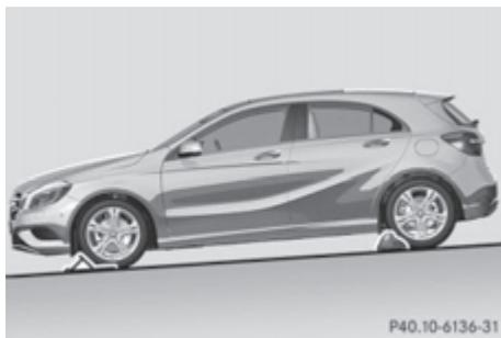
Предохранение автомобиля от откатывания на небольших уклонах
