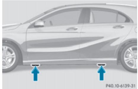
Приемные точки для установки автомобильного домкрата расположены позади колесных арок передних колес и перед колесными арками задних колес (стрелки).
