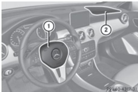
Подушка безопасности водителя **1** раскрывается перед рулевым колесом, а передняя подушка безопасности переднего пассажира **2** – перед и над вещевым ящиком.
