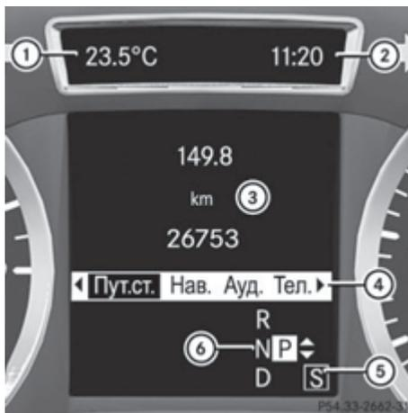
Черно-белый мультифункциональный дисплей (пример: автомобиля с автоматической коробкой передач)
