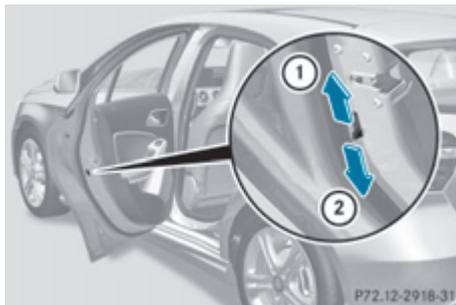
При помощи устройства обеспечения пассивной безопасности детей в задних дверях можно отдельно заблокировать каждую дверь. Заблокированную дверь невозможно открыть изнутри. После разблокировки автомобиля дверь можно открыть снаружи.
