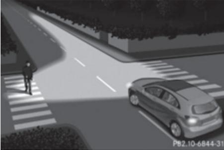
Дополнительная подсветка поворотов расширяет угол высвечивания дорожного полотна в направлении поворота, улучшая таким образом обзор крутых поворотов. Активирование дополнительной подсветки поворотов возможно только при включенном ближнем свете.
