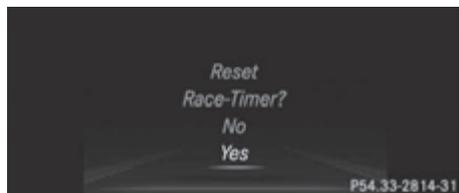
После выключения двигателя через 30 секунд производится сброс показаний ГОНОЧНОГО ТАЙМЕРА на 0. Производится сброс времени прохождения всех кругов.
