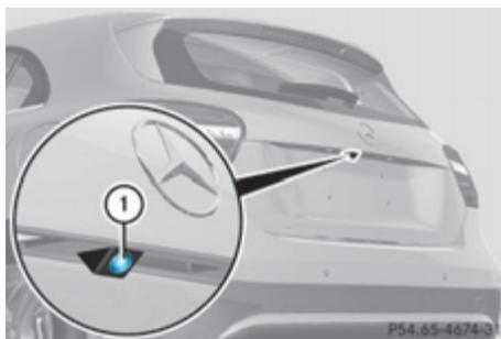
► Производите очистку линзы видеокамеры ① с помощью чистой воды и мягкой ткани.
