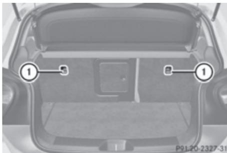
Дополнительные крепления Top Tether ① смонтированы на задней стороне спинок задних сидений.
