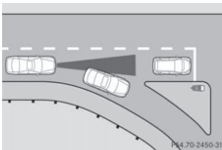
Система "ДИСТРОНИК ПЛЮС" не реагирует торможением на неподвижные препятствия или стоящие автомобили. Если, например, распознанный движущийся впереди автомобиль производит поворот, а перед ним находится препятствие или стоящий автомобиль, то система "ДИСТРОНИК ПЛЮС" не производит торможение.
