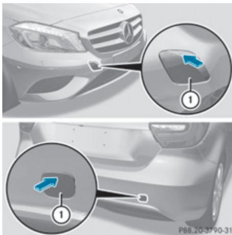
Защитные крышки приемного гнезда буксирной проушины (пример)
