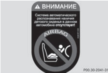
Если Ваш автомобиль не оснащен системой автоматического распознавания наличия детского сиденья на сиденье переднего пассажира, то Вы распознаете это по специальной наклейке. Наклейка находится на стороне переднего пассажира сбоку на панели приборов. Наклейка видна при открывании двери переднего пассажира.
