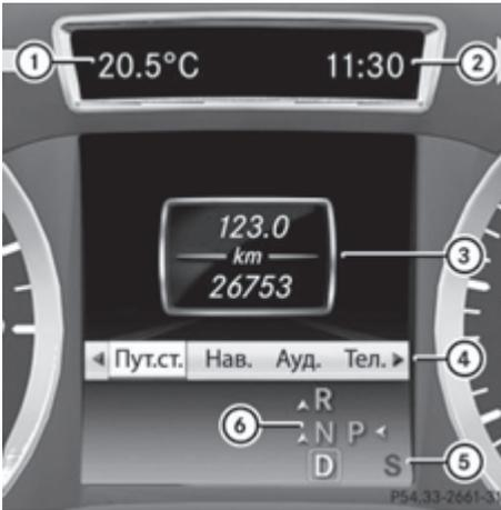
Цветной мультифункциональный дисплей (пример: автомобиля с автоматической коробкой передач)
