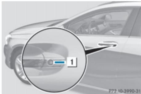
► Поверните аварийный ключ по часовой стрелке до упора в положение ①.
