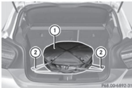
Автомобили с временным аварийным колесом Minispare (пример)
