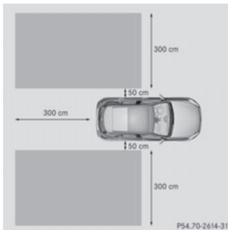
Сигнализация перестроения контролирует изобразенную на иллюстрации зону до 3,0 м позади Вашего автомобиля и непосредственно рядом с ним. Сигнализация перестроения использует для этого радарные датчики в заднем бампере. На узких полосах движения, в особенности при движении со значительным боковым смещением, могут быть индицированы автомобили, находящиеся через одну полосу движения. Это имеет место при движении автомобилей по внутреннему краю своей полосы движения.
