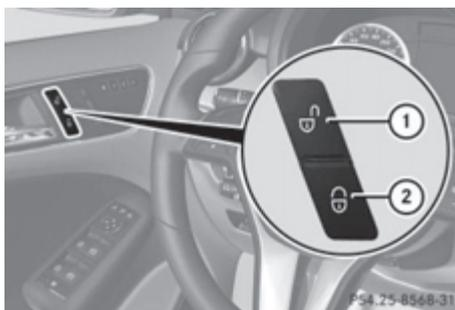
► **Выключение:** нажмите на кнопку ① и держите ее нажатой примерно пять секунд до тех пор, пока не раздастся звуковой сигнал.
