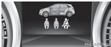
Индикация состояния ремней безопасности в задней части автомобиля (пример)
