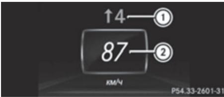
Цифровой спидометр (пример: цветной мультифункциональный дисплей)
