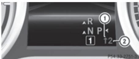
▶ При появлении на мультифункциональном дисплее комбинации приборов соответствующей рекомендации по переключению передачи ① переключите коробку передач на рекомендуемую передачу ②.
