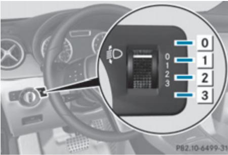
Регулятор угла наклона фар
