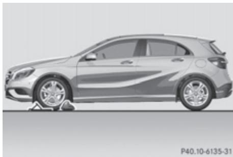
Предохранение автомобиля от откатывания на ровном грунте
