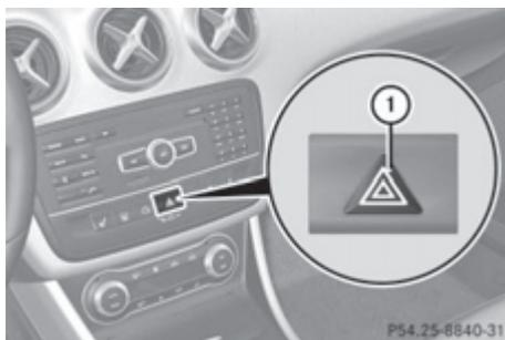
Аварийная световая сигнализация автоматически включается при:
