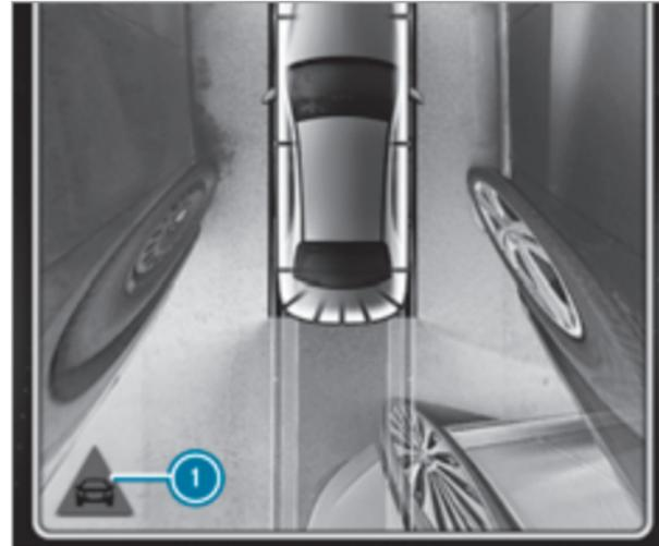
**Автомобили с сигнализацией перестроения:** при выезде с места парковки задним ходом дополнительно может быть выдано предупреждение о транс-
