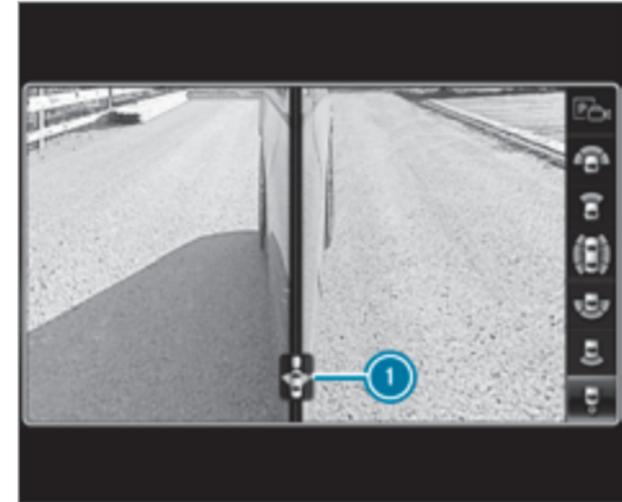
Если устанавливается электрическое соединение автомобиля с прицепом, то индикация переключается на изображение боковых видеокамер.
