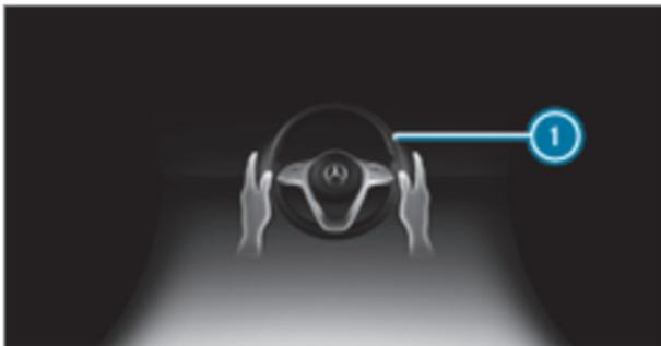
Если система достигает системного предела, если водитель относительно долго не осуществляет управление самостоятельно или снимает руки с рулевого колеса, то в зависимости от ситуации она предупреждает его при помощи оптического сигнала или при помощи оптического и звукового сигнала. На мультифункциональном дисплее появляется индикация ①.
