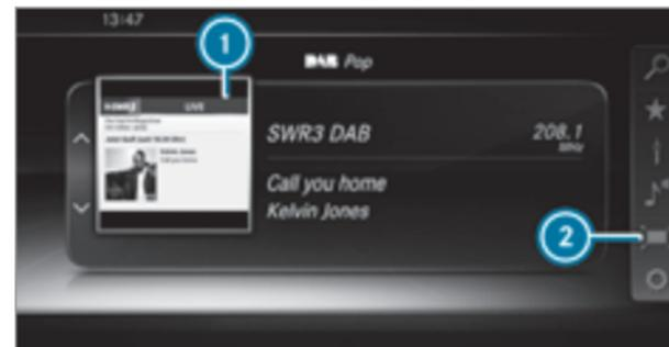
Слайд-шоу ① отображает графически обработанную дополнительную информацию радиостанции. Она может содержать, например, логотипы, изображение альбома, название музыкального произведения, программу, новости или сервисную информацию. При нажатии на ② дополнительная информация отображается в полноэкранном режиме.
