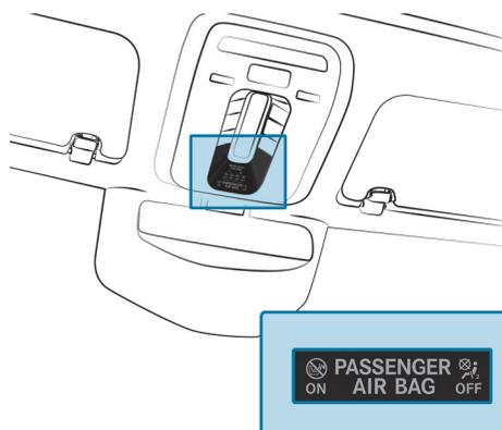
Автомобили без автоматического отключения подушки безопасности переднего пассажира имеют специальную наклейку на торце передней панели со стороны пассажира (→ стр. 159).
