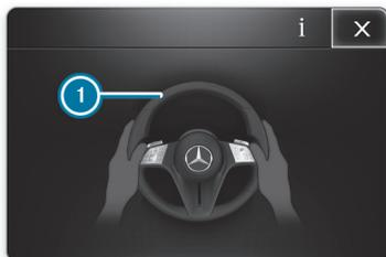
Если система распознает, что водитель относительно долго не управляет автомобилем или убирает руки с рулевого колеса, сперва подается визуальный сигнал. На дисплее водителя появляется индикация ①. Если водитель все равно не начинает активно управлять автомобилем или не реагирует на предупреждение системы, визуальный сигнал дополняется многократным звуковым сигналом.
