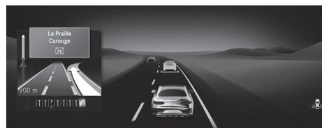
Индикация активной системы поддержания дистанции DISTRONIC в режиме отображения графики сближения (пример)
