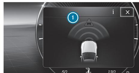
При автоматическом торможении или адаптивном усилении тормозного привода на дисплее водителя отображается всплывающее окно ①, которое вскоре исчезает.
