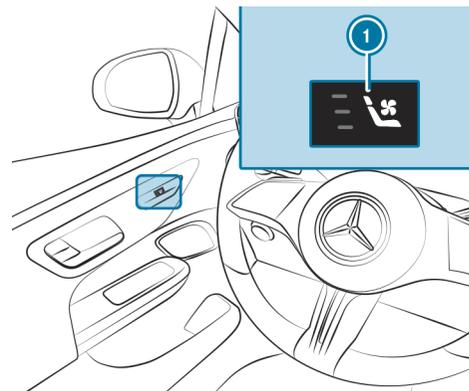
Кнопка вентиляции сидений в панели управления на двери в кабине (пример)
