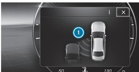
При задействовании тормозной системы, корректирующей курс движения автомобиля, мигает красная сигнальная лампа в наружном зеркале заднего вида и раздается предупредительный звуковой сигнал. Дополнительно на дисплее водителя появляется индикация **1**, обращающая внимание водителя на опасность бокового столкновения.
