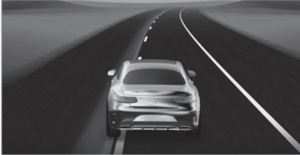
Если одно переднее колесо наезжает на распознанную дорожную разметку, то в меню **Вспомогательные сист.** на дисплее водителя она выделяется красным цветом.
