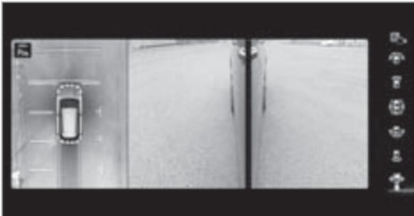
Если устанавливается электрическое соединение автомобиля с прицепом, то индикация переключается на изображение боковых видеокамер. Это изображение поддерживает водителя при маневрировании с прицепом.
