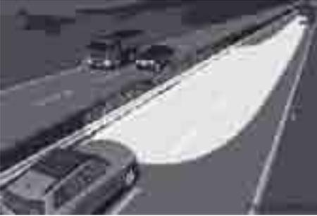
Система освещения для движения по авто-страде повышает радиус действия светового конуса.
