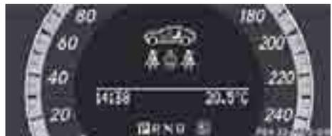
Пример: автомобиль с мультимедийным рулевым колесом с комфортабельными функциями\* (12-кнопочным): левый и правый пассажиры в задней части автомобиля пристегнуты ремнем безопасности.
