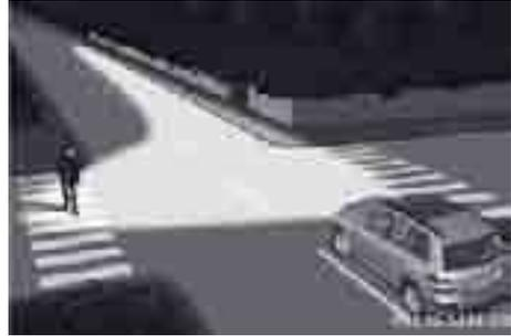
Дополнительная подсветка поворотов<sup>23</sup> расширяет угол высвечивания дорожного полотна в направлении поворота, улучшая таким образом обзор крутых поворотов. Ее активирование возможно только в случае включения ближнего света.
