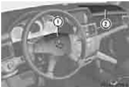
Передняя подушка безопасности водителя ① срабатывает перед рулевым колесом, передняя подушка безопасности переднего пассажира ② – перед и над вещевым ящиком. Они срабатывают:
