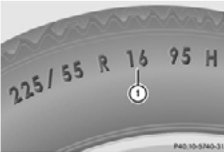
Диаметр колесного диска ① является составной частью размера шины и указан на боковине шины.
