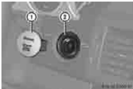
▶ Выньте кнопку пуска / выключения двигателя Start-Stop ① из замка зажигания ②.
