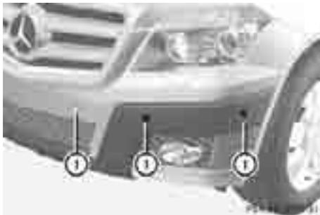
① Пример: датчики на переднем бампере, слева
