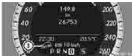
Если Вы движетесь на слишком высокой скорости, на мультифункциональном дисплее появляется символ системы DSR (3). В автомобилях с мультифункциональным рулевым колесом (4-кнопочным) дополнительно появляется сообщение: max. 30 km/h (макс. 30 км/ч), а в автомобилях с мультифункциональным рулевым колесом с комфортабельными функциями\* (12-кнопочным) – сообщение: Макс. 30 км/ч.
