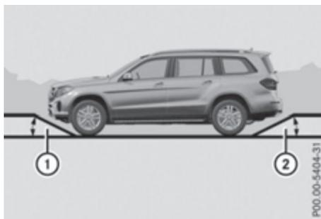
В таблице приведены углы свеса ① и ② для полностью снаряженного автомобиля.
