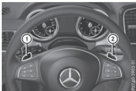
► **Переключение на более высокую передачу:** потяните подрулевой переключатель ②. АКП переключается на следующую более высокую передачу.
