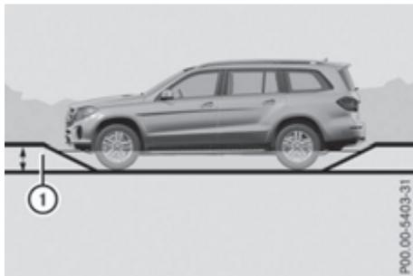
В таблице приведена бродоходимость ① для полностью снаряженного автомобиля.
