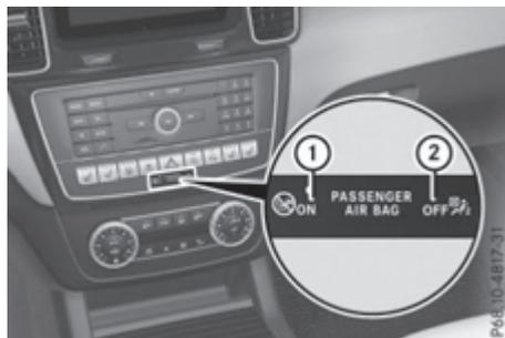
Контрольные лампы PASSENGER AIR BAG ON ① и PASSENGER AIR BAG OFF ② являются частью системы автоматического отключения подушки безопасности переднего пассажира.
