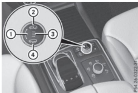
Установка дорожного просвета автомобиля при помощи круглого переключателя
