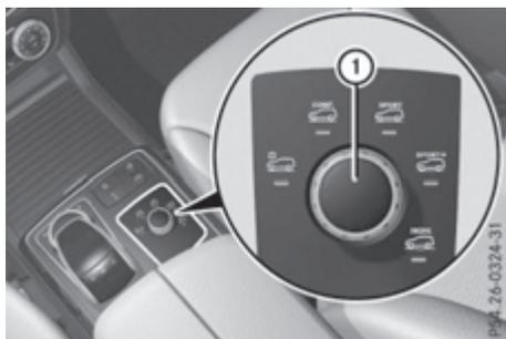
В программе движения **Sport Plus** очень жесткая установка положения ходовой части обеспечивает оптимальный контакт с дорогой. Выбирайте этот режим при динамичном стиле вождения, например, на извилистых шоссейных дорогах или предпочтительно на закрытых кольцевых трассах.
