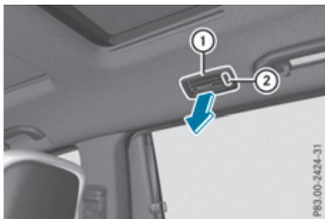
Задний боковой дефлектор на обшивке крыши
