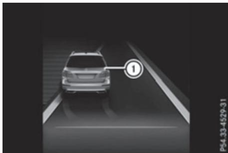
При отклонении от полосы движения в определенных условиях производится кратковременное одно-стороннее тормозное действие. Эта функция помогает направить автомобиль опять на прежнюю полосу движения.
