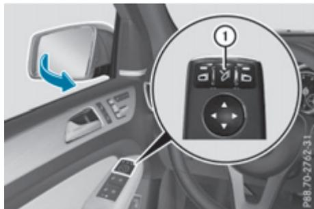
Если при включенной функции **Автомат. складывание** Вы поворачиваете наружные зеркала заднего вида вовнутрь при помощи кнопки ①, то наружные зеркала заднего вида не поворачиваются наружу автоматически (▷ стр. 120).
