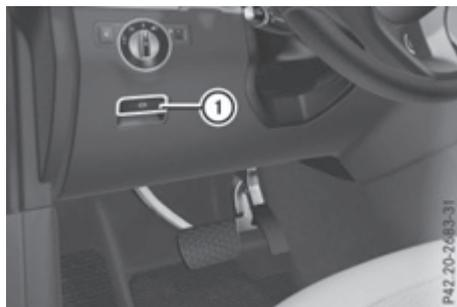
В экстренном случае движущийся автомобиль можно затормозить и электрическим стояночным тормозом.
