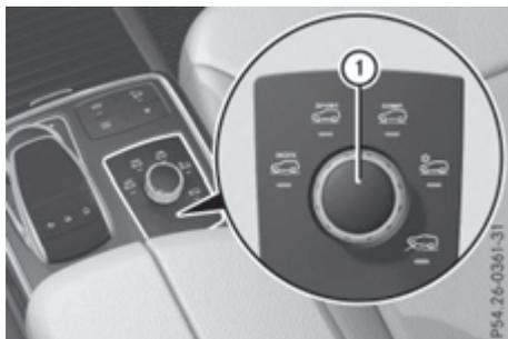
В программе движения **Sport** более жесткая установка ходовой части обеспечивает еще лучший контакт с дорогой. Выбирайте эту программу движения при динамичном стиле вождения, например, на извилистых шоссейных дорогах.
