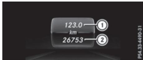
▶ Нажмите на кнопку **↔** на рулевом колесе и держите ее нажатой до тех пор, пока не появится меню **Пут. стат.** с суточным пробегом **①** и общим пробегом **②**.
