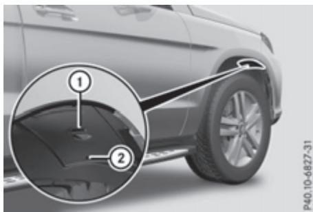
Для замены передних ламп необходимо снять крышку в передней колесной арке.
