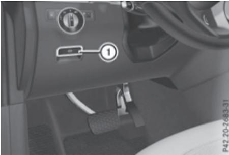
Во избежание откатывания автомобиля назад на подъеме при трогании с места можно пользоваться электрическим стояночным тормозом.
