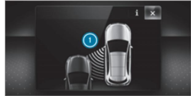
Во время торможения, корректирующего курс движения автомобиля, мигает красная предупредительная сигнальная лампа в наружном зеркале заднего вида и раздается предупредительный звуковой сигнал. Дополнительно на мультимедийном дисплее появляется индикация ①, обращающая внимание водителя на опасность бокового столкновения.
