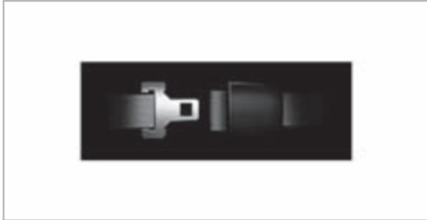
При включенном зажигании индикация состояния ремней безопасности в задней части салона в течение определенного промежутка времени показывает, какой ремень безопасности в задней части салона не пристегнут.
