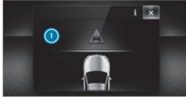
Если происходит автономное торможение или задействуется адаптивная система помощи при торможении, то индицируется сообщение
