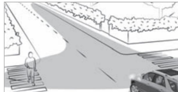
Освещение выполняемого поворота расширяет угол высвечивания дорожного полотна в направлении поворота, тем самым улучшая обзор, например, при поворотах малого радиуса. Его активация возможна только при включенном ближнем свете фар.
