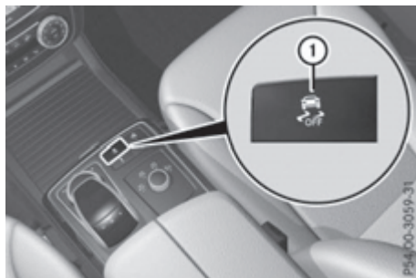
Кнопка ESP®-OFF (автомобили Mercedes-AMG)
