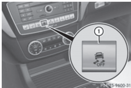
Кнопка ESP®-OFF (кроме автомобилей Mercedes-AMG)
