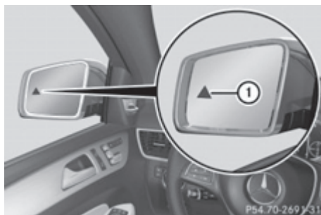
① Желтая контрольная лампа / красная предупредительная сигнальная лампа
