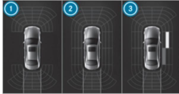
Индикация рулевого ассистента PARKTRONIC: автомобили без видеокамеры с обзором в 360°
