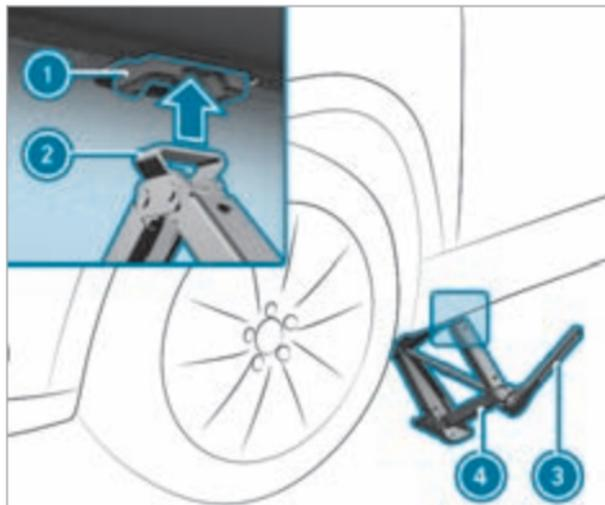
▶ Установите опорную поверхность **2** автомобильного домкрата **4** в опорной точке **1** для подъема домкратом.
