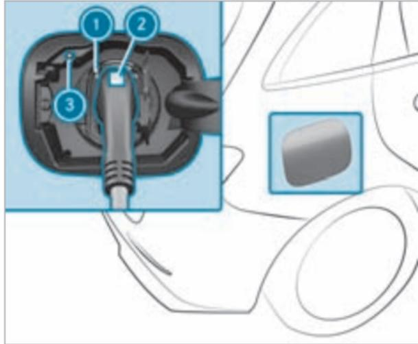
**i** Автомобили, оснащенные розеткой типа 1 для зарядки переменным током, не имеют кнопки прерывания зарядки **3**.
