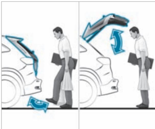
Функция HANDS-FREE ACCESS позволяет движением ноги под задним бампером открывать, закрывать или останавливать дверь багажника.
