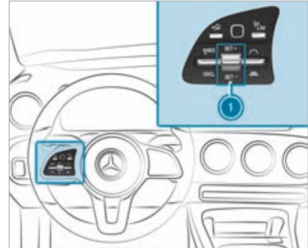
▶ **Управление активной системой поддержания дистанции DISTRONIC:** клавишные переключатели панели управления рулевого колеса нажмите вверх или вниз в требуемое положение.
