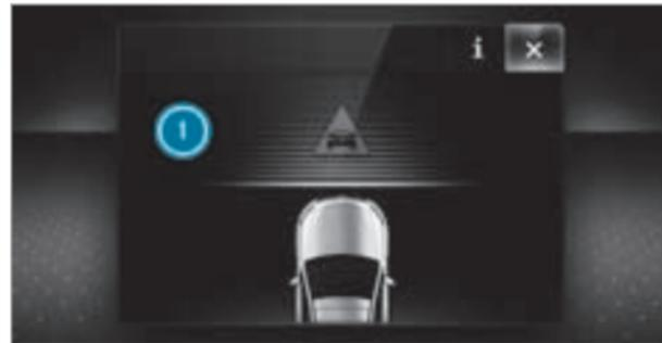
Если происходит автономное торможение или срабатывает адаптивная система помощи при торможении, то отображается сообщение **i** на дисплее приборов, которое вскоре гаснет автоматически.
