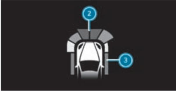
Распознанные системой помощи при парковке PARKTRONIC препятствия могут опционально отображаться также на проекционном дисплее начиная с расстояния примерно 1,0 м спереди ② и 0,6 м по бокам ③.
