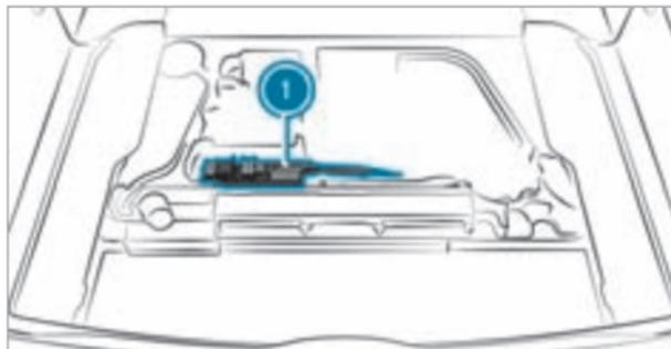
Коробка предохранителей ① находится под полом грузового отделения.
