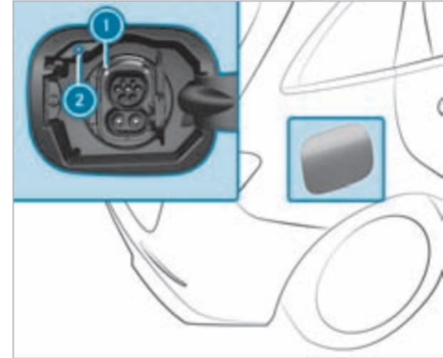
**i** Автомобили, оснащенные только розеткой типа 2 для зарядки переменным током, не имеют кнопки прерывания зарядки **2**.
