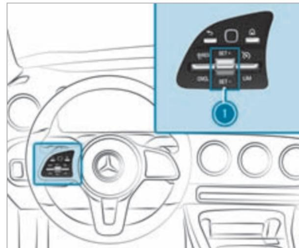
▶ **Управление системой круиз-контроля TEMPOMAT или регулируемым ограничителем скорости:** клавишные переключатели панели управления рулевого колеса нажмите вверх или вниз в требуемое положение.
