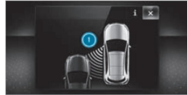
Во время торможения, корректирующего курс движения автомобиля, мигает красная сигнальная лампа в наружном зеркале заднего вида и раздается предупредительный звуковой сигнал. Дополнительно на дисплее приборов появляется индикация **1**, обращающая внимание водителя на опасность бокового столкновения.
