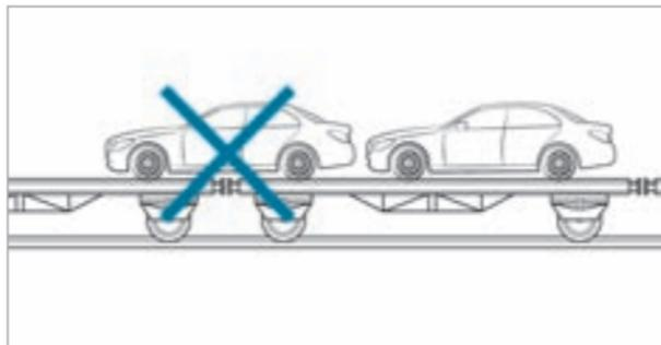
▶ Следите за тем, чтобы передний и задний мосты находились на одной платформе эвакуатора.
