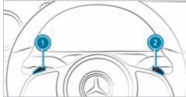
Если автоматическая коробка передач включена в положение **D**, то ручное переключение АКП возможно с помощью подрулевых селекторов. Если доступно, то в зависимости от задействованного подрулевого селектора АКП автоматическая
