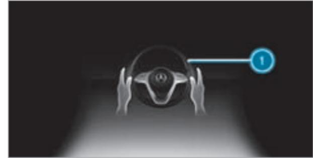
Если система распознает, что водитель долго не осуществляет управление автомобилем самостоятельно или снимает руки с рулевого колеса, то появляется индикация ❶. Если водитель и далее не начинает активно управлять автомобилем, то дополнительно к визуальному сигналу многократно звучит предупредительный звуковой сигнал.
