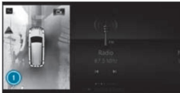
Автомобили с видеокамерой с обзором в 360°
