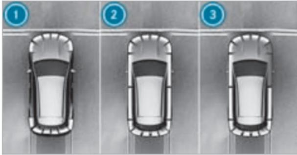
Индикация рулевого ассистента PARKTRONIC: автомобили с видеокамерой с обзором в 360°
