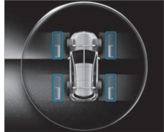
Текущее распределение приводного момента на все четыре колеса можно отобразить на проекционном дисплее и в правой области индикации дисплея приборов. Чем выше заполнена соответствующая шкала, тем выше соответствующий приводной момент.
