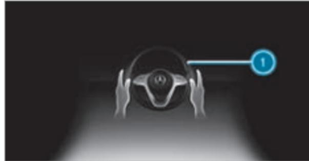
Если система распознает, что водитель долго не осуществляет управление автомобилем самостоятельно или снимает руки с рулевого колеса, то появляется индикация ⓘ. Если водитель и далее не начинает активно управлять автомобилем или не реагирует на срабатывание системы, то дополнительно к визуальному сигналу многократно звучит предупредительный звуковой сигнал.
