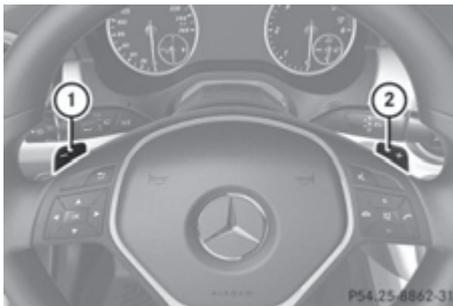
① Левый подрулевой переключатель передач (переключение на более низкую передачу)
