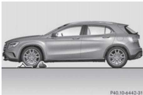
Предохранение автомобиля от откатывания на ровном грунте
