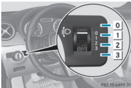
Регулятор угла наклона фар
