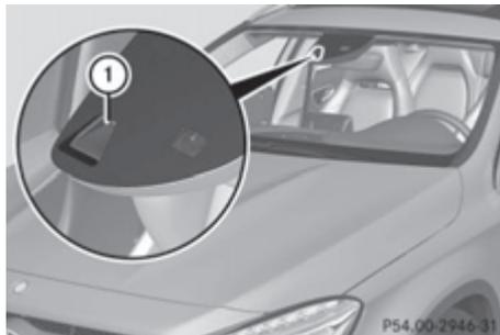
Система удержания полосы движения контролирует зону перед Вашим автомобилем при помощи видеокamеры, установленной сверху за ветровым стеклом ①. Если система удержания полосы движения распознает на дороге ограничительные линии разметки дорожного полотна, то она может предупредить водителя при непреднамеренном отклонении от полосы движения. Эта функция действует в диапазоне скоростей от 60 до 200 км/ч.
