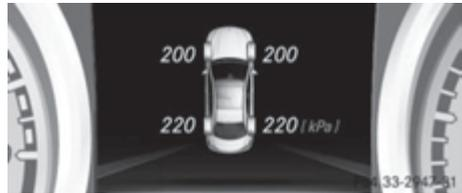
Индикация давления воздуха в шинах в данный момент (пример)
