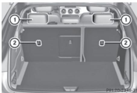
Дополнительные крепления Top Tether смонтированы на задней стороне обеих крайних спинок сидений.
