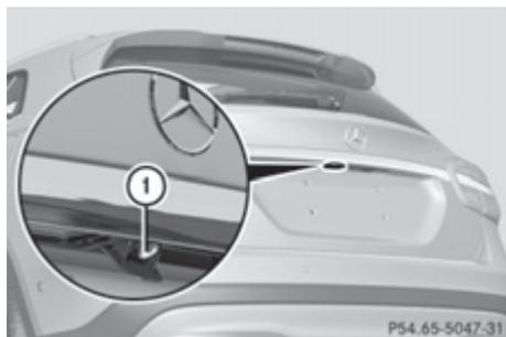
Видеокамера заднего хода ① находится в ручке двери багажного отделения.
