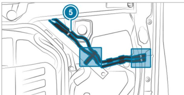
▶ При наличии шлангов 5 закрепите их в удерживающих скобах в моторном отсеке и на кузове.
