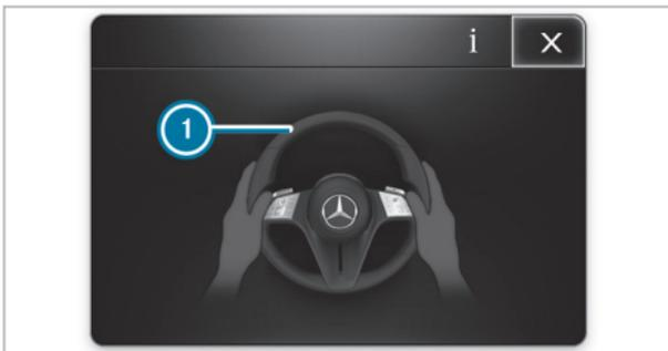
Если система распознает, что водитель относительно долго не осуществляет управление самостоятельно или снимает руки с рулевого колеса, то она сначала оповещает его при помощи визуального сигнала. На дисплее водителя появляется индикация ❶. Если водитель и далее не начинает активно управлять автомобилем или не реагирует на срабатывание системы, то дополнительно к визуальному сигналу многократно звучит предупредительный звуковой сигнал.
