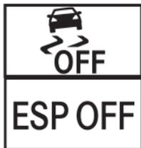
\* При включенном двигателе автомобиля горят желтые сигнальные лампы ESP® ВЫКЛ.
