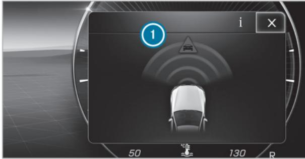
При автономном торможении или адаптивном усилении тормозного привода на дисплее водителя отображается всплывающее окно ❶, которое вскоре исчезает автоматически.
