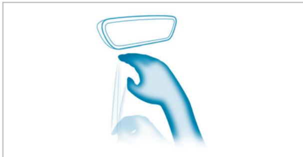
Управление светом лампы для чтения водителем и передним пассажиром
