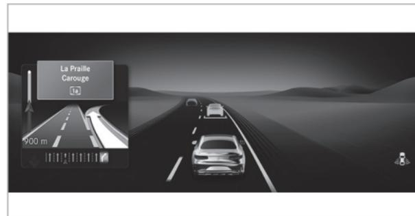
Индикация активной системы поддержания дистанции DISTRONIC в режиме отображения графики сближения (пример)
