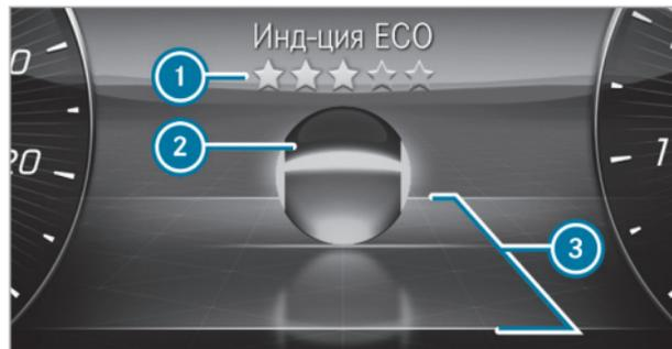
Индикация ECO в зависимости от ситуации показывает на дисплее водителя оценку Вашего стиля вождения. С ее помощью Вы сможете проверить эффективность своего стиля вождения и при необходимости скорректировать его. В меню **Индикация ECO** отображается шарик (2), который в соответствии со стилем вождения перемещается по стилизованной улице в направлении движения вперед или назад.
