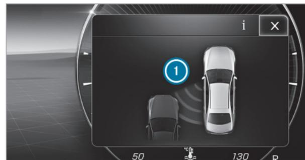
При задействовании тормозной системы, корректирующей курс движения автомобиля, мигает красная сигнальная лампа в наружном зеркале заднего вида и раздается предупредительный звуковой сигнал. Дополнительно на дисплее водителя появляется индикация
