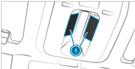
❶ Расположение передних камер в потолочной блок-панели управления
