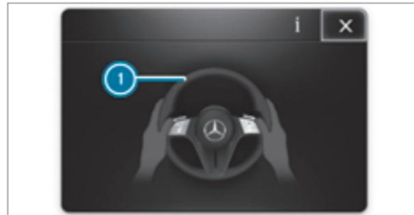
Если система распознает, что водитель относительно долго не осуществляет управление самостоятельно или снимает руки с рулевого колеса, то она сначала предостерегает его при помощи оптического сигнала. На дисплее водителя появляется индикация ❶. Если водитель и далее не начинает активно управлять автомобилем или не реагирует на срабатывание системы, то дополнительно к оптическому сигналу многократно звучит предупредительный звуковой сигнал.
