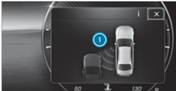
Во время торможения, корректирующего курс движения автомобиля, мигает красная предупредительная сигнальная лампа в наружном зеркале заднего вида и раздается предупредительный звуковой сигнал. Дополнительно на дисплее водителя появляется индикация ❶, обращающая внимание водителя на опасность бокового столкновения.
