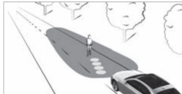
Функция направленного света работает в фоновом режиме и при распознавании пешеходов в пределах дорожной разметки посылает четыре коротких световых импульса. Внимание водителя привлекается посредством проекции символа на место движущихся навстречу пешеходов.
