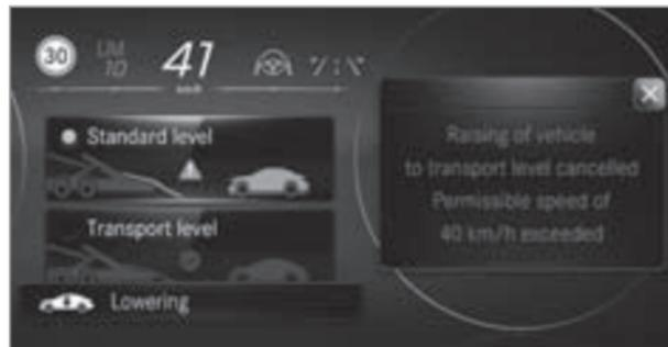
Кузов автомобиля будет установлен на высоту последнего активированного уровня.
