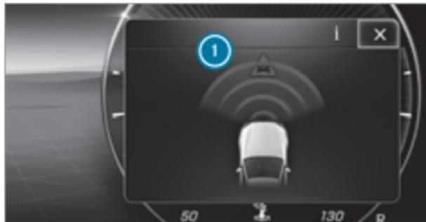
Если происходит автономное торможение или задействуется адаптивная система помощи при торможении, то на дисплее водителя индицируется всплывающее окно, и самостоятельно гаснет после непродолжительного времени. **❗**
