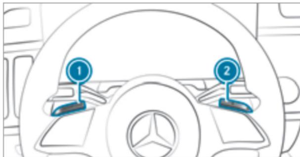
Если автоматическая коробка передач переключена в положение **D**, с помощью подрулевых селекторов АКП можно переключать передачи вручную. Если это возможно, в зависимости от задействованного подрулевого селектора АКП автоматическая коробка передач переключится на более высокую или более низкую передачу.
