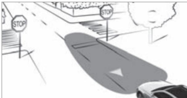
Если система распознавания дорожных знаков распознает соответствующую ситуацию, при скорости более 30 км/ч в следующих ситуациях на дорожное полотно проецируется треугольник:
