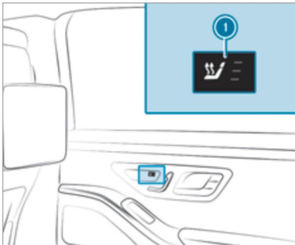
▶ Нажимайте кнопку **1** до тех пор, пока не будет достигнут нужный уровень обогрева. В зависимости от уровня обогрева горит от одной до трех контрольных ламп. Если все контрольные лампы выключены, система подогрева сидений выключена.
