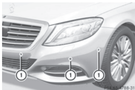
① Датчики в переднем бампере, слева (пример)
