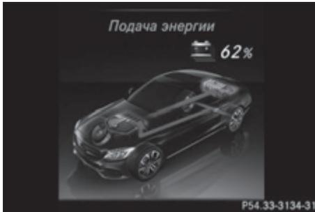
Двигатель внутреннего сгорания приводит автомобиль в движение.
