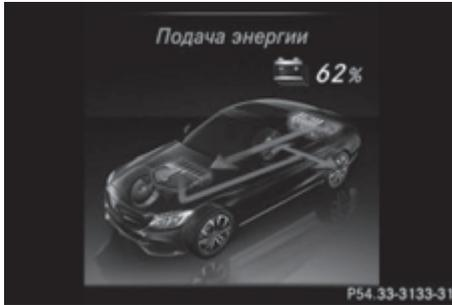
При быстром нажатии на педаль акселератора электродвигатель поддерживает двигатель внутреннего сгорания дополнительным тяговым моментом.
