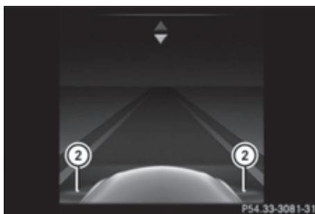
Если сигнализация перестроения включена, то на графике сближения на мультимедийном дисплее рядом с автомобилем появляются серые радарные волны, расширяющиеся назад. При скорости выше 30 км/ч радарные волны на графике сближения окрашиваются в зеленый цвет ②. В таком случае сигнализация перестроения готова к эксплуатации.
