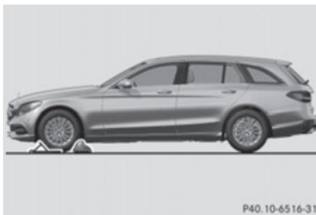
Предохранение автомобиля от откатывания на ровном грунте
