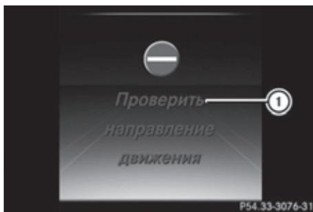
Если система распознавания дорожных знаков при проезде знака "Въезд запрещен" распознает движение против предписанного направления движения, то на комбинации приборов индицируется предупреждение. Дополнительно раздается предупредительный звуковой сигнал. С целью предотвращения опасности для Вас и других участников дорожного движения немедленно проконтролируйте Ваше направление движения.
