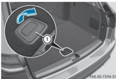
Под полом багажного отделения размещены комплектующие детали комплекта крепления груза EASY-PACK, комплект для временного ремонта шин TIREFIT, комплект бортового инструмента и т. д.
