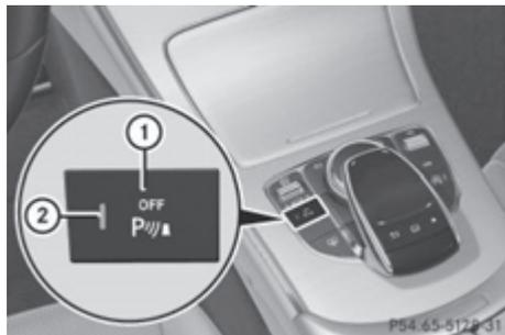
① Выключение или включение системы "ПАРКТРОНИК"
