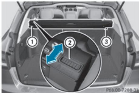
Демонтаж и монтаж двойной шторки можно производить со стороны багажного отделения, а при откинутой вперед спинке сиденья – со стороны задней левой двери.
