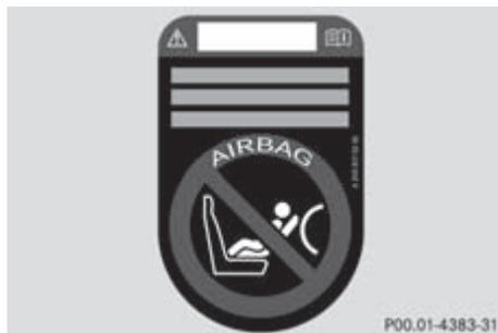
Если Ваш автомобиль не оснащен системой автоматического отключения подушки безопасности переднего пассажира, то Вы распознаете это по специальной наклейке. Наклейка находится на стороне переднего пассажира сбоку на панели приборов. Наклейка видна при открытой двери переднего пассажира.
