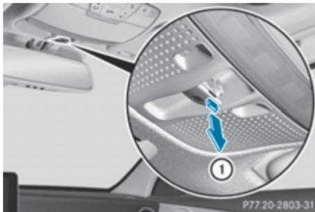
Если передняя солнцезащитная шторка или панорамная сдвижная панель крыши движется только рывками, заново отъюстируйте панорамную сдвижную панель крыши или солнцезащитную шторку.
