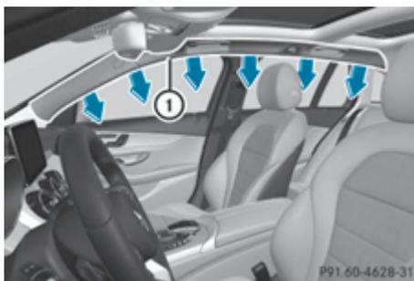
Оконные подушки безопасности ① вмонтированы в раму крыши между стойками А и С.
