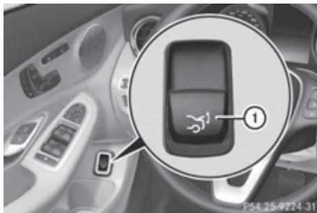
При остановке и разблокировке автомобиля Вы можете открыть и закрыть дверь багажного отделения с сиденья водителя.
