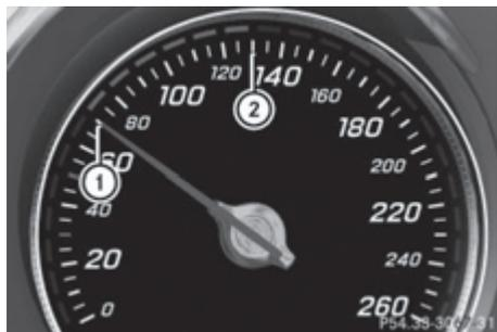
В момент распознавания системой "ДИСТРОНИК ПЛЮС" движущегося впереди автомобиля высвечиваются сегменты от значения скорости движущегося впереди автомобиля ① до введенной в память скорости ②. Если движущийся впереди автомобиль распознается на полосе для обгона, то сегменты также светятся.
