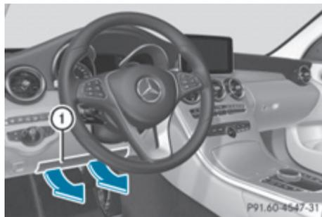
Коленная подушка безопасности водителя **①** раскрывается под колонкой рулевого управления. Коленная подушка безопасности водителя срабатывает вместе с передними подушками безопасности.
