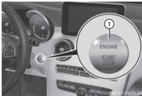
Если Вы еще не нажали на кнопку пуска / выключения двигателя Start/Stop ①, то это равнозначно положению замка зажигания при вынужденном выключении ключа.
