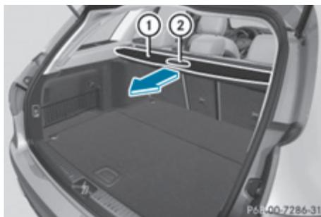
► **Разматывание:** потяните горизонтальную шторку багажного отделения ① за ручку ② назад и закрепите ее в приемных гнездах слева и справа.
