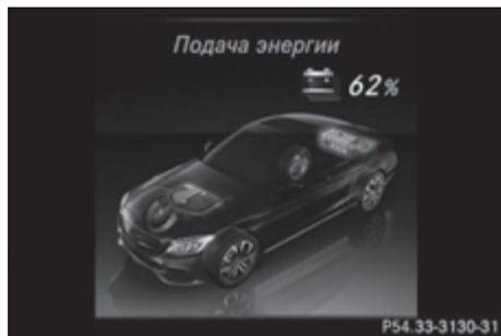
Двигатель внутреннего сгорания работает, а автомобиль при этом стоит. Высоковольтная аккумуляторная батарея не заряжается.
