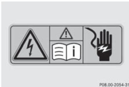
Все элементы гибридной системы обозначены желтыми наклейками с предостережением от опасностей, грозящих в связи с высоким напряжением. Кабели высоковольтной бортовой сети имеют оранжевый цвет.
