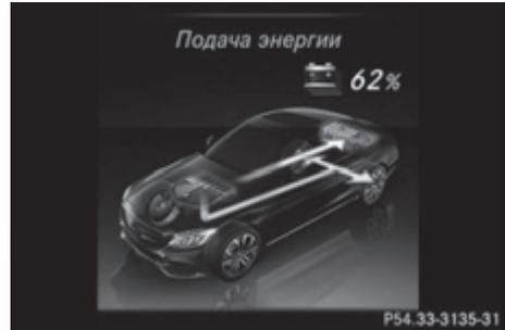
Двигатель внутреннего сгорания приводит автомобиль в движение. Двигатель внутреннего сгорания дополнительно приводит в действие электродвигатель. Электродвигатель работает в качестве генератора. Высоковольтная аккумуляторная батарея заряжается.
