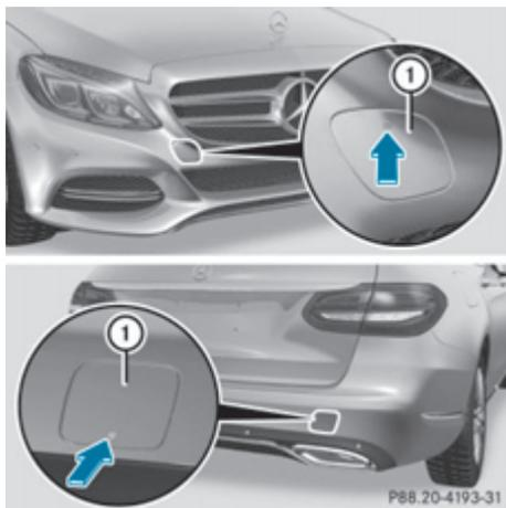
Отверстия для ввинчиваемой буксирной проушины находятся в бамперах. Они находятся соответственно впереди и сзади под крышками ①.
