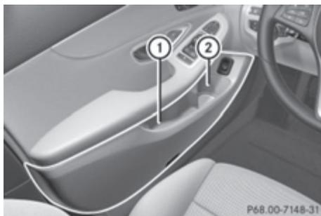
В вещевом отсеке ① в дверях можно, например, хранить свернутый сигнальный жилет (дверь водителя) и сумку с документами на автомобиль (дверь переднего пассажира).
