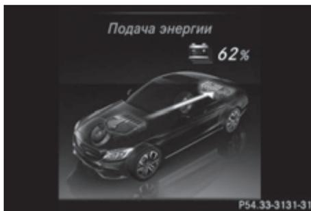
Двигатель внутреннего сгорания приводит в действие электродвигатель. Электродвигатель работает в качестве генератора. Высоковольтная аккумуляторная батарея заряжается.
