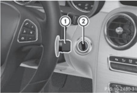
Вы можете вынуть кнопку пуска / выключения двигателя Start/Stop из замка зажигания и запустить двигатель автомобиля, как обычно, ключом.
