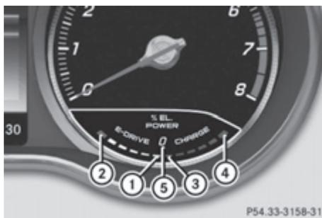
Индикация мощности электродвигателя находится справа на комбинации приборов.
