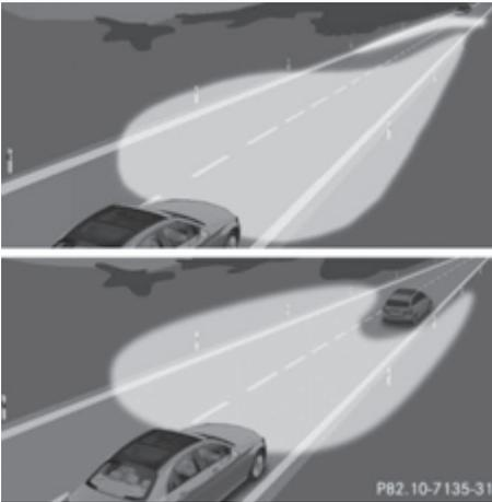
При помощи системы адаптации фар дальнего света с расширенными функциями возможно автоматическое переключение между ближним светом, приглушенным дальним светом и дальним светом.
