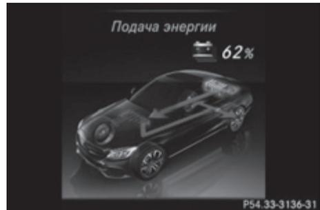
Электродвигатель приводит автомобиль в движение. Высоковольтная аккумуляторная батарея снабжает электродвигатель электроэнергией.
