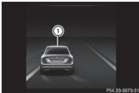
При торможении для корректировки курса движения автомобиля на мультифункциональном дисплее появляется индикация ①. С помощью торможения также несколько снижается скорость движения.
