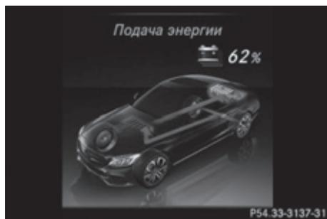
Электродвигатель эксплуатируется в качестве генератора, например, в режиме принудительного холостого хода и при торможении. Кинетическая энергия автомобиля превращается в электроэнергию. Высоковольтная аккумуляторная батарея заряжается.
