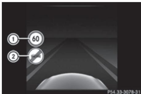
Действует максимально допустимая скорость 60 км/ч (60 миль/ч) ①. Запрет обгона был отменен ②. Дорожный знак "Отмена запрета обгона" индицируется примерно в течение пяти секунд.
