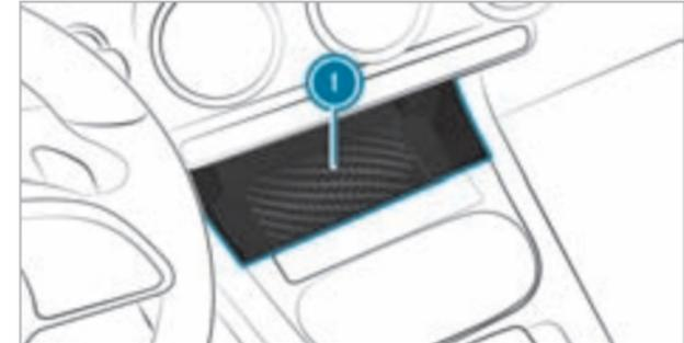
▶ По возможности положите мобильный телефон по центру подкладки на обозначенную поверхность ① дисплеем вверх. Если в мультимедийной системе индицируется указание, то мобильный телефон заряжается.
