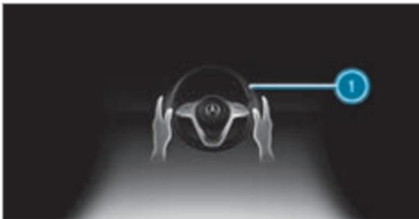
Если система распознает, что водитель относительно долго не осуществляет управление самостоятельно или снимает руки с рулевого колеса, то появляется индикация ❶. Если водитель и далее не начинает активно управлять автомобилем, то дополнительно к оптическому сигналу многократно звучит предупредительный звуковой сигнал.
