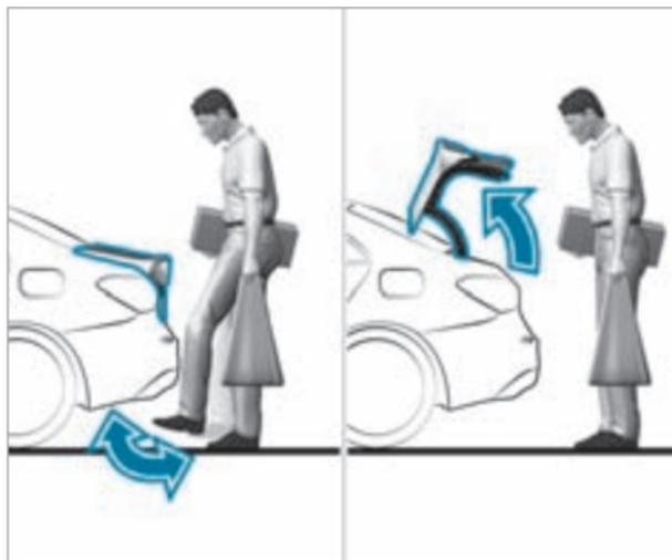
Функция HANDS-FREE ACCESS позволяет открывать крышку багажника путем движения ногой под задним бампером.
