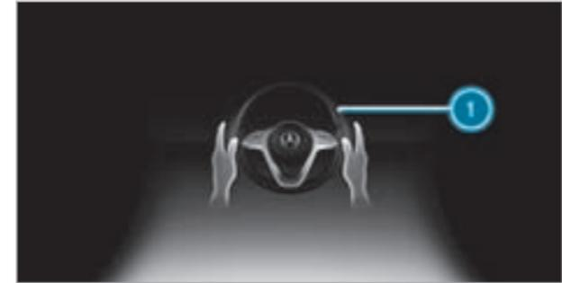
Если система распознает, что водитель относительно долго не осуществляет управление самостоятельно или снимает руки с рулевого колеса, то появляется индикация **1** на дисплее приборов. Если водитель и далее не начинает активно управлять автомобилем или не реагирует на срабатывание системы, то дополнительно к оптическому сигналу многократно звучит предупредительный звуковой сигнал.
