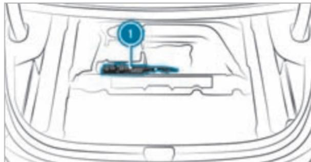
Блок предохранителей ① находится посередине под полом багажника.
