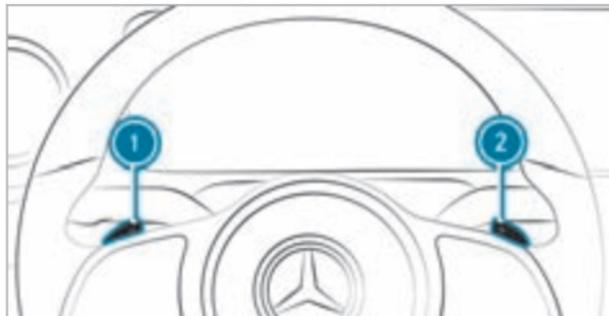
Если автоматическая коробка передач включена в положение **D**, с помощью подрулевых селекторов АКП можно переключать передачи вручную. Если доступно, в зависимости от задействованного подрулевого селектора АКП автоматическая коробка передач переключится на более высокую или более низкую передачу.
