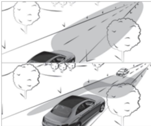
Система адаптивного управления дальним светом автоматически выполняет переключение между следующими вариантами освещения:
