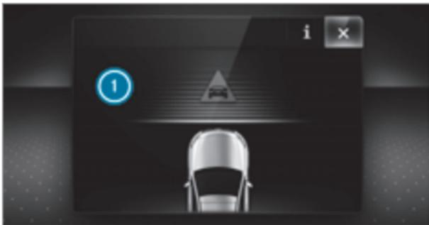
Если происходит автономное торможение или задействуется адаптивная система помощи при торможении, то индицируется сообщение ❶ на мультимедийном дисплее, и самостоятельно гаснет после непродолжительного времени.
