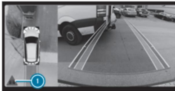
**Автомобили с сигнализацией перестроения:** при выезде с места парковки задним ходом дополнительно может быть выдано предупреждение о транспорте, пересекающем путь следования в попереч-
