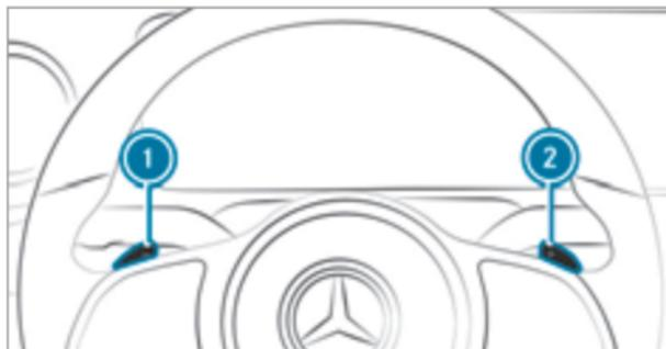
Если автоматическая коробка передач переведена в положение **D**, с помощью подрулевых селекторов АКП Вы можете переключать ее вручную. Если допустимо, в зависимости от использованного подрулевого селектора АКП автоматическая коробка передач переключается на следующую более высокую или более низкую передачу.
