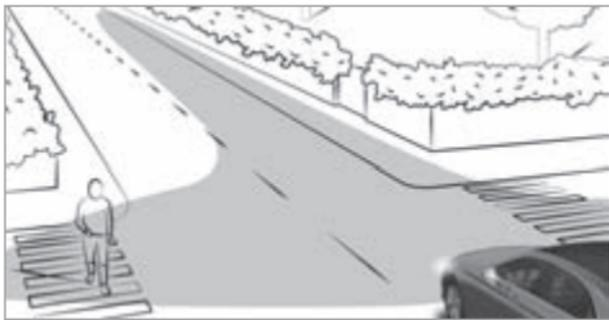
Освещение выполняемого поворота расширяет угол высвечивания дорожного полотна в направлении поворота, таким образом улучшая обзор, например, поворотов малого радиуса. Его активирование возможно только при включенном ближнем свете.
