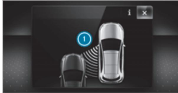
Во время торможения, корректирующего курс движения автомобиля, мигает красная предупредительная сигнальная лампа в наружном зеркале заднего вида и раздается предупредительный звуковой сигнал. Дополнительно на мультимедийном дисплее появляется индикация ❶, обращающая внимание водителя на опасность бокового столкновения. В редких случаях система производит необоснованное тормозное действие. Вы можете прервать это
