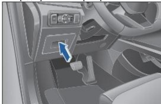
Блок предохранителей приборной панели расположен за нижней левой панелью приборной панели, и для проверки и замены предохранителя можно снять крышку на нижней левой панели приборной панели.
