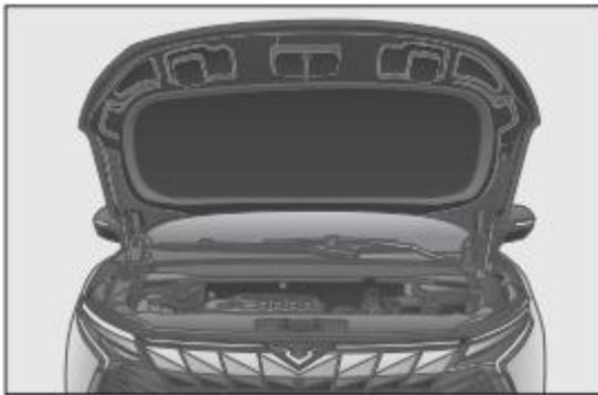
2. Поднимите капот, и пневматические упоры автоматически удержат его в открытом положении.
