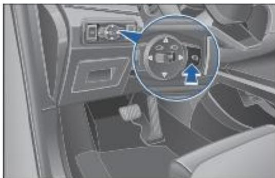
Когда зажигание включено, наружное зеркало может быть сложено с помощью кнопки складывания наружного зеркала.
