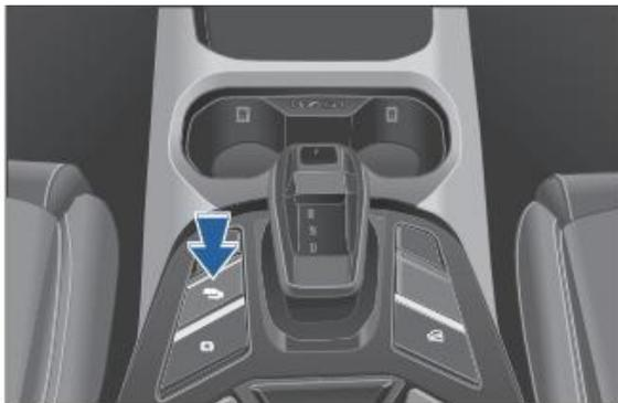
При включенном зажигании коротко нажмите кнопку AVM для попадания в режим кругового обзора автомобиля. Удерживайте кнопку нажатой в течение 10 секунд, чтобы перезапустить мультимедиа.
