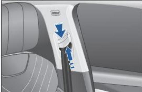
1. Нажмите кнопку регулировки высоты ремня безопасности вверх, чтобы отрегулировать ремень безопасности до подходящей высоты.
