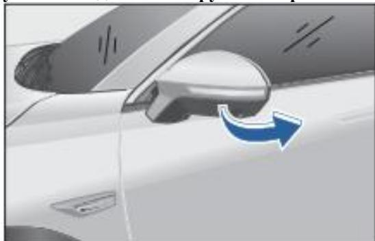
Если автомобиль не оборудован наружным зеркалом с электроприводом, корпус наружного зеркала при необходимости можно сложить вручную. Нажмите на наружные зеркала в направлении задней части автомобиля, складывая их.
