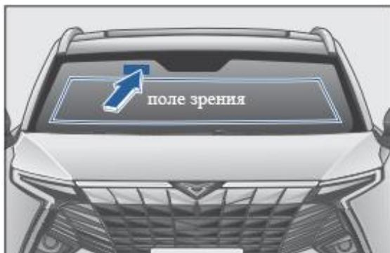
Черная рамка лобового стекла и область за пределами поля зрения могут использоваться для установки радиочастотной идентификации автомобиля, с приоритетом рекомендуется установка на пассажирской стороне (область, обозначенная стрелкой).
