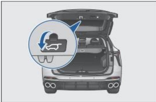
Когда в автомобиле нет питания или крышка багажника не открывается нормально, в аварийной ситуации вы можете открыть крышку багажника изнутри автомобиля.
