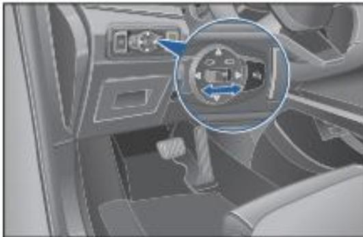
Перед началом движения запустите двигатель, Отрегулируйте наружные зеркала под подходящий угол следующим образом.
