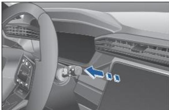
Потяните переключатель управления стеклоочистителем в направлении рулевого колеса, передний омыватель начнет распылять мощную жидкость, стеклоочиститель будет протирать 3 раза при низкой скорости, затем протрет 1 раз через 6 секунд и остановится.
