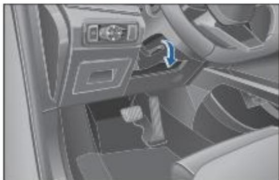
Регулировка рулевого колеса может сделать управление автомобилем более комфортным для людей разного роста. Перед началом движения автомобиля отрегулируйте положение рулевого колеса в соответствии со своими потребностями.
