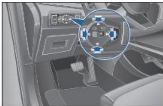
2. Нажмите кнопку регулировки наружного зеркала, чтобы настроить наружное зеркало на оптимальное положение заднего вида.
