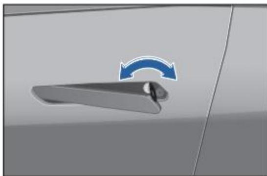
Нажмите на левый край дверной ручки, потяните за правый край дверной ручки, вставьте механический ключ в замок и поверните.
