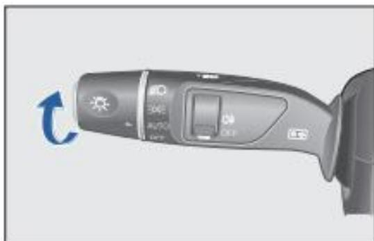
Поверните переключатель света в положение «AUTO», при слабом освещении можно автоматически включить ближний свет, габаритный огонь и индикатор на приборе; Он автоматически выключается при достаточном освещении.
