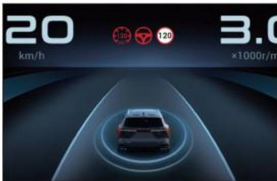
Интерфейс ADAS отображает информацию о расстоянии между автомобилем и впереди идущим автомобилем.
