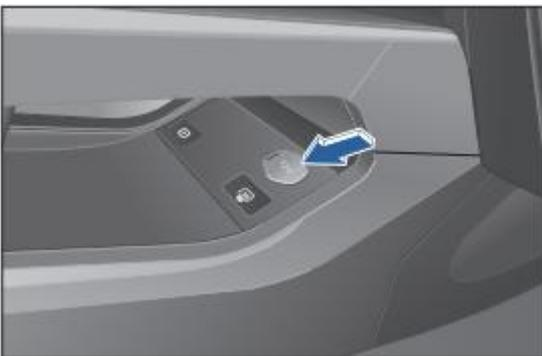
Когда питание автомобиля находится в режиме "ON" или "ACC", откройте крышку резервного источника питания и подключите устройство для зарядки.
