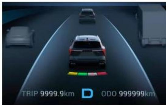
Задний радар разделен на четыре фиксированных отображения в соответствии с расположением четырех ультразвуковых радаров (примечание: есть отличия с отображением переднего радара, только один экран будет отображаться на инструментальной панели и мультимедийном экране).
