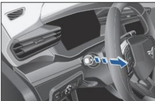
Потяните переключатель управления светом назад в крайнее положение рядом с рулевым колесом, загорится дальний свет, переключатель света автоматически вернется в положение после отпускания, и дальний свет погаснет. При обгоне постоянно тяните назад, отпустите переключатель управления светом и подайте сигнал об обгоне.
