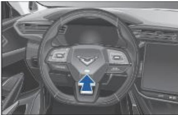
Автомобильные клаксоны используются для заблаговременного предупреждения на специальных участках дороги или при возникновении чрезвычайных ситуаций, чтобы обеспечить безопасность движения. Независимо от того включено зажигание или нет, нажмите на зону звукового сигнала, расположенную на рулевом колесе, и прозвучит клаксон.
