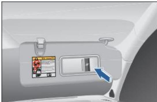
Для использования косметического зеркала сдвиньте крышку зеркала в открытое положение.
