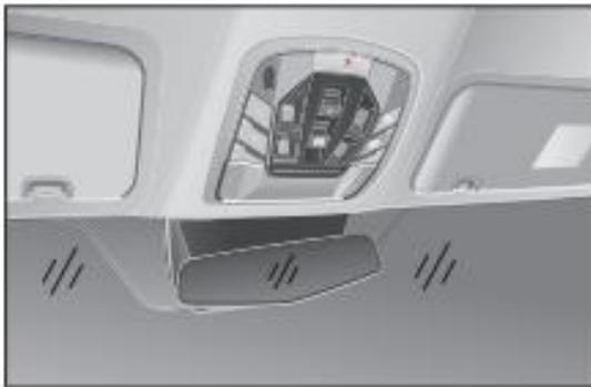
Автоматическое антибликовое внутреннее зеркало заднего вида может изменять отражающую способность внутреннего зеркала заднего вида, реагируя на действие переднего/заднего датчика света. Это позволяет видеть ситуацию позади автомобиля без ослепления.
