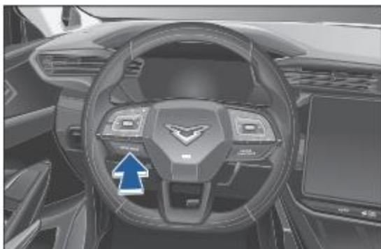
Когда питание включено, нажмите кнопку "DRIVEMODE" на рулевом колесе, чтобы переключаться между режимами движения.
