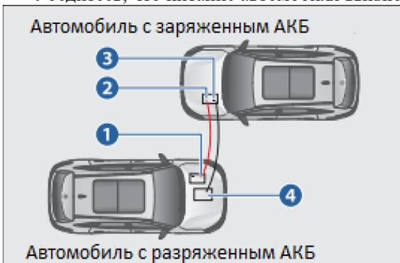
1. Подключите один конец красного положительного (+) кабеля к положительной (+) клемме ❶ разряженного аккумулятора автомобиля.
