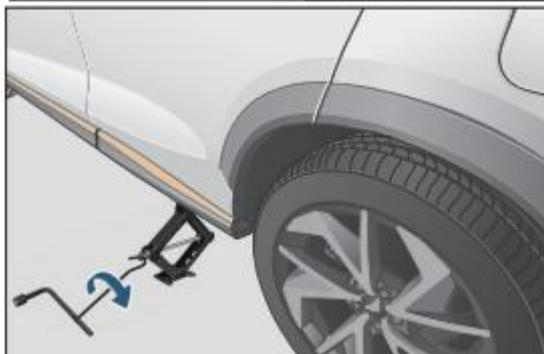
3. Вставьте рукоятку домкрата в домкрат, вставьте колесный ключ в рукоятку домкрата, поверните колесный ключ по часовой стрелке, медленно поднимите домкрат и слегка оторвите колесо от земли.
