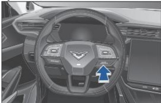
Рычаг переключения передач находится на передаче «Р» или «N», нажмите на педаль тормоза, нажмите кнопку запуска двигателя и двигатель запустится.
