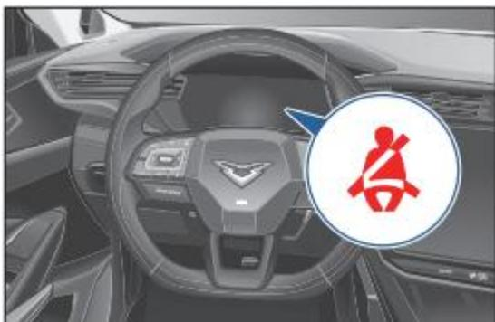
В этом автомобиле установлен индикатор и звуковой сигнализатор непристегнутого ремня безопасности водителя для напоминания водителю пристегнуть ремень безопасности. Подробную информацию можно найти в разделе "Оборудование и операция автомобиля - Приборы - Индикаторы приборов". Страница 25.
