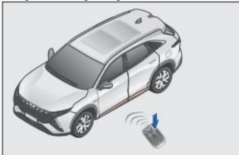
В зоне действия беспроводного ключа, когда зажигание выключено, нажмите кнопку разблокировки на брелке, все двери разблокируются, а указатель поворота мигнет 2 раза.
