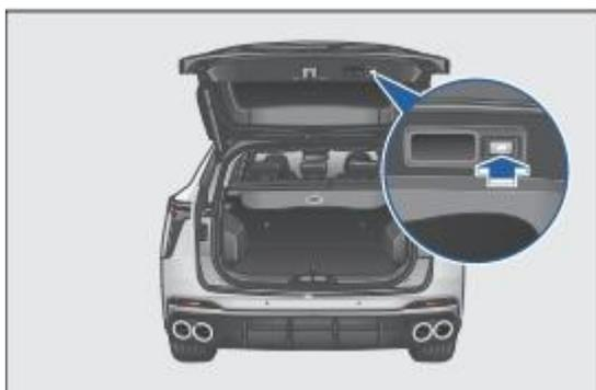
Когда крышка багажника открыта, нажмите кнопку закрытия крышки багажника один раз, и крышка багажника закроется автоматически. Во время закрытия крышки багажника снова нажмите на кнопку закрытия крышки, и крышка багажника остановится в своем текущем положении.
