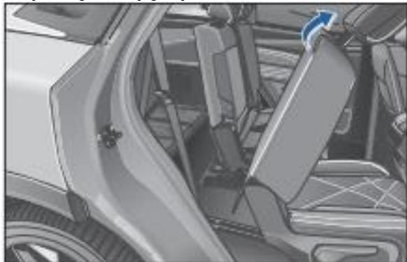
Потяните вверх ручку застежки складывания сидений второго ряда, толкните спинки сидений второго ряда вперед, сложите спинки сидений второго ряда и сдвиньте сиденья вперед до самой передней части, облегчая доступ и выход с третьего ряда сидений.
