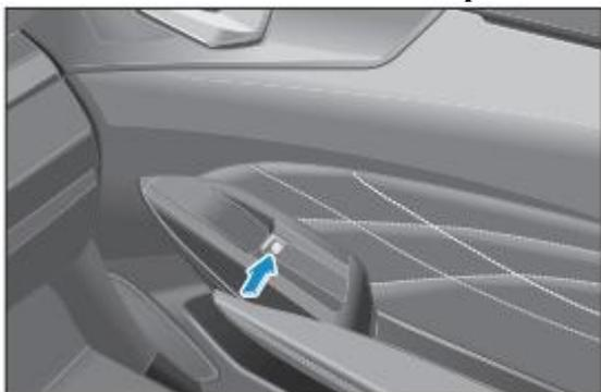
При включенном зажигании (или в течение 2 мин после выключения и при закрытых передних дверях) кнопка стеклоподъемника на стороне пассажира будет работать.
