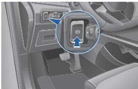
Когда статический стояночный тормоз активирован, автомобиль полностью остановлен, а передача находится в положении "P" или "N", нажмите верхнюю часть выключателя электронного стояночного тормоза EPB. Когда верхняя часть выключателя электронного стояночного тормоза EPB нажата, выключатель загорается, и индикатор стояночного тормоза (P) на приборной панели загорается, указывая на активацию электронного стояночного тормоза.
