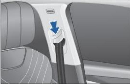
1. Нажмите кнопку регулировки регулятора высоты ремня безопасности, удерживайте регулятор высоты и перемещайте его вниз, чтобы отрегулировать ремень безопасности до нужной высоты.
