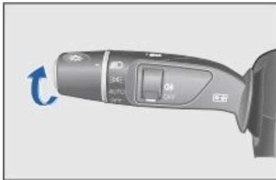
Когда зажигание включено, поверните переключатель света в положение
