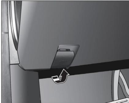
1. Потяните за ручку открытия капота, расположенную в передней части порога двери со стороны водителя, в направлении, указанном стрелкой, в этот момент капот будет разблокирован и слегка приподнимется;
