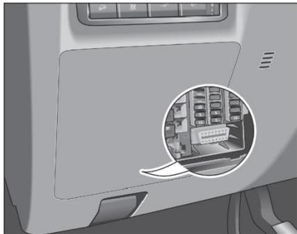
Диагностический интерфейс расположен под блоком предохранителей приборной панели.
