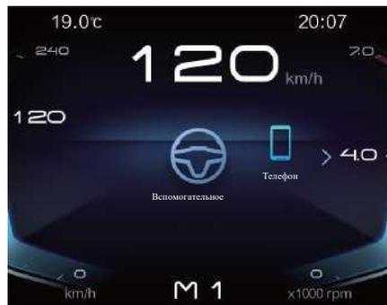
После входа в интерфейс настройки помощи при коротком нажатии **Δ**/**▽** кнопке можно выбрать «помощь при внимании» и «сигнализатор скорости», короткое нажатие кнопки подтверждения, **OK** чтобы подтвердить текущий выбор, и вернуться к предыдущему интерфейсу после завершения подтверждения.
