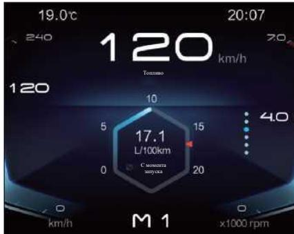
Интерфейс расхода топлива отображает два вида информации: средний расход топлива и мгновенный расход топлива.
