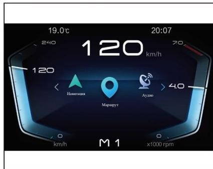
Когда кнопка запуска/остановки без ключа находится в режиме «RUN», в информационном интерфейсе поездки короткое нажатие **▲** / **▼** кнопка может переключаться между информацией о поездке, и информация, которую можно просмотреть, включает: пробег, запас хода, расход топлива, с момента запуска, самосброс, с момента заправки.
