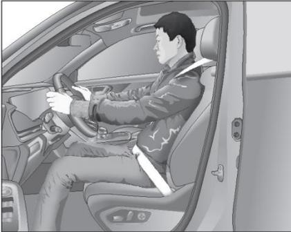
Водитель может регулировать высоту рулевого колеса в соответствии со своим типом телосложения и привычками вождения.
