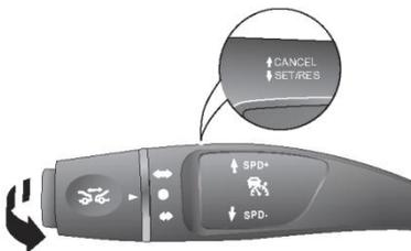
Передача SET/RES (потяните рычаг адаптивного круиз-контроля к плоскости рулевого колеса): активирует ACC/восстанавливает ACC;
