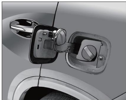
При заправке топливом медленно отвинтите крышку заливной горловины против часовой стрелки и, прежде чем полностью вывинтить ее, приостановите крышку заливной горловины в заливном отверстии на небольшую паузу, чтобы сбросить внутреннее давление, затем снимите крышку заливной горловины и вставьте ее в зажим.
