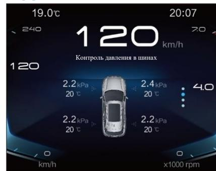
Информация о шине показывает давление и температуру шины. В нормальных условиях информация о давлении в шинах на комбинации приборов отображается белым цветом, когда давление в шинах ненормальное, загорается сигнальная лампа контроля давления в шинах на комбинации приборов, сопровождаемая звуковым сигналом, а информация о давлении в шинах,
