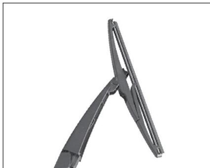
3. Наклонно вытяните держатель щетки стеклоочистителя;
