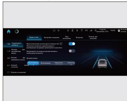
Пользователи могут включить или выключить функцию intelligent cruise assist (включая функцию адаптивного круиза) с помощью центрального экрана управления, а также выбрать подсказку о выезде и целевой звуковой сигнал впереди идущего автомобиля.
