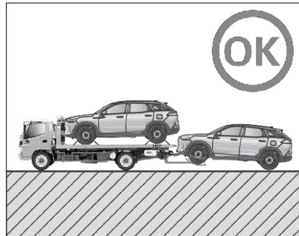
Отпустите неисправный электронный стояночный тормоз (нажмите на электронный парковочный выключатель и удерживайте его более 3 секунд, прежде чем выключить кнопку старт/стоп, при этом выключив питание автомобиля), поднимите и зафиксируйте передние колеса.
