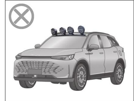
После установки мощных электроприборов, отличных от номинальной мощности, это приведет к нагреву проводов и короткому замыканию из-за чрезмерной нагрузки, что может привести к возгоранию.
