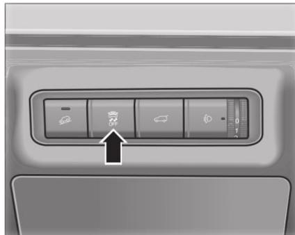
Каждый раз, когда вы запускаете двигатель, функция ESP включается автоматически.
