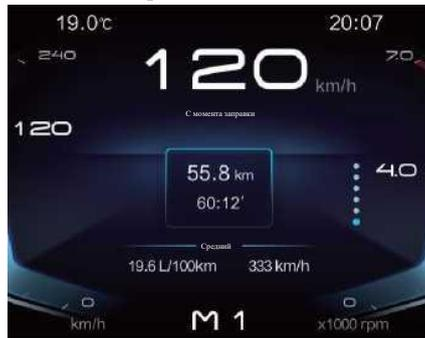
После заправки в интерфейсе отображается промежуточный пробег, средний расход топлива, время в пути и средняя скорость автомобиля с момента последней заправки.
