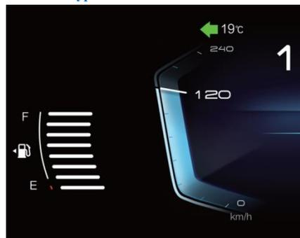
Указатель уровня топлива показывает количество топлива, оставшегося внутри топливного бака. При торможении, ускорении, прохождении поворотов или движении по холму топливо в топливном баке будет раскачиваться, что повлияет на точность отображения указателя уровня топлива, и автомобиль следует разместить на ровном дорожном покрытии, чтобы проверить количество топлива.
