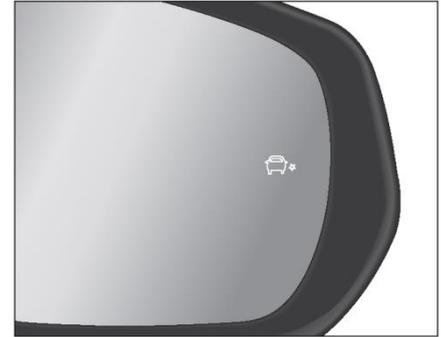
Когда DOW подает сигнал тревоги, светодиодные сигнальные лампы наружных зеркал мигают для визуального сигнала тревоги, а зуммер комбинации приборов подает звуковые подсказки.
