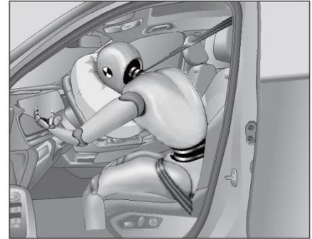
Когда транспортное средство сталкивается с серьезным столкновением, система подушек безопасности быстро открывает одну или несколько воздушных подушек, заполненных газом, между человеком и кузовом автомобиля, уменьшая ущерб от столкновения, понесенный водителем и пассажирами.
