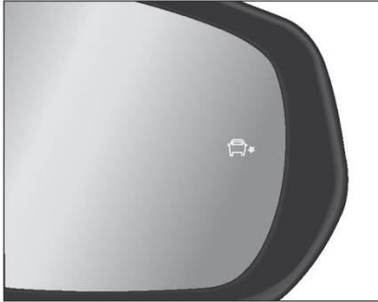
Когда система обнаруживает движущийся объект, включается только световая сигнализация внешнего зеркала заднего вида BSD alarm, визуальная сигнализация и звуковая сигнализация.
