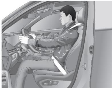
Правильное положение водителя в кресле снижает утомляемость водителя и обеспечивает безопасность управления автомобилем.
