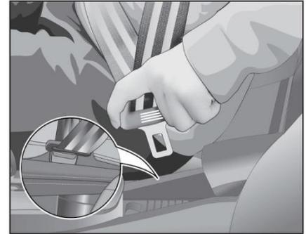
Нажмите красную кнопку на пряжке, чтобы разблокировать ремень безопасности. После разблокировки ремня безопасности нажмите на ремень безопасности соответствующим образом вверх в направлении точки фиксации, и ремень безопасности автоматически втянется во втягивающее устройство.
