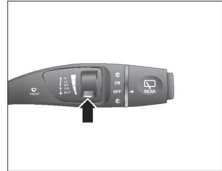
Рычаг регулировки интервального времени: переключите этот рычаг, отрегулируйте интервал очистки переднего стеклоочистителя. Интервал разделен на четыре уровня, с переключением вверх на самый высокий уровень 4 (самый короткий интервал) и переключением вниз переключите рычаг на самый низкий уровень 1 (самый длинный интервал), среднее положение - 3 уровня, за которым следуют 2 уровня. Отрегулируйте автоматическую скорость стеклоочистителя в соответствии с вашими привычками вождения.
