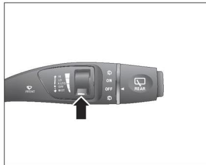
Чувствительность автоматического стеклоочистителя системы можно регулировать, вращая ручку автоматической регулировки чувствительности стеклоочистителя.
