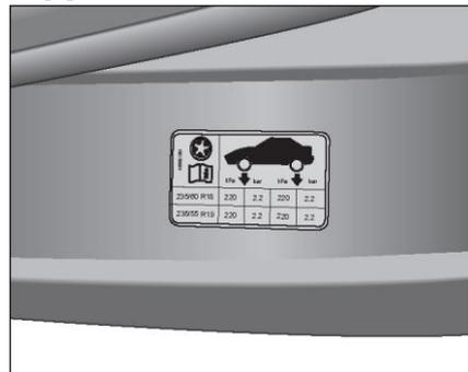
На левую заднюю стойку прикреплена бирка с информацией о шинах, которую можно увидеть, открыв левую заднюю дверь. Он должен быть накачан в соответствии с давлением в шинах, указанным над табличкой с данными.
