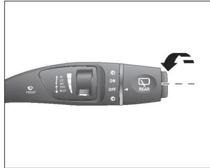
Переключатель ручки заднего стеклоочистителя: когда ручка заднего стеклоочистителя повернута в положение «ON», задний стеклоочиститель включается и выполняет действие протирки с определенной частотой; остановиться после перехода в положение «OFF».
