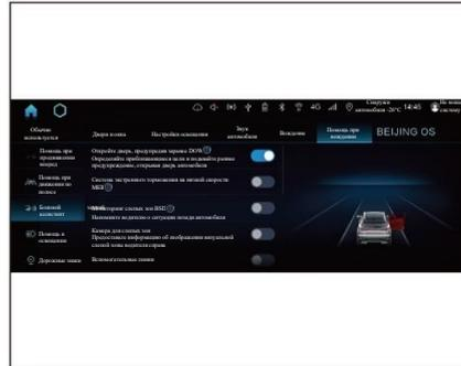
Пользователи могут выбрать включение/выключение функции предупреждения о закрытии двери с помощью центрального экрана управления.
