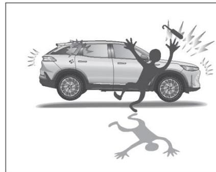
После блокировки автомобиля с помощью смарт-ключа все транспортное средство переходит в укрепленное состояние, а все двери, крышки моторного отсека и крышки багажника находятся в контролируемом состоянии. Если обнаружено, что дверь, крышка багажника или крышка моторного отсека открыты незаконно, например, если кто-то принудительно открывает дверь, срабатывает сигнализация.
