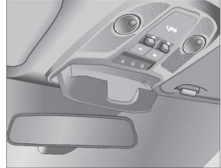
В закрытом состоянии нажмите на заднюю часть корпуса, чтобы автоматически извлечь. Нажимайте на корпус вверх, пока не услышите щелчок, чтобы закрыть корпус.
