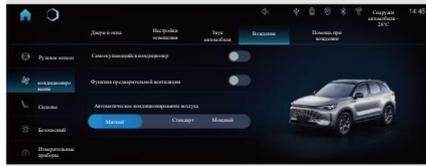
Функция предварительной вентиляции кондиционера может быть активирована через центральный экран управления. После активации функции используйте клавишу разблокировки смарт-ключа (сначала нажмите кнопку разблокировки, чтобы разблокировать автомобиль, затем нажмите и удерживайте кнопку разблокировки в течение 6 секунд), чтобы включить функцию. Когда дверь открыта, вентиляция будет активно останавливаться, если дверь не открыта, она автоматически остановится после проветривания на некоторое время.
