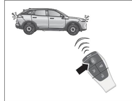
При закрытых дверях, крышках моторного отсека и крышках багажника нажмите кнопку блокировки
