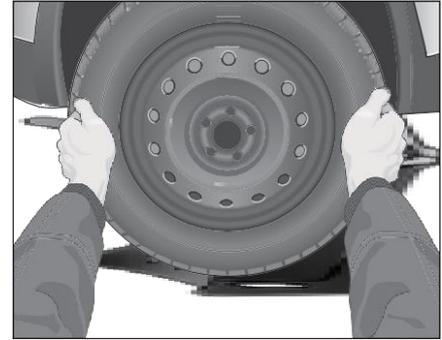
1. Совместите отверстие для крепления запасного колеса с монтажным отверстием на тормозном диске и наденьте его на ступицу колеса;
