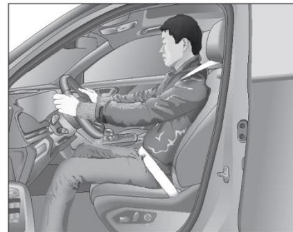
Перед использованием ремня безопасности переднее сиденье должно быть отрегулировано спереди и сзади, высота\* и наклон спинки в соответствующее положение.
