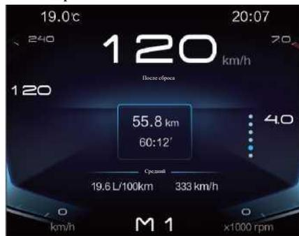
После сброса в интерфейсе отображаются четыре типа информации: промежуточный пробег, средний расход топлива, время в пути и средняя скорость автомобиля с момента последнего сброса.
