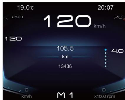
Интерфейс пробега отображает общий пробег автомобиля, а промежуточный пробег — это два вида информации.
