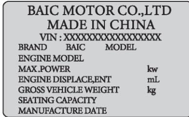
Табличка с продуктом автомобиля расположена на листовом металле задней стойки панели по периметру с правой стороны кузова и содержит основную информацию:
