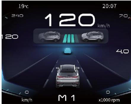
В активном состоянии ACC поверните ручку адаптивного круиз-контроля в положение «DIST+ передача» или «DIST- передача», чтобы отрегулировать расстояние во время круиза между автомобилем и впереди идущим транспортным средством. Временное расстояние устанавливается с 4 остановками.
