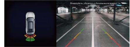
Когда автомобиль переходит на передачу «R», камера заднего вида перестает работать, и центральный экран управления возвращается к предыдущему интерфейсу отображения.
