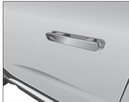
Ручка автоматически разворачивается, когда весь автомобиль разблокирован, и дверь можно открыть, потянув за наружную дверную ручку. Транспортное средство запирается, а при движении скрытая ручка автоматически убирается.
