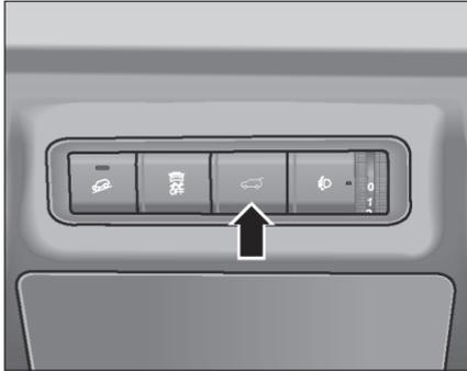
Переключатель открытия крышки багажника в помещении, расположенный на многофункциональной панели переключателей с левой стороны приборной панели. Нажмите переключатель открытия крышки багажника, чтобы автоматически открыть крышку багажника.
