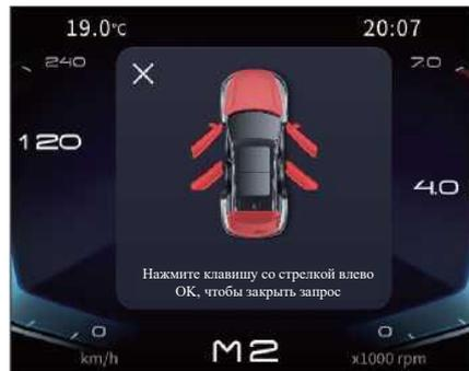
Дверь, крышка моторного отсека и крышка багажника не закрыты, а на дисплее бортового компьютера отображается соответствующая незакрытая дверь, крышка моторного отсека или крышка багажника.
