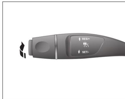
Когда функция круиз-контроля включена, переведите джойстик круиз-контроля на передачу ON/OFF (вертикальная плоскость рулевого колеса направлена наружу джойстика круиз-контроля) и выйдите из режима круиз-контроля. В это время зеленый индикатор круиз-контроля комбинированного
