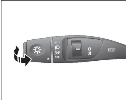
Потяните рычаг управления освещением к плоскости рулевого колеса, загорится дальний свет, рычаг управления светом автоматически отпружинит после отпускания, а дальний свет выключится, что используется для предупреждения транспортных средств и пешеходов впереди.
