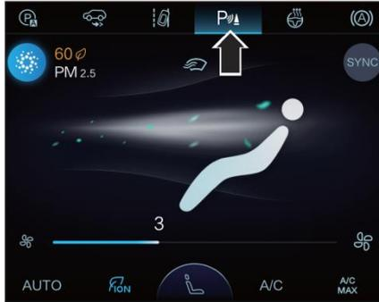
Когда кнопка start/stop находится в режиме «RUN», система помощи при парковке включена по умолчанию, а индикатор включения системы помощи при парковке горит. Система может работать только при скорости примерно менее 15 км/ч.
