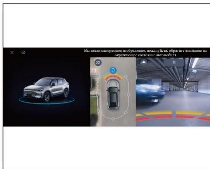
Когда система обнаруживает движущийся объект, в соответствующей области панорамного изображения отображается треугольник для подсказки.
