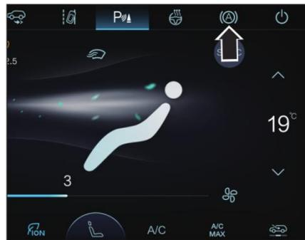
Функцию автоматической парковки можно включить/выключить с помощью переключателя автоматической парковки, расположенного на центральном экране управления.
