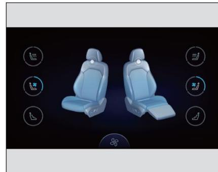
Кнопка вентиляции сидений расположена на экране управления автомобилем.
