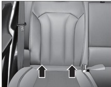
Нижнее фиксированное крепление якоря расположено в зазоре между спинкой сиденья и подушкой сиденья под логотипом «ISOFIX». Пожалуйста, следуйте инструкции по эксплуатации, предоставленной производителем детского кресла для установки.
