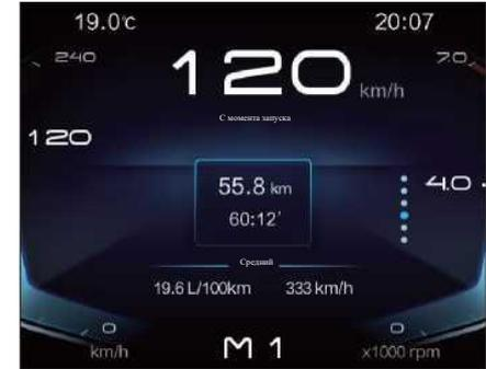
С момента запуска на экране отображаются четыре типа информации: пробег, средний расход топлива, время в пути и средняя скорость.
