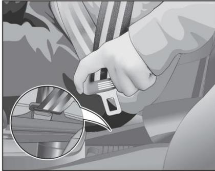
Медленно вытащите ремень из втягивающего устройства, затем вставьте ригель в пряжку, пока не услышите звук щелчка пряжки, а затем потяните ремень назад, чтобы подтвердить надежную фиксацию.
