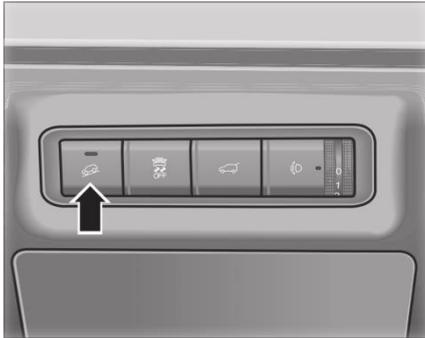
Когда скорость будет меньше или равна 35 км/ч, нажмите переключатель медленного спуска по крутому склону, и функция медленного спуска по крутому склону перейдет в режим ожидания. Горит контрольная лампа переключателя крутого наклона и медленного спуска, а также горит зеленая контрольная лампа
