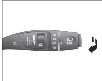
Когда кнопка «Старт/Стоп» находится в режиме «RUN», переключите рычаг стеклоочистителя в направлении рулевого колеса, мотор омывателя начинает работать, форсунки омывателя переднего лобового стекла распыляют воду, отпустите и распыление воды прекратится, передний стеклоочиститель продолжает протирать несколько раз, а затем автоматически останавливается.
