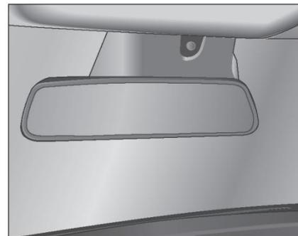
Ночью автоматическое внутреннее зеркало заднего вида с антибликовым покрытием автоматически регулирует глубину цвета внутреннего зеркала заднего вида в соответствии с интенсивностью заднего фонаря, чтобы уменьшить блики, вызванные задними фарами автомобиля, для глаз водителя.
