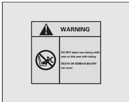
На солнцезащитном козырьке со стороны пассажира передней части автомобиля прикреплен предупреждающий знак, напоминающий о правильной установке детского кресла. Обязательно прочтите и следуйте инструкциям на этих знаках.
