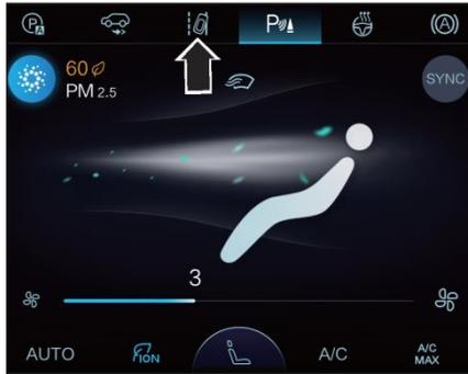
Переключатель помощи при движении по полосе расположен на всем экране управления автомобилем, и сенсорный переключатель может запускать или закрывать систему помощи при выезде с дороги. При включении системы загорается вспомогательный рабочий индикатор выезда с дороги комбинации
