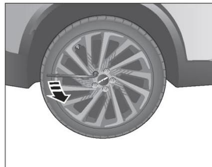
5. Снимите крышку колесной гайки с помощью инструмента для снятия крышки колесной гайки;
