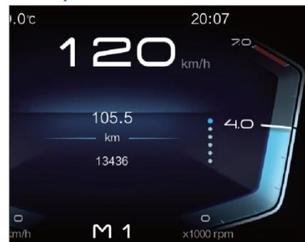
Тахометр показывает количество оборотов двигателя в минуту (x1000 об/мин). Тахометр также помогает оценить производительность двигателя.
