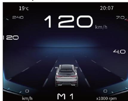
В интерфейсе «помощи при вождении» вы можете просматривать состояние ACC/LKS, отображать такую информацию, как крейсерское состояние автомобиля и соотношение взаимного положения целевого транспортного средства, а также отображать препятствия и помехи вокруг транспортного средства.
