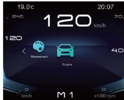
Когда кнопка запуска/остановки без ключа находится в режиме «RUN», в интерфейсе сервисного меню вы можете переключаться между сервисной информацией, нажимая кнопку **Δ** / **∇** кнопку, и информация, которую можно просмотреть, включает: Информация о неисправностях, контроль давления в шинах, пробег технического обслуживания, информация о версии.
