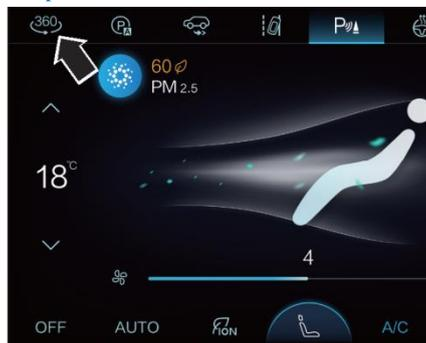
Экран управления автомобилем оснащен переключателем системы панорамного изображения, нажмите кнопку открытия, чтобы открыть систему панорамного изображения, а когда система включена, снова коснитесь кнопки открытия, чтобы выключить систему панорамного изображения.
