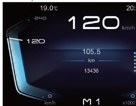
Спидометр показывает скорость автомобиля в режиме реального времени, измеряемую в км/ч.
