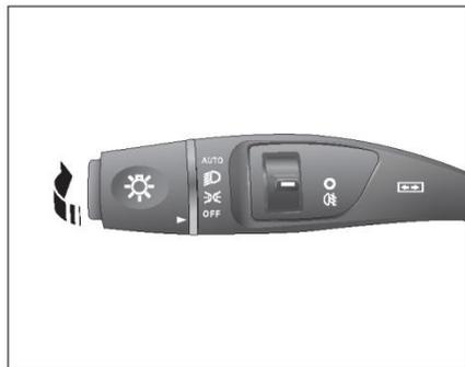
**i** Когда ближний свет включен, вертикальная плоскость рулевого колеса толкает рычаг управления освещением наружу, чтобы зажечь дальний свет, и снова тянет рычаг управления светом к плоскости рулевого колеса, чтобы выключить дальний свет.
