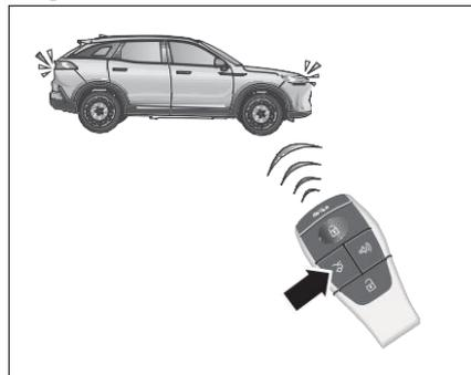
Дважды коротко нажмите клавишу на кнопке разблокировки крышки багажника
