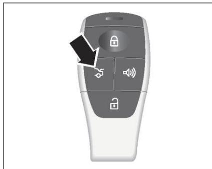
Просто дважды нажмите кнопку разблокировки крышки багажника на смарт-ключе, и вы сможете автоматически открыть крышку багажника.
