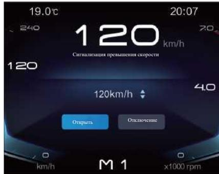
После входа в интерфейс настройки сигнализации превышения скорости короткое нажатие **◀** / **▶** кнопка может выбрать «включение» или «выключение» функции сигнализации превышения скорости. В интерфейсе «Открыть» короткое нажатие **△** / **▽** кнопка может настроить значение ограничения скорости сигнализации превышения скорости, короткое нажатие кнопки подтверждения, **OK** чтобы подтвердить текущий выбор, и вернуться к предыдущему интерфейсу после завершения подтверждения.
