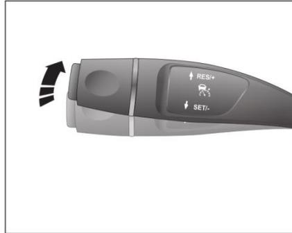
В режиме круиза с фиксированной скоростью переключите джойстик круиз-контроля с фиксированной скоростью на передачу RES /+, чтобы увеличить крейсерскую скорость:
