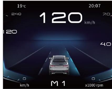
Распознавание линий полосы движения и состояние отображения системного интерфейса выглядит следующим образом:
