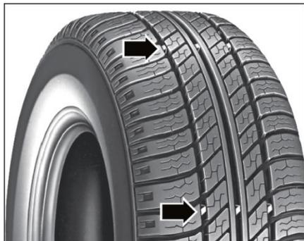
На оригинальных шинах есть следы износа, в нижней части рисунка протектора, распределенные по окружности шины. Если протектор изнашивается до отметки износа, шину следует заменить в это время.
