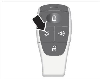
Дважды коротко нажмите кнопку разблокировки крышки багажника на смарт-ключе, и крышка багажника будет разблокирована. В это время коротко нажмите переключатель открытия на крышке багажника и потяните крышку багажника
