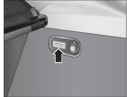
Когда крышка багажника открыта, индикатор багажника загорается автоматически, а после закрытия крышки багажника лампа автоматически выключается.
