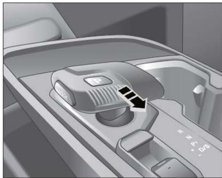
После переключения передачи на D нажмите селектор переключения передач назад, чтобы переключить режима в S. В это время коробка передач активирует режим движения автомобиля. Индикация положений комбинации приборов - S.
