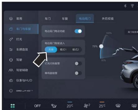
Через центральный экран управления можно включить/выключить функцию сенсорного открывания крышки багажника с электроприводом и настроить режим.
