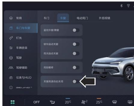
Функцию автоматического закрывания люка в крыше с высокой скоростью можно включать/выключать через центральный экран управления. Когда скорость автомобиля превысит 120 км/ч в первый раз после включения функции, люк в крыше автоматически закроется. В это время люк можно снова открыть, переместив выключатель люка в крыше назад.
