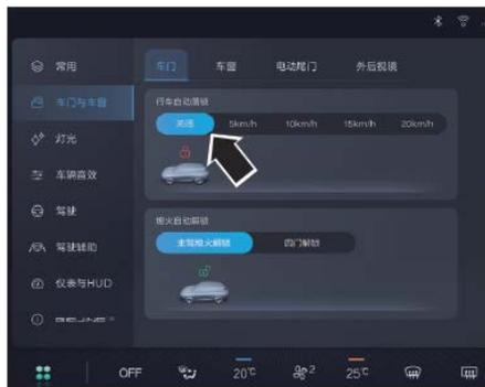
Когда скорость автомобиля во время движения превышает установленное значение, центральный замок дверей автоматически запирает все двери.
