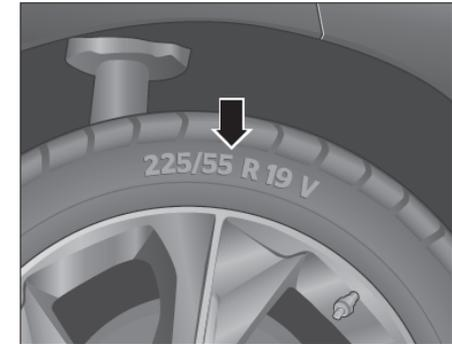
Проверьте информацию о шинах вашего автомобиля, чтобы узнать тип и размер шин, которые вам нужны.
