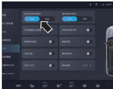
Эта модель оснащена стандартным и спортивным режимами рулевого управления. Водитель может выбрать режим рулевого управления в соответствии со своими потребностями. Режим электронного рулевого управления можно выбрать на центральном экране управления.
