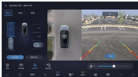
Экран центрального управления оснащен переключателем системы полностью автоматической парковки (АРА)
