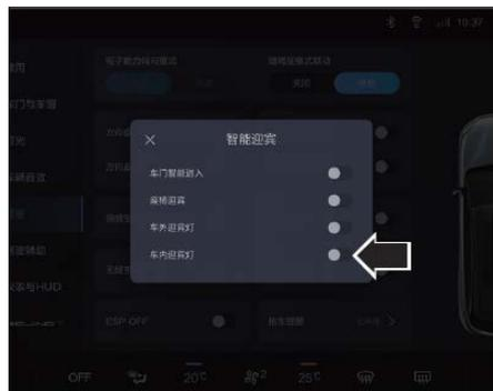
Функцию внутреннего приветственного света можно включать/выключать с помощью центрального экрана управления.
