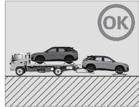
Отпустите электронный стояночный тормоз на неисправном автомобиле, поднимите и зафиксируйте задние колеса, а передние колеса закрепите на малых подкатных тележках.
