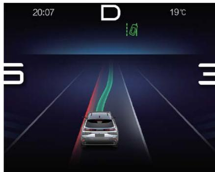
Отображенное состояние распознавания линий полосы движения и интерфейс системы выглядит следующим образом:
