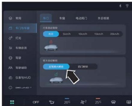
Установите кнопку запуска/остановки в режим «OFF», и центральный замок может быть автоматически разблокирован. В автомобилях, оснащенных сенсорными скрытыми ручками, ручки развертываются автоматически.
