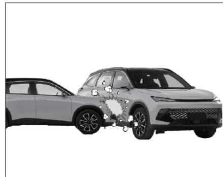
При боковом столкновении водитель и пассажир получают боковое смещение, поэтому подушка безопасности, раскрытая спереди, не защитит водителя и пассажира. В это время подушка безопасности может не развернуться, а боковая подушка безопасности и боковая шторная подушка безопасности могут сработать.
