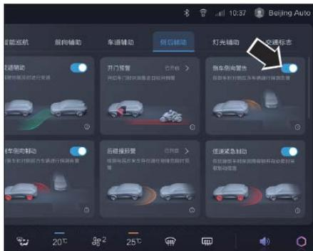
Пользователь может включить/выключить функцию предупреждения о боковом столкновении при движении задним ходом на центральном экране управления.
