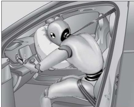
В случае серьезного столкновения система подушек безопасности быстро раскроет одну или несколько газонаполненных воздушных подушек между людьми и кузовом автомобиля, чтобы уменьшить травмы водителей и пассажиров при столкновении.
