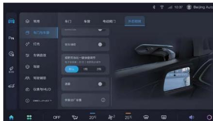
Через центральный экран управления вы можете установить быструю регулировки соотношения обзорности между небом и землей одной кнопкой, по умолчанию используется (2:8), 1-я передача (4:6), 2-я передача (5:5).
