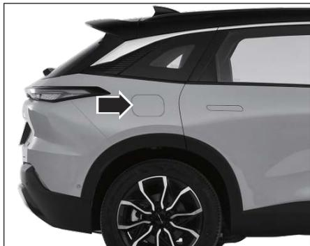
При полностью разблокированном автомобиле, нажмите на заднюю часть лючка топливного бака, чтобы открыть его.
