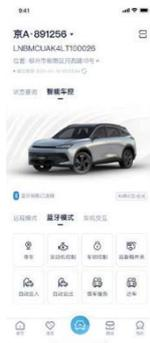
Bluetooth-ключ смартфона может заменить смарт-ключ. Нажимая соответствующие кнопки Bluetooth-ключа, реализуются такие функции, как: функция закрытия и открытия окон автомобиля, разблокировки и блокировки автомобиля, открытия багажника, поиска автомобиля. Беря смартфон с собой при посадке автомобиль, нажмите на педаль тормоза, а затем на кнопку запуска/остановки, чтобы завести автомобиль.
