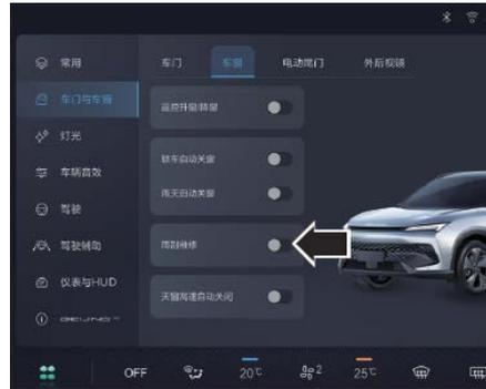
Когда режим источника питания автомобиля установлен на «RUN», а переключатель стеклоочистителя выключен, режим «техническое обслуживание стеклоочистителя» можно включить/выключить на центральном экране управления, и стеклоочиститель автоматически перейдет в положение обслуживания.
