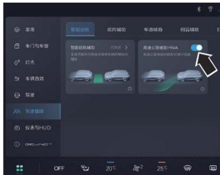
Функцию помощи при движении по скоростной автотрассе можно включать/выключать на центральном экране управления.
