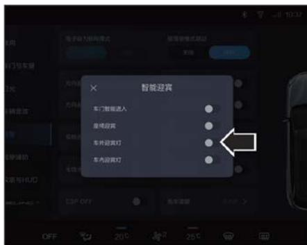
Внешний приветственный свет можно включать/выключать через центральный экран управления. После его включения войдите в сенсорную зону автомобиля, имея с собой смарт-ключ, и свет включится.
