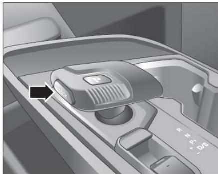
Кнопка разблокировки рукоятки переключения передач расположена на левой стороне селектора переключения передач, чтобы избежать случайного переключения передач на R/D и случайного переключения с P на другие передачи. Чтобы разблокировать селектор переключения передач, нажмите кнопку разблокировки.
