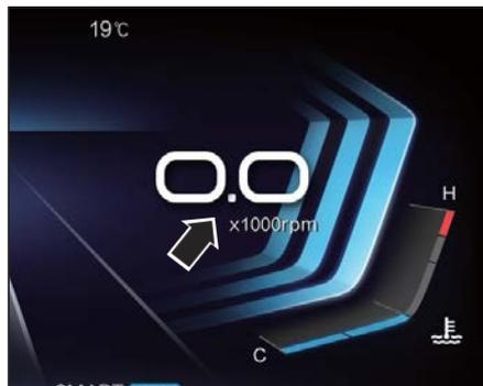
Тахометр показывает количество оборотов двигателя в минуту (x1000 об/мин). Тахометр также помогает в оценке работы двигателя.
