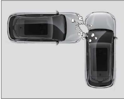
При ударе на сторону, отличную от пассажирского салона слегка ударяется кузов автомобиля, а подушка безопасности, боковая подушка безопасности и боковая шторная подушка безопасности не срабатывают.
