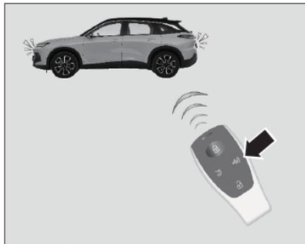
Когда автомобиль заперт и расстояние до автомобиля <15 м (в открытом поле), нажмите кнопку поиска автомобиля на смарт-ключе
