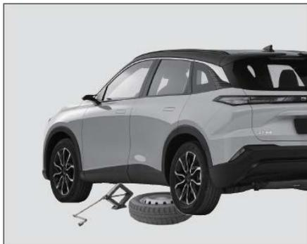
3. Поверните коромысло домкрата так, чтобы выемка головки домкрата зацепилась за точку опоры кузова автомобиля, но не поддомкрачивайте автомобиль;
