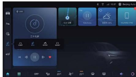
Кнопка запуска/остановки без ключа находится в режиме «RUN», режим вождения можно выбрать на экране центрального управления.
