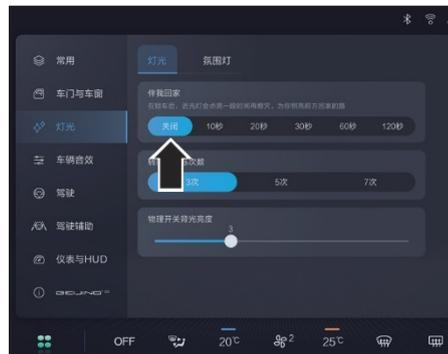
Функция «Сопроводить меня домой» может предоставлять пользователям услуги задержки освещения. На центральном экране управления вы можете включить/выключить функцию «Сопроводить меня домой» и выбрать время задержки.
