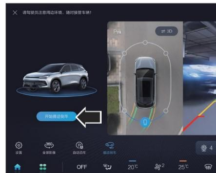
Когда скорость автомобиля ниже 30 км/ч, функция при движении задним ходом по следам автоматически запоминает маршрут движения в фоновом режиме, пользователь также может нажать кнопку, чтобы войти в интерфейс для движения задним ходом по следам для запоминания маршрута, когда автомобиль останавливается, пользователь нажимает кнопку запуска при движении задним ходом по следам, система будет управлять автомобилем, чтобы следовать по оригинальному маршруту для
