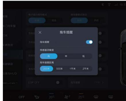
С помощью центрального экрана управления вы можете включить / выключить функцию напоминания о буксировке, установить чувствительность датчика угла (высокую, среднюю и низкую) и установить расстояние напоминания о буксировке (200 метров, 500 метров, 1 километр, 2 километра).
