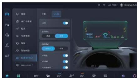
Включите / выключите отображение HUD через центральный экран управления и выберите режим отображения HUD (нормальный режим и режим дождя и снега); Выберите отображение функции HUD (пользовательский режим и минималистский режим), где в пользовательском режиме можно выбрать отображение 2D-навигации, AR-навигации, 2D-помощи вождения и AR-помощи, а в минималистском режиме отображаются только 2D-значки скорости и круиза; Выберите ручную или автоматическую настройку высоты и яркости дисплея HUD.
