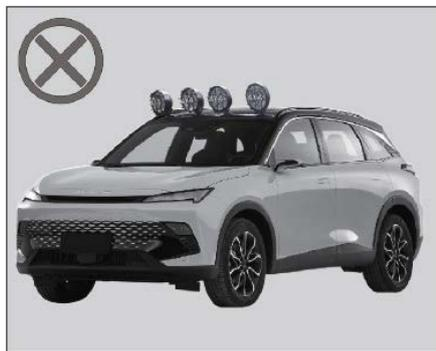
Добавление приборов большой мощности, отличной от номинальной, может привести к нагреву и короткому замыканию в жгуте проводов из-за чрезмерной нагрузки, что может стать причиной пожара.
