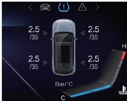
Информация о шинах показывает давление и температуру в шинах. В нормальных условиях информация о давлении в шинах на комбинации приборов отображается белым цветом. Когда давление в шинах не соответствует норме, на комбинации приборов загорается предупреждающий индикатор и предупреждения о давлении в шинах в сопровождении звукового сигнала, а информация о давлении в неисправной шине отображается красным цветом на комбинации приборов.
