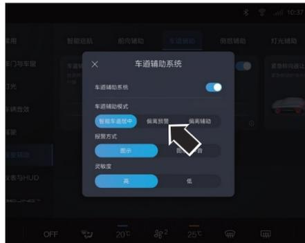
Пользователь может включить/выключить функцию предупреждения о выезде из полосы движения на центральном экране управления, а также выбрать режим и чувствительность сигнала тревоги. Когда система включена, горит индикатор работы системы предупреждения о сходе с полосы движения на комбинации приборов
