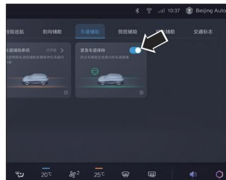
Пользователи могут включать/выключать функцию аварийного удержания полосы движения на центральном экране управления.
