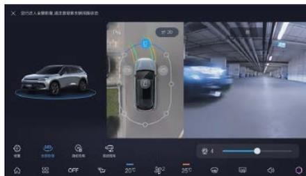
Когда система запущена и передача не R, экран системы по умолчанию — это вид спереди + панорама, и его можно переключить на другие виды с помощью положения шестерни, сигнала поворота или операции с сенсорным экраном.
