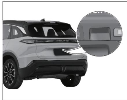
Когда автомобиль разблокирован или вы носите с собой смарт-ключ, нажмите ручку открывания на крышке багажника, автоматически открывается крышка багажника.
