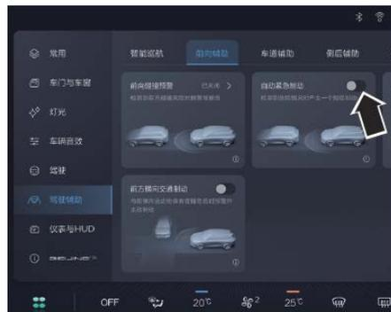
Пользователи могут включать/выключать функцию автоматического экстренного торможения на центральном экране управления.
