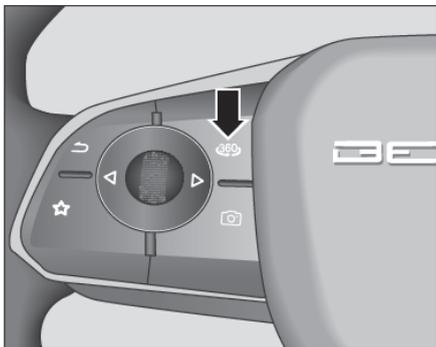
Переключатель системы панорамных изображений установлен на кнопке рулевого колеса **360**, нажмите кнопку переключателя, чтобы включить систему панорамных изображений, а когда система включена, снова нажмите кнопку переключателя на рулевом колесе или непосредственно нажмите кнопку закрытия X, чтобы выключить систему панорамных изображений.
