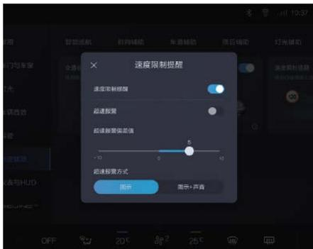
Пользователи могут включать/выключать функцию распознавания знаков ограничения скорости на центральном экране управления, а также устанавливать значение отклонения и метод подачи сигнала тревоги.
