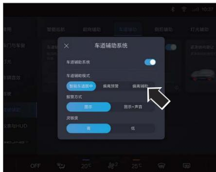
Пользователь может включить/выключить функцию предупреждения о выезде из полосы движения с возвратом в занимаемую полосу на центральном экране управления, а также выбрать режим и чувствительность сигнала тревоги. Когда система включена, горит индикатор работы системы помощи при выезде с дороги на комбинации приборов **101**.
