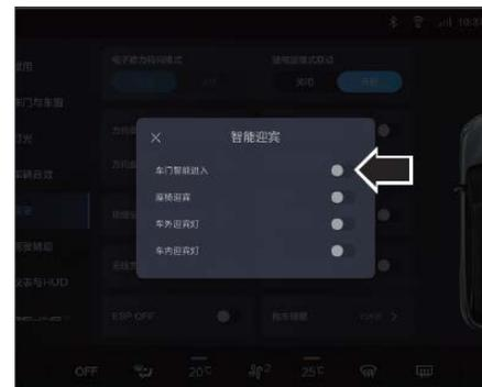
Функцию интеллектуального открывания можно включать/выключать через центральный экран управления. После включения, когда автомобиль заперт, имея при себе смарт-ключ, войдите в зону распознавания на расстоянии около 2-1,5 метров от ручки передней двери автомобиля, скрытая ручка автоматически раскладывается\* и дверной замок разблокируется.
