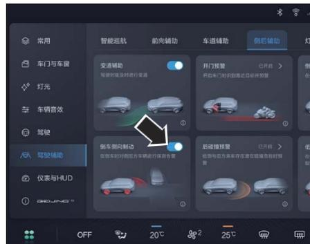
Пользователь может включать/выключать функцию торможения для предотвращения бокового столкновения при движении задним ходом на центральном экране управления.
