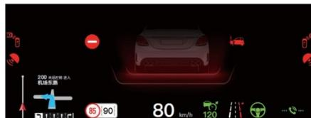
Контент, отображаемый на верхнем дисплее дополненной реальности (HUD), включает в себя: основную информацию, информацию ADAS, информацию о двухмерной навигации, информацию о телефоне и информацию о навигации с дополненной реальностью.
