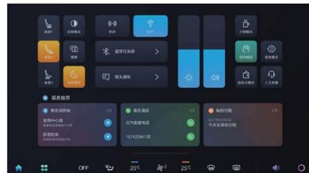
После регулировки положения сиденья нажмите и удерживайте положение на сиденье 1, 2 или 3 на служебном экране центрального экрана управления (сдвиньте вниз от верхней части экрана, чтобы открыть служебный экран, и сдвиньте вверх, чтобы его закрыть) для памяти положения.
