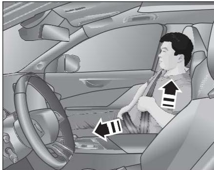
Слегка потяните за РБ, чтобы отрегулировать длину РБ. Пожалуйста, отрегулируйте его до удобного положения.
