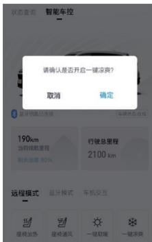
Кондиционер, функция подогрева/вентиляции основного сиденья, функция отопления/охлаждения одной кнопкой и другие функции можно включать дистанционно через приложение для смартфона.
