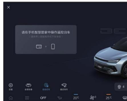
5. Пользователь включает Bluetooth мобильного телефона и приложение «BAIC». Когда Bluetooth смартфона успешно подключен к автомобилю, он автоматически перейдет к интерфейсу парковки дистанционного управления. После того, как пользователь действует в соответствии с подсказкой приложения и долго нажимает кнопку «Начать парковку», функция дистанционной парковки с помощью мобильного телефона будет активирована.
