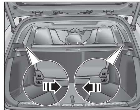
Возьмитесь с двух сторон за шторку багажника и сожмите ее в направлении стрелки, и затем снимите шторку багажника, чтобы увеличить объем багажника.
