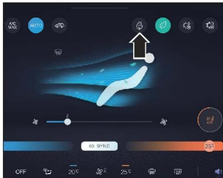
Кнопка подогрева рулевого колеса расположена на центральном экране управления.
