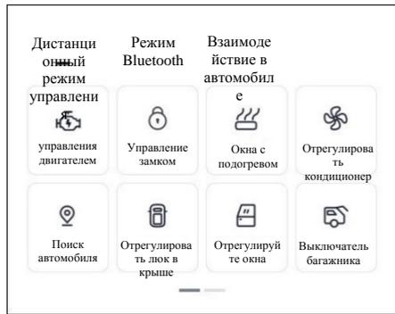
Приложение смартфона может заменить смарт-ключ, и вы можете реализовать такие функции, как стеклоподъемники, разблокирование и блокирование автомобиля, открытие багажника и поиск автомобиля, нажав кнопку в приложении смартфона, соответствующую выбранному режиму.
