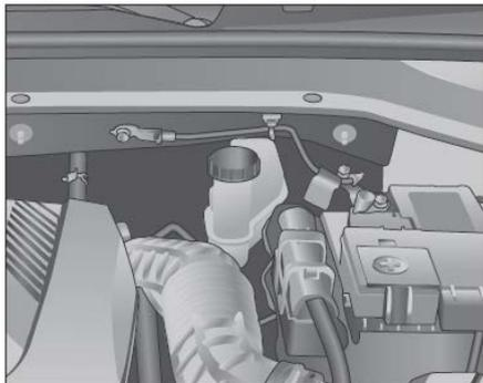
Обратите внимание на линию отметки на бачке тормозной жидкости.
