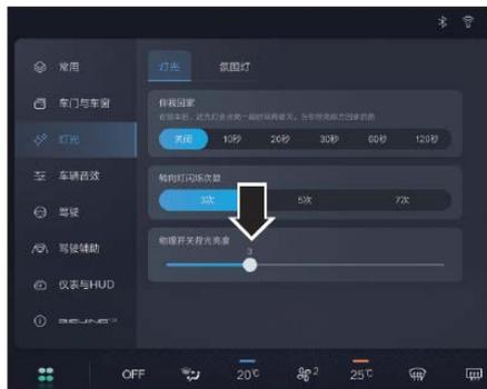
Когда габаритный свет включен, яркость подсветки физических элементов управления можно регулировать с помощью центрального экрана управления.
