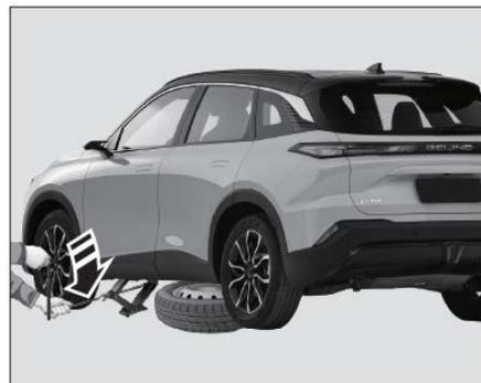
7. Вращайте рукоятку домкрата по часовой стрелке, чтобы поднять автомобиль, пока неисправное колесо не оторвется от земли;
