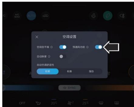
Функцию предварительной вентиляции можно активировать через центральный экран управления. После активации функции нажмите кнопку разблокировки на дистанционном ключе управления (коротко нажмите кнопку разблокировки, чтобы разблокировать автомобиль, затем долго нажмите и удерживайте кнопку
