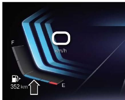
Указатель уровня топлива показывает количество топлива, оставшегося в топливном баке и остаточный пробег.
