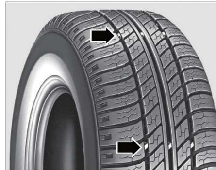
На оригинальных шинах имеется маркировка износа протектора в нижней части рисунка протектора, распределенные по окружности шины. Если протектор изнашивается до маркировки износа, шину следует заменить.
