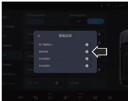
Когда автомобиль заглушен, дверь со стороны водителя открыта, сиденье водителя отодвигается назад, облегчая водителю посадку и высадку из автомобиля. Когда кнопка запуска/остановки находится в режиме «RUN» или, когда автомобиль заблокирован, сиденье автоматически возвращается в положение для вождения. Данную функцию можно включить или отключить, войдя в интерфейс настройки интеллектуального приветствия в меню «Движение» интерфейса настройки автомобиля на центральном экране управления.
