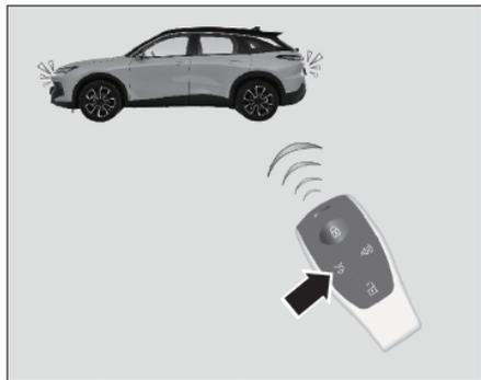
Дважды коротко нажмите кнопку разблокировки крышки багажника на ключе
