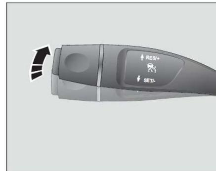
Когда функция круиз-контроля с фиксированной скоростью включена, нажмите рычаг управления вперед, чтобы выйти из круиз-контроля с фиксированной скоростью. В это время зеленый крейсерский индикатор XXX комбинированного прибора не горит
