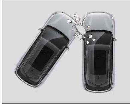
В случае косого столкновения энергия удара, полученная системой подушек безопасности, может оказаться недостаточной для разворачивания подушки безопасности. В это время подушка безопасности может не развернуться, а боковая подушка безопасности и боковая шторная подушка безопасности могут не сработать.
