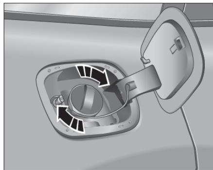
При заливке топлива медленно откручивайте крышку топливного бака против часовой стрелки. Прежде чем полностью выкрутить его, застопорите на некоторое время крышку топливного бака у горловины топливного бака, чтобы сбросить внутреннее давление, а затем снимите крышку топливного бака и вставьте ее в зажим.
