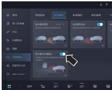
Пользователь может включать/выключать функцию торможения для предотвращения бокового столкновения на центральном экране управления.
