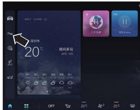
Когда кнопка пуска/остановки находится в режиме «RUN», парковочная радарная система включена по умолчанию, а индикатор переключателя парковочной радарной системы горит. Диапазон рабочей скорости функции парковочной радарной системы составляет 0 ~ 15 км/ч.
