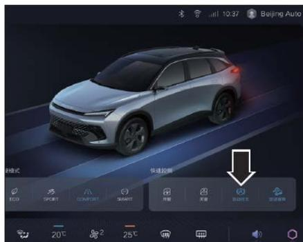
Функцию Automotive Vehicle Hold можно включать и выключать с помощью переключателя Automotive Vehicle Hold
