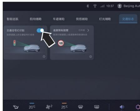
Пользователи могут включать/выключать функцию распознавания светофора на центральном экране управления.
