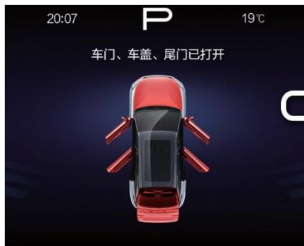
Если дверь, крышка капота и крышка багажника не закрыты, на электронном блоке управления будет отображаться соответствующая информация красным цветом для соответствующей незакрытой двери, крышка отсека или крышки багажника.
