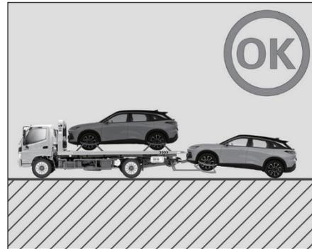
Отпустите электрический стояночный тормоз неисправного автомобиля, поднимите и зафиксируйте передние колеса.
