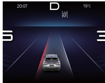
Отображенное состояние распознавания линий полосы движения и интерфейс системы выглядит следующим образом:
