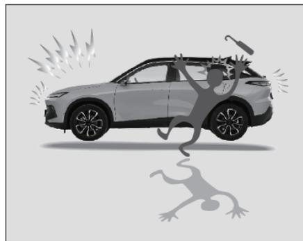
После того, как автомобиль был заблокирован с помощью смарт-ключа, автомобиль переходит в состояние защиты, а все двери, капот и крышка багажника находятся под контролем. Если обнаруживается, что дверь, крышка багажника или капот открыты незаконно, например, кто-то силой открывает дверь, сработает сигнализация.
