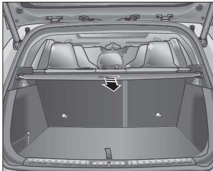
Вытяните шторку багажника в направлении, указанном стрелкой, и зафиксируйте её в крепёжных пазах декоративной накладки стоки С, чтобы скрыть содержимое багажника.
