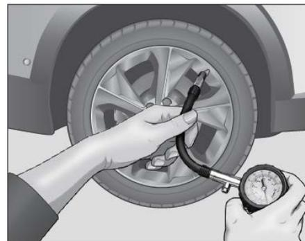
1. Отвинтите колпачок воздушного вентиля против часовой стрелки с воздушного вентиля шины и проверьте воздушный вентиль на утечку воздуха с помощью мыльного раствора;
