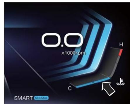
Этот прибор показывает температуру охлаждающей жидкости двигателя. Во время обычного движения синяя полоса индикатора должна находиться в среднем положении и вблизи него.
