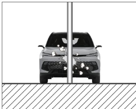
Если автомобиль сталкивается с тонкими предметами, такими как столбы или деревья, точки столкновения концентрируются в одном месте, и энергия удара быстро поглощается из-за сильной деформации автомобиля, что приводит к тому, что полная сила удара не передается на датчик подушки безопасности, поэтому подушка безопасности может не раскрыться.
