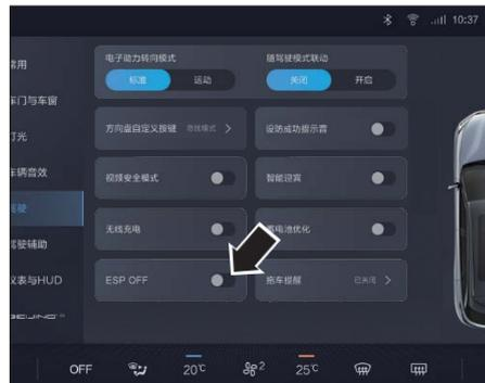
Функцию ESP OFF можно включать и выключать на экране центрального управления, а индикатор отключения ESP на комбинации приборов загорается, когда функция ESP OFF
