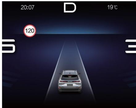
При обнаружении знака ограничения скорости, классифицированного по типу автомобиля, TSR отображает значение ограничения скорости малогабаритного автомобиля, а при обнаружении знака
