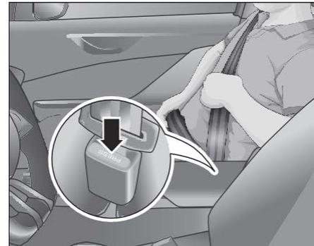
Нажмите красную кнопку на замке ремня, чтобы отстегнуть РБ. После отстёгивания РБ протолкните РБ вверх до фиксированной точки, и он автоматически втянется.
