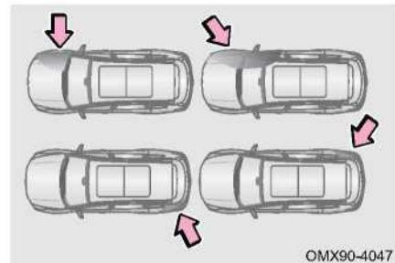
Боковая подушка безопасности переднего сиденья и шторка безопасности могут не сработать, если автомобиль подвергся боковому столкновению, удару задней частью заднего колеса или боковому столкновению под определенным углом к кузову.
