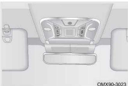
Интенсивность света автомобиля сзади определяется датчиком на зеркале заднего вида и автоматически уменьшает отражение. Не прикасайтесь к датчику и не накрывайте его, чтобы убедиться, что он работает правильно.
