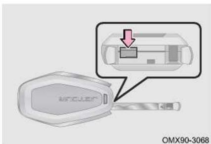
Шаг 2: Вставьте механический ключ в отверстие для смарт-ключа (как показано на рисунке) и аккуратно снимите крышку смарт-ключа.
