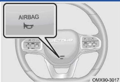
Чтобы подать звуковой сигнал, нажмите на область возле значка звукового сигнала на рулевом колесе.
