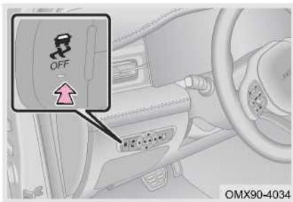
Питание автомобиля переключается в режим ON, нажмите выключатель ESP OFF, загорается индикатор выключателя и ESP выключается; Нажмите переключатель еще раз, индикатор погаснет, и ESP включится.
