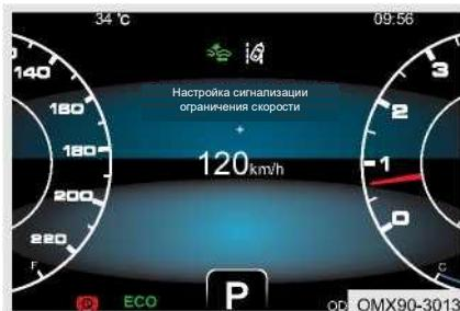
Шаг 1: На экране настроек сдвиньте сенсорную кнопку «□» на рулевом колесе вверх и вниз, чтобы перейти к сигналу превышения скорости.
