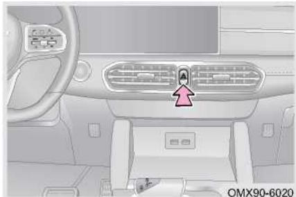
Нажмите выключатель аварийной сигнализации, одновременно замигают указатели поворота и индикатор указателей поворота на приборной панели; Нажмите еще раз, указатели поворота и индикатор погаснут.
