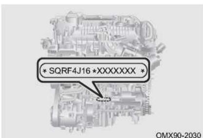
Номер двигателя указан на блоке цилиндров.
