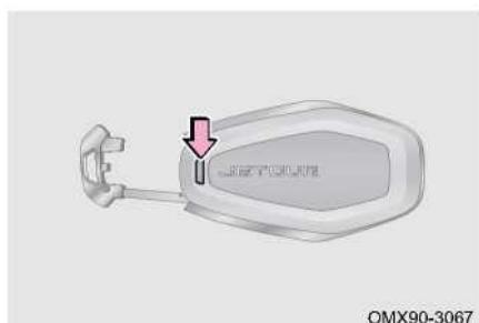
Механический ключ, встроенный в смарт-ключ, можно использовать для отпирания/запирания дверей после нажатия кнопки разблокировки и извлечения механического ключа. После использования верните его в смарт-ключ (подробности см. в разделе «Дверь»).
