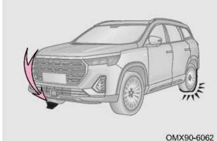
Шаг 1: Поместите блок под шину по диагонали напротив спущенной шины, чтобы предотвратить скатывание автомобиля.
