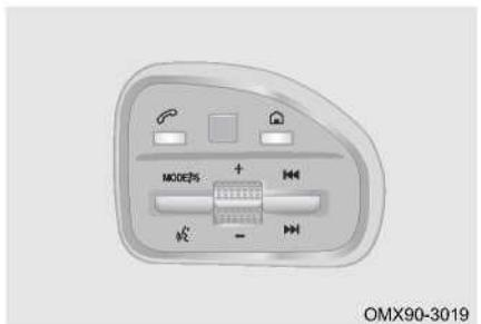
📞 : при подключенном Bluetooth короткое нажатие отвечает на звонок/повесит трубку; Без подключения Bluetooth выполните короткое нажатие для входа в экран соответствия Bluetooth; Нажмите и удерживайте, чтобы воспроизвести или переключиться в режим громкой связи/приватный режим.
