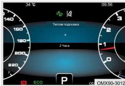
Шаг 1: На экране настроек сдвиньте сенсорную кнопку «□» на рулевом колесе вверх и вниз, чтобы перейти к теплым напоминаниям.
