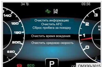
Шаг 1: На экране настроек сдвиньте сенсорную кнопку «□» на рулевом колесе вверх и вниз, чтобы перейти к очистке информации.
