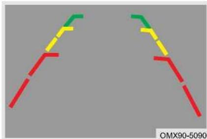
Переведите рычаг переключения передач в положение R, чтобы открыть экран RVC, и на экране отобразятся монитор обзора парковки и направляющие полосы движения. Указатель полосы движения зависит от поворота рулевого колеса и используется для предварительной оценки траектории движения задним ходом.
