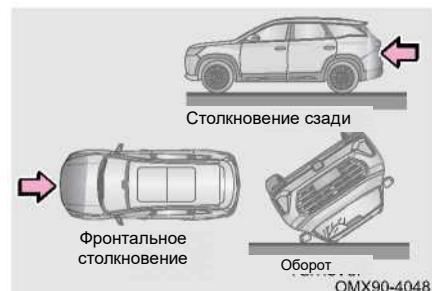
Передняя боковая подушка безопасности и шторка безопасности могут не раскрыться, если автомобиль подвергся фронтальному или заднему столкновению, опрокидыванию или боковому столкновению на низкой скорости.
