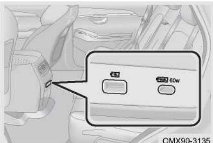
Задний порт USB расположен под задним воздуховодом. Он может обеспечить функцию зарядки для внешних USB-устройств. Интерфейс типа А слева, максимальная мощность 10 Вт.
