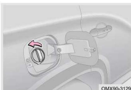
Шаг 2: Медленно поверните крышку топливного бака против часовой стрелки, чтобы снять её.
