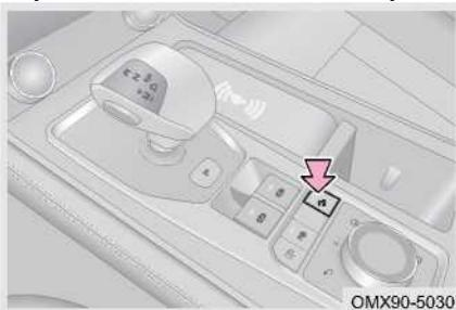
Переключатель системы спуска с холма расположен на вспомогательной фасционной консоли.
