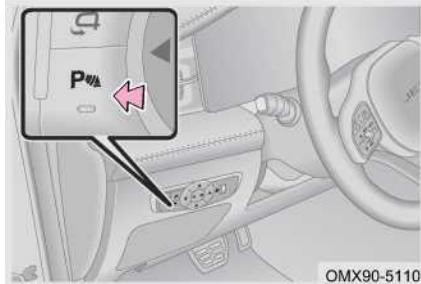
При нажатии выключателя парковочного радара загорается индикатор выключателя парковочного радара, включается передний радар. Нажмите еще раз, индикатор погаснет, передний радар отключится.
