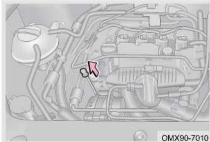
При выключенном и остывшем двигателе проверьте уровень масла с помощью щупа.
