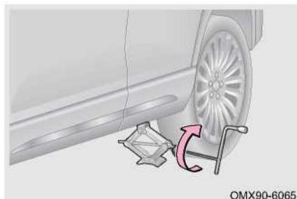
Шаг 4: Вставьте коромысло домкрата в домкрат и ключ для колесных болтов в коромысло домкрата, поверните по часовой стрелке. Поднимите автомобиль так, чтобы колеса немного оторвались от земли.
