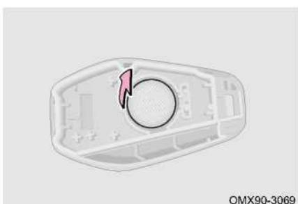
Шаг 3. С помощью отвертки, обмотав наконечник защитной лентой, извлеките аккумулятор, а затем установите новый аккумулятор.
