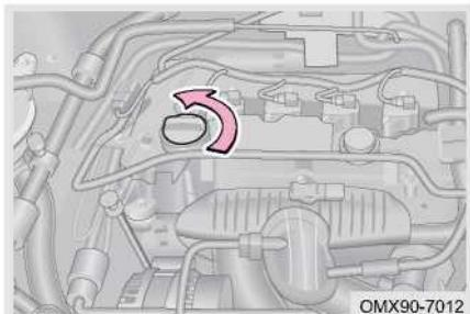
Шаг 1: Поверните крышку маслозаливной горловины против часовой стрелки, чтобы снять её.
