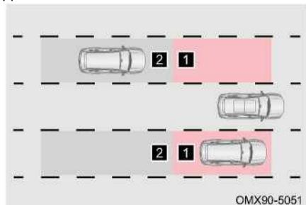
Когда рычаг переключения передач находится в положении D и скорость автомобиля составляет 15 km/h или выше при включенной системе, включается система предупреждения об обнаружении слепых зон.
