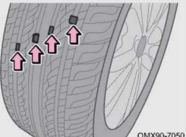
Проверьте протектор шины по следу износа. Когда износ протектора достигает своего предела, протектор будет находиться в той же плоскости, что и полоса износа. Если возникает такое состояние, это указывает на то, что производительность и безопасность шины серьезно снижаются, и необходима ее замена.
