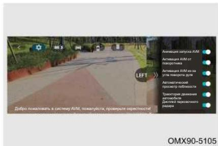
На экране настроек можно включить/выключить начальный экран панорамного обзора, активировать монитор панорамного обзора с помощью указателя поворота, активировать угол поворота рулевого колеса, автоматическое масштабирование, отображение направляющих полос, отображение парковочного радара и т. д.
