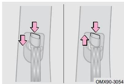
Регулировка вниз: Нажмите регулятор ремня безопасности вниз, одновременно нажимая кнопку регулировки.
