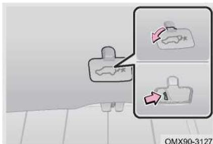
Задняя дверь не может быть открыта, когда батарея разряжена или в подобных условиях. В этом случае заднюю дверь можно открыть с помощью аварийного выключателя задней двери (остановите автомобиль как можно плавнее).
