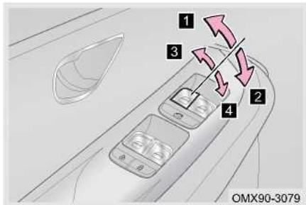
Включите выключатель стеклоподъемника после переключения питания автомобиля в режим ON:
