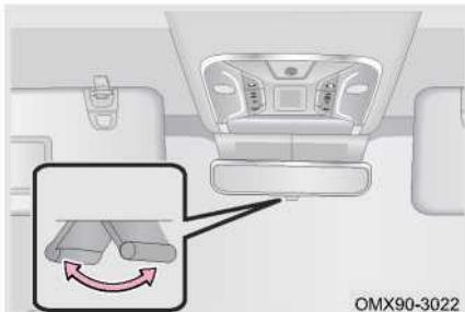
При необходимости функцию защиты от бликов можно включить или выключить с помощью регулировочного рычага.
