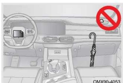
Ничего не прикрепляйте или прислоняйте к таким областям, как приборная панель, рулевое колесо и нижняя часть приборной панели. Эти предметы могут стать снарядами при срабатывании подушки безопасности водителя или переднего пассажира.
