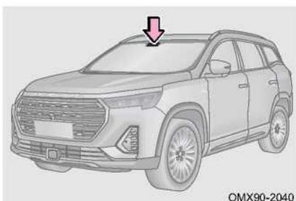
Микроволновое окно расположено с правой стороны на задней стороне лобового стекла внутри зеркала заднего вида, где оно предназначено для беспроводной передачи радиочастотного сигнала и установки автомобильной электронной идентификации.
