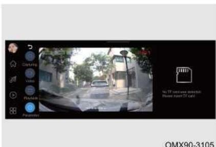
Когда скорость автомобиля превышает 5 km/h, регистратор вождения запускается автоматически. Функция записи вождения автоматически останавливается после выключения двигателя в течение 1 минуты.
