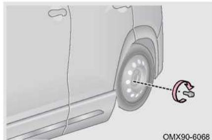
Шаг 2: Установите запасное колесо и слегка затяните вручную каждый колесный болт примерно на одинаковую ширину.
