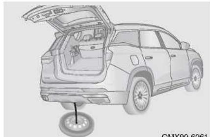
Шаг 4: Опустите стальной трос подъемного механизма запасного колеса. Снимите опорную пластину на конце подъемного механизма и запасное колесо, когда запасное колесо коснется земли.
