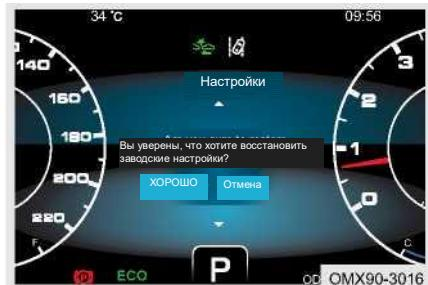
Шаг 1: На экране настроек сдвиньте сенсорную кнопку «□» на рулевом колесе вверх и вниз, чтобы перейти к сбросу настроек по умолчанию.
