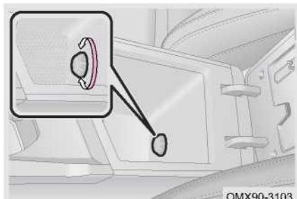
Вспомогательный подлокотник консоли фризовой панели оснащен выходом для холода. Поместите необходимые предметы (например, напитки в банках) в ящик подлокотника дополнительной приборной панели. Кондиционер включает режим для лица для охлаждения. Поверните коробку подлокотника внутри ручки против часовой стрелки, чтобы охладить необходимые предметы.
