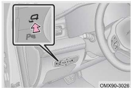
Работа с помощью переключателя: когда питание автомобиля включено, нажмите переключатель складывания на левом боковом переключателе приборной панели, чтобы автоматически сложить наружное зеркало заднего вида; Нажмите переключатель еще раз, чтобы зеркала выдвинулись автоматически. Управление с помощью ключа: в режиме усиления/деактивации наружное зеркало заднего вида автоматически складывается/выдвигается.
