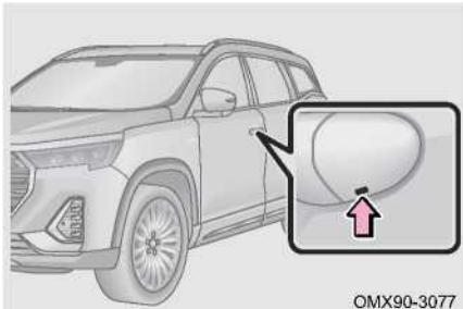
Шаг 1: Вставьте механический ключ в рабочее отверстие и подденьте переднюю декоративную крышку.
