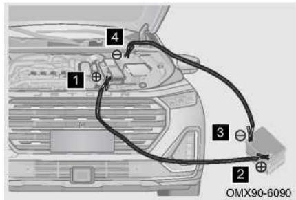
Шаг 2: Подсоедините соединительные кабели в соответствии со следующими шагами (для автомобилей с облицовкой моторного отсека сначала необходимо снять защитную крышку аккумуляторной батареи):
