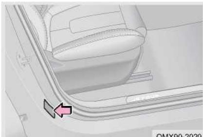
Как показано на рисунке, заводская табличка производителя расположена на правой четверти внешней панели. Модель автомобиля и идентификационный номер автомобиля указаны на заводской табличке производителя.
