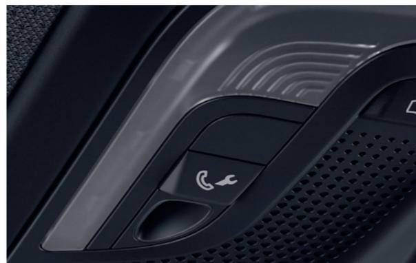
Помощь при поломке по нажатию кнопки: при нажатии кнопки вызова аварийной службы или записи в телефонной книге неисправный автомобиль автоматически устанавливает голосовую связь с центром поддержки клиентов (CAC).
