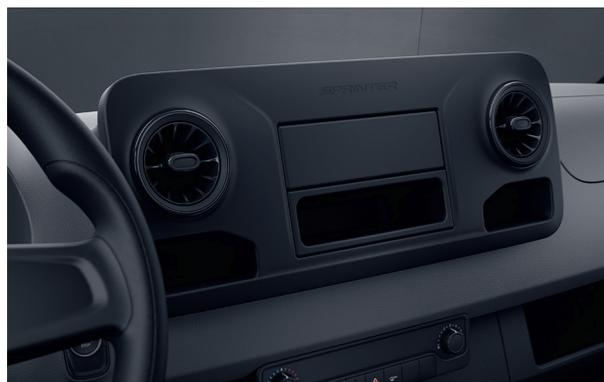
Подготовка для установки аудиосистемы позволяет в дальнейшем легко и быстро установить подходящий приемник в нишу размером 1-DIN в центральной консоли. После установки радиоприемника под ним остается отделение размером 1-DIN, которое можно использовать для хранения вещей.
