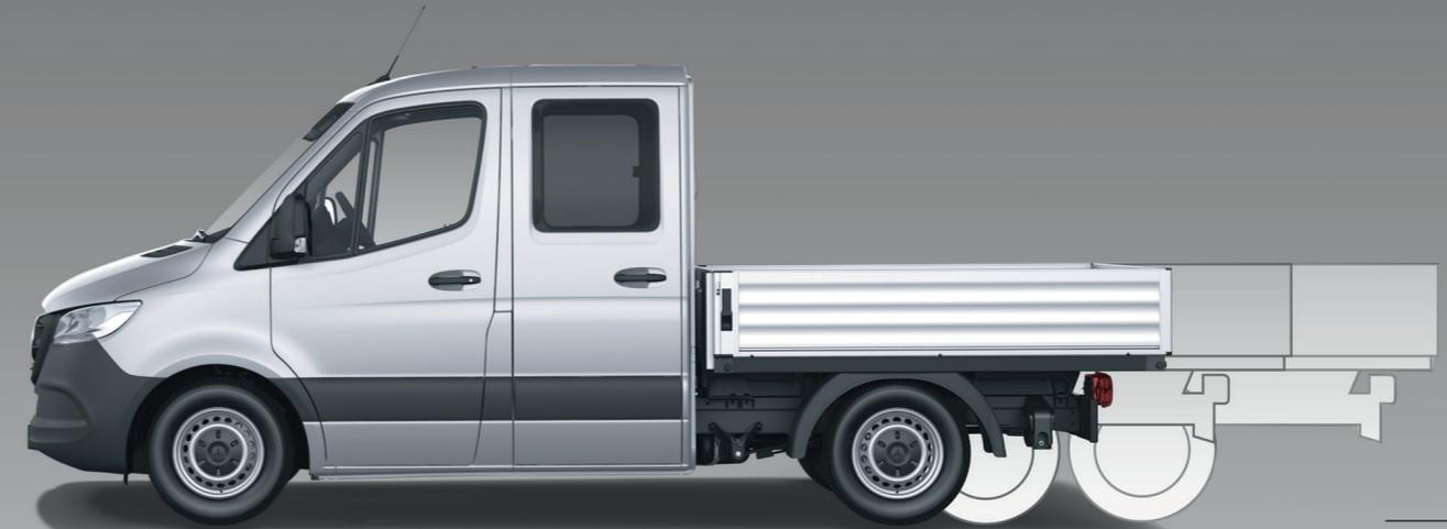
Габаритная длина автомобиля: 5496 мм
