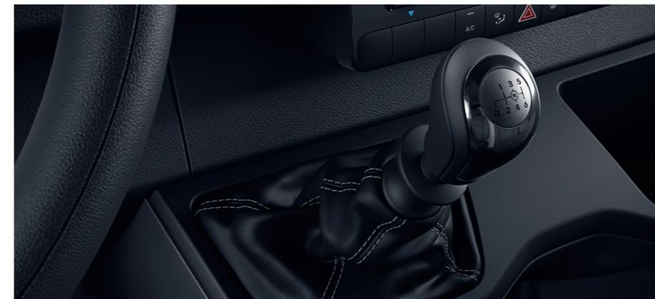
Большой выбор коробок передач оптимально ориентирован на сферы использования. Например, 6-ступенчатая механическая коробка передач и 9-ступенчатая автоматическая коробка передач для автомобилей с передним приводом. Автоматическая коробка передач, как и в моделях легковых автомобилей, позволяет переключать передачи вручную с помощью рычага селектора АКПП на рулевом колесе и подрулевых переключателей.
