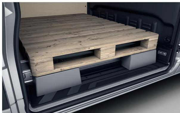
Упоры для поддонов в ступеньке сдвижной двери стабилизируют груз в районе двери и особенно целесообразны при транспортировке груза на европоддонах или в решетчатых ящиках.
