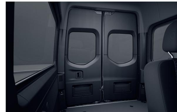
Сплошная обшивка внутренних сторон обеих задних дверей пластиковыми панелями улучшает внешний вид и ценность пассажирского салона или грузового отделения.
