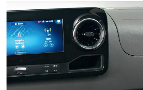
Мультимедийная система MBUX с сенсорным экраном высокого разрешения диагональю 26 см (10,25 дюйма) обеспечивает, в частности, быструю навигацию с жесткого диска с трехмерным отображением карт и интеграцией смартфона.
