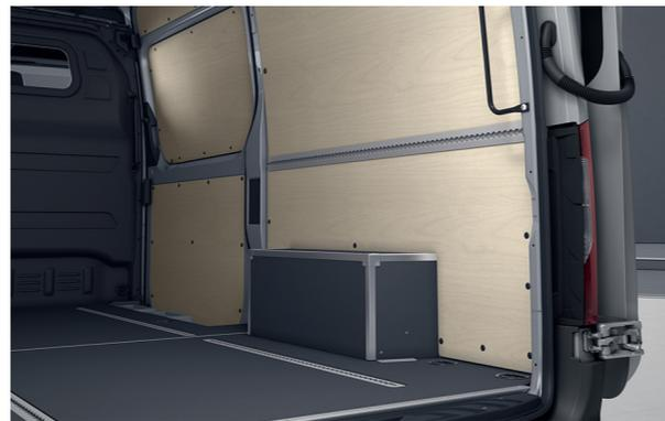
Колесные арки в грузовом отделении облицованы деревом. За счет этого образуются ровные горизонтальные поверхности для размещения груза. Это обеспечивает дополнительные возможности для размещения грузов, а также защищает металл от повреждений.
