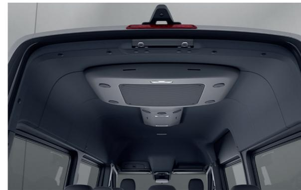
Кондиционер повышенной мощности на крыше обеспечивает комфортный климат в пассажирском или грузовом отделении и делает поездку более приятной. Его максимальная охлаждающая мощность составляет 7 кВт, и управлять им можно отдельно от кондиционера передней части автомобиля.
