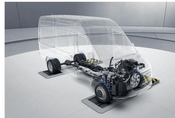
Подключаемый полный привод оптимизирует тяговое усилие в сложных погодных или дорожных условиях, тем самым улучшая безопасность и динамику движения.
