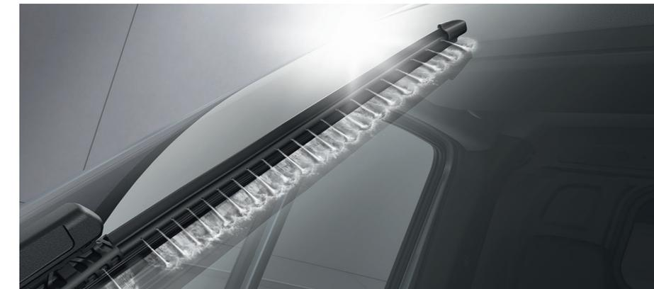
Система стеклоочистителей WET WIPER SYSTEM<sup>1</sup> обеспечивает водителю улучшенную видимость во время протирания стекол.
