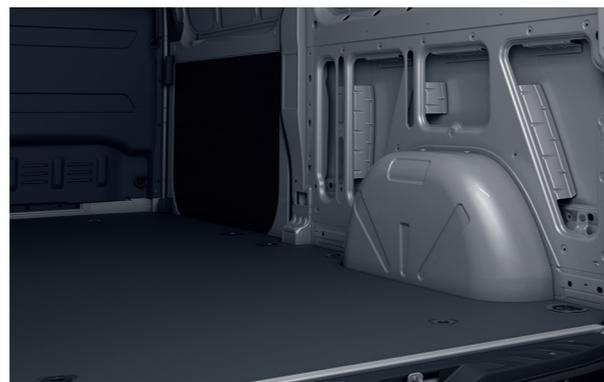
Оптимизированный по весу пластиковый пол имеет ровную поверхность, на нем удобнее размещать грузы и за ним легче ухаживать. По сравнению с деревянным полом преимущество в весе составляет около 18,5 кг<sup>1</sup>.
