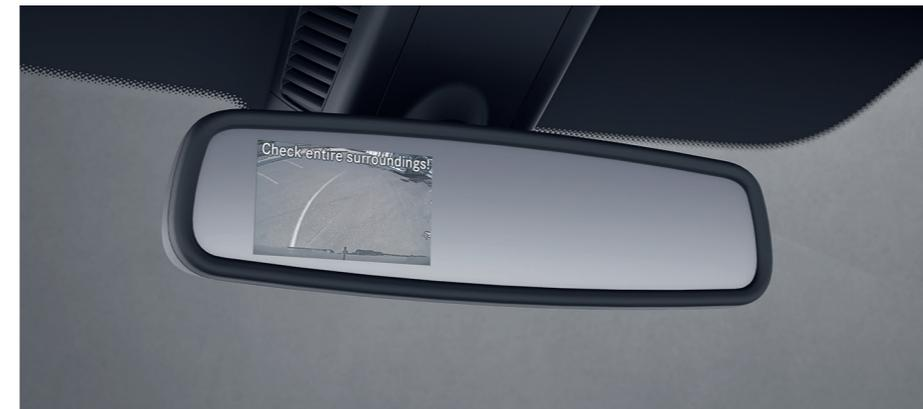
Камера заднего вида передает изображение области, расположенной непосредственно позади автомобиля и вне зоны прямой видимости, на дисплей на внутрисалонном зеркале заднего вида.
