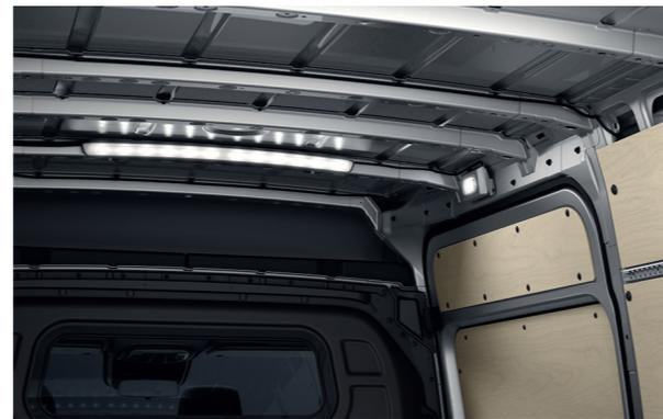
Две светодиодные ленты под крышей освещают грузовой отсек практически без теней и облегчают ориентацию при погрузке/разгрузке.
