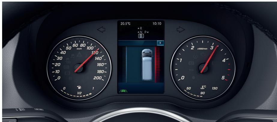
Невнимательность или усталость может привести к незаметному для водителя смещению с полосы движения. В таком случае активная система удержания полосы движения сразу предупредит водителя звуковым и визуальным сигналом.
