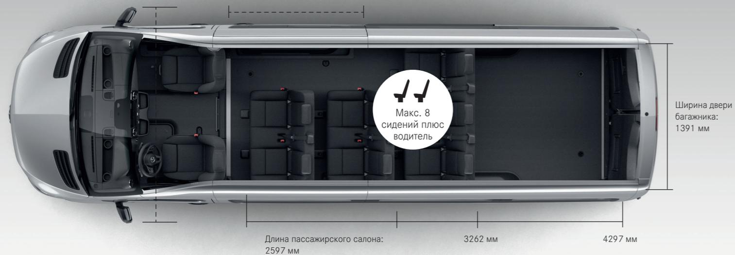
Макс. ширина автомобиля с учетом наружных зеркал заднего вида: 2345 мм
