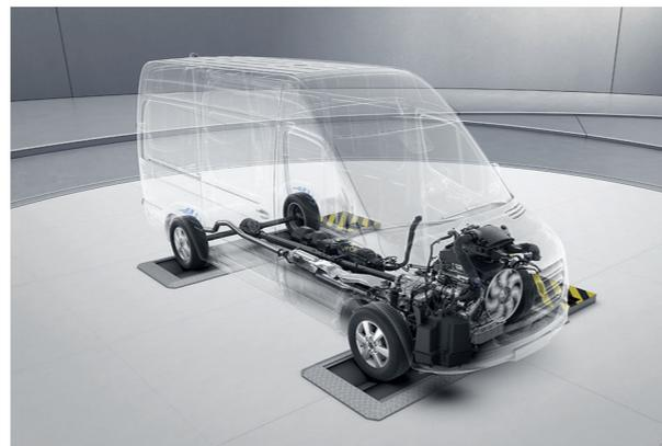
При заднем приводе разделение привода и рулевого управления улучшает комфорт при вождении, ходовые качества и радиус разворота.
