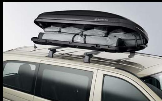
Багажный контейнер, сохраняющий оптимальную аэродинамику автомобиля, обладает вместимостью около 400 л. Возможность открывания контейнера с двух сторон обеспечивает удобную загрузку и разгрузку.
