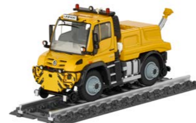
UNIMOG U430 ЛОКОМОБИЛЬ С КУЗОВОМ ДЛЯ МАНЕВРОВЫХ РАБОТ
