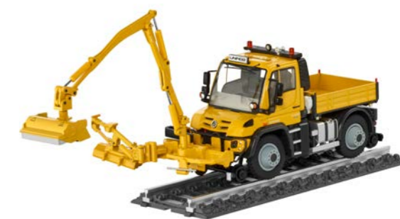
UNIMOG U430 ЛОКОМОБИЛЬ С КОМБИНИРОВАННОЙ КОСИЛКОЙ
