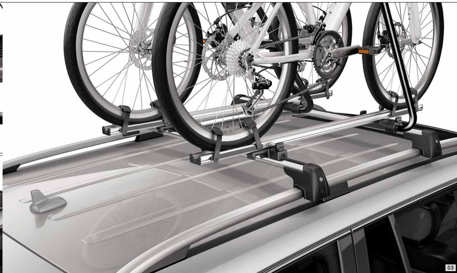
03 Крепление New Alustyle для перевозки велосипедов на крыше New Alustyle для перевозки велосипедов монтируется на базовые крепления. Фиксировать велосипеды можно до или после установки крепления на крышу. Если аксессуар не используется, то опорная рамка складывается вниз для снижения сопротивления при движении. На одну пару базовых креплений в зависимости от максимальной нагрузки на крышу автомобиля может быть установлено до четырех креплений для велосипедов, а на каждое из них – велосипед с максимальным диаметром рамы 98 мм (круглое сечение трубы рамы) или 110 x 70 мм (овальное сечение трубы рамы).
