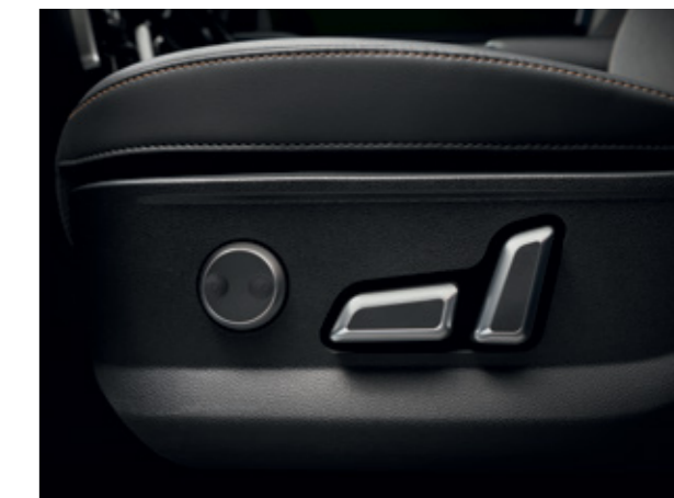
Электрорегулировка сиденья водителя в 8 направлениях
