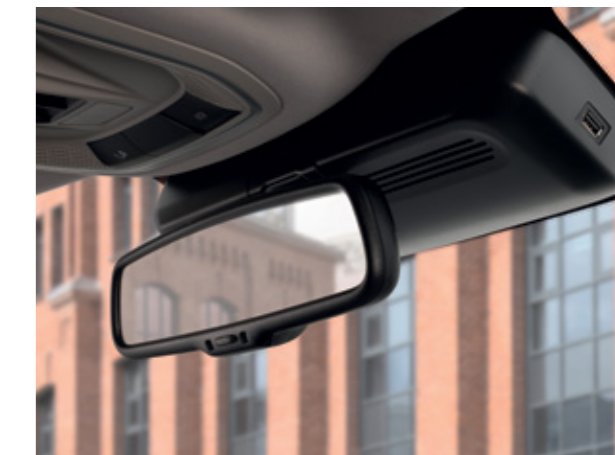
Зеркало заднего вида с автоматическим затемнением и разъемом USB для видеорегистратора
