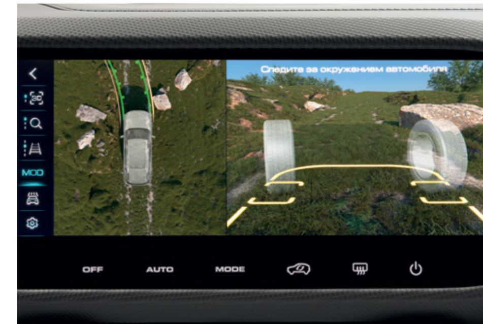
Функция также показывает угол поворота передних колес
