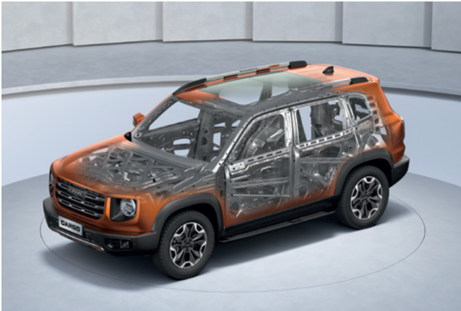
Запрограммированные зоны деформации
