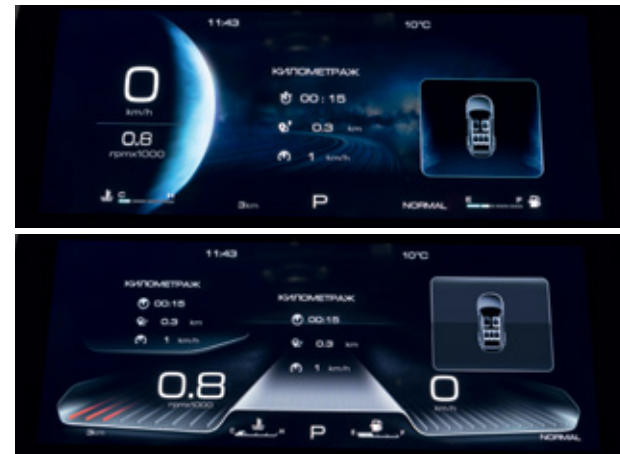
Цифровая панель приборов 10,25"
