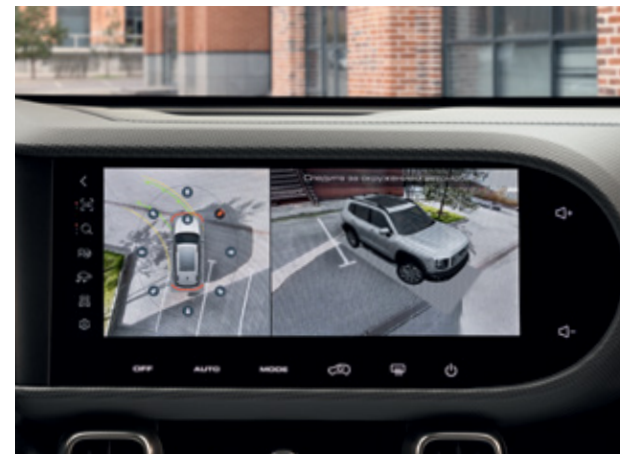
Система камер кругового обзора 360°
