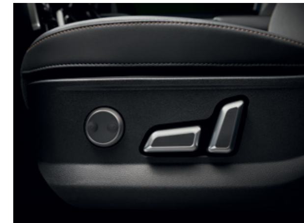
Электрорегулировка сиденья водителя в 8 направлениях
