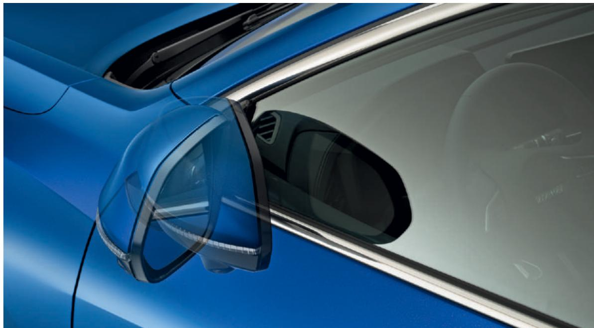
Электропривод складывания зеркал
