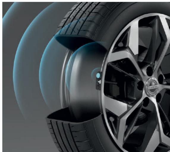
Система контроля давления в шинах
