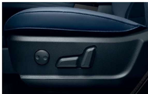
Электропривод сиденья водителя в восьми направлениях с электрорегулируемой поясничной поддержки
