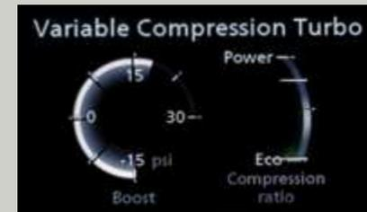
VC-Turbo непрерывно изменяет степень сжатия, чтобы найти баланс между мощностью и расходом топлива. Мощность и эффективность – теперь вам доступно все и сразу.
