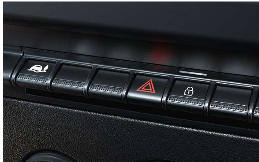
Функция extended grip активируется кнопкой на центральной панели.
