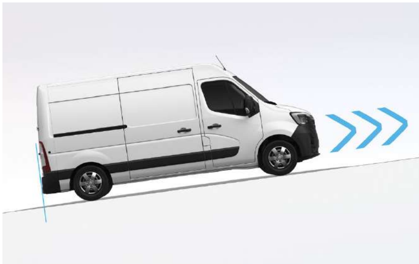
Hill Start Assist — система помощи при трогании на подъеме.
