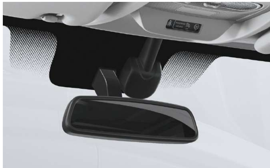
Камера заднего вида с передачей информации в салонное зеркало заднего вида.
