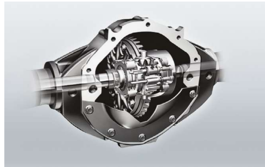
Автоматическая блокировка дифференциала (опция для заднеприводных версий).
