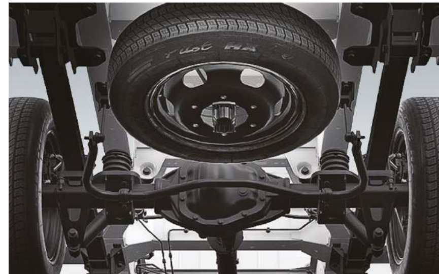
Полноразмерное запасное колесо компактно расположено под грузовым отделением.
