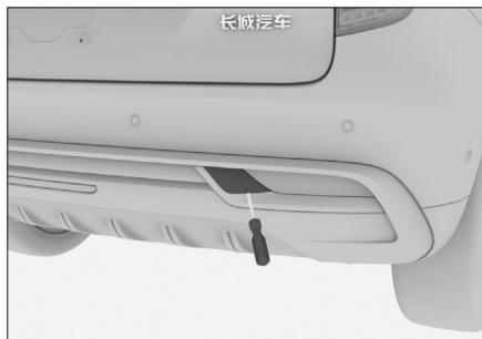
2. По часовой стрелке вверните буксировочный крюк в отверстие и закрепите при помощи гаечного ключа.
