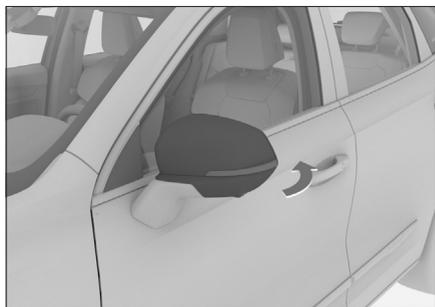
Чтобы сложить боковое зеркало, потяните его в направлении стрелки, держа за корпус. Перед началом движения следует вернуть зеркала в исходное положение.
