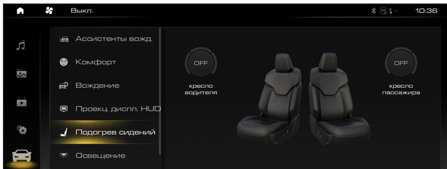
Для настройки или выключения режима обогрева сидений несколько раз коснитесь соответствующих кнопок.
