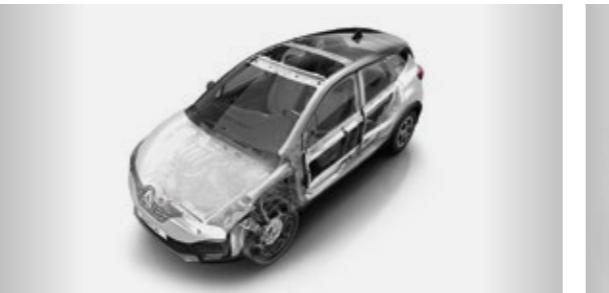
**Усиленный кузов и подушки безопасности.** Форма, толщина и жесткость элементов кузова оптимизированы для того, чтобы эффективно поглощать и рассеивать удар. В совокупности с подушками безопасности (2/4) это помогает защитить водителя и пассажиров в случае аварии.
