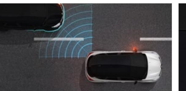
**Система контроля слепых зон.** LED-сигналы в боковых зеркалах предупреждают вас о нахождении другого автомобиля в слепой зоне, чтобы избежать столкновения при совершении маневра.
