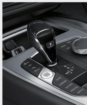
■ 8-ступенчатая спортивная автоматическая коробка передач Steptronic<sup>3</sup> обеспечивает очень быстрое переключение передач как автоматически, так и вручную с помощью подрулевых лепестков или рычага селектора коробки передач.
