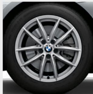
■ 17" легкосплавные диски V-spoke 768 Reflex Silver с разноразмерными шинами Runflat. Передние диски 7,5J x 17 с шинами 225/50 R17, задние диски 8,5J x 17 с шинами 255/45 R17.
