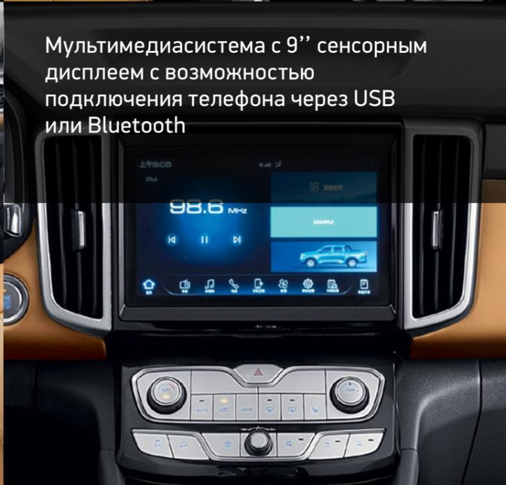
Мультимедиа-система с 9'' сенсорным дисплеем с возможностью подключения телефона через USB или Bluetooth
